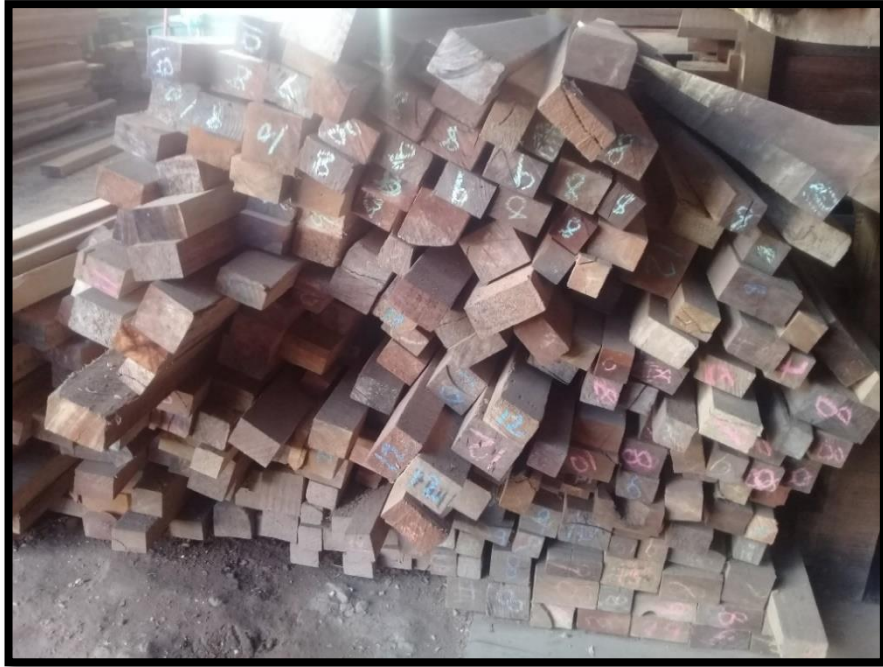
Fotografía N° 10. Se observa el control visual en las maderas para su posterior selección
