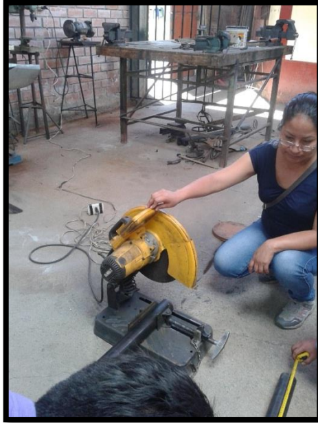
Figura 8.- Corte de los tubos para rodillos.
