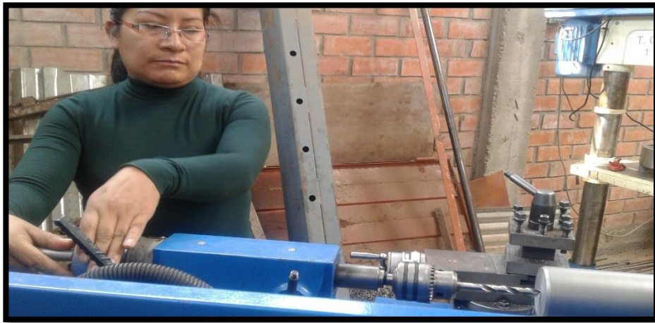
Figura 13.- Torneado de la barra de aluminio para fabricar engranajes pequeños
