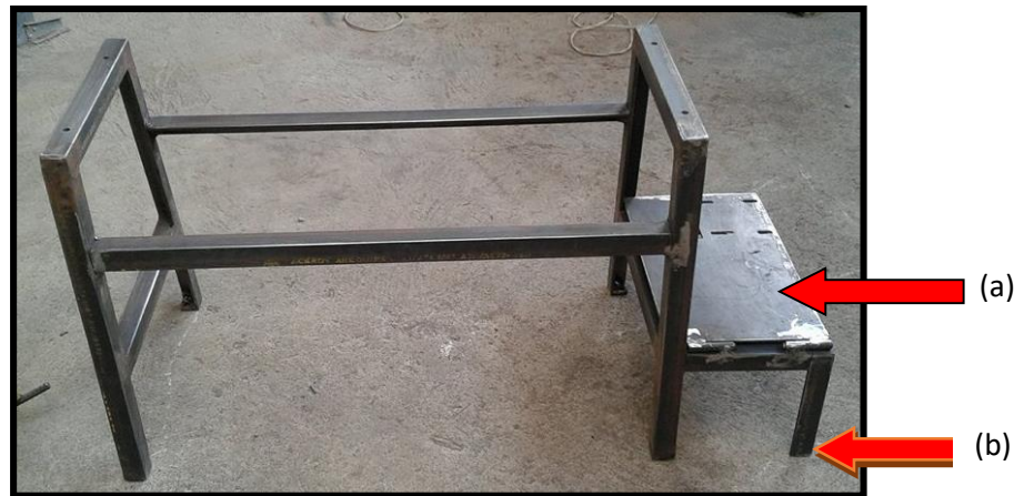
Figura 4.13.- Estructura inferior soldada
