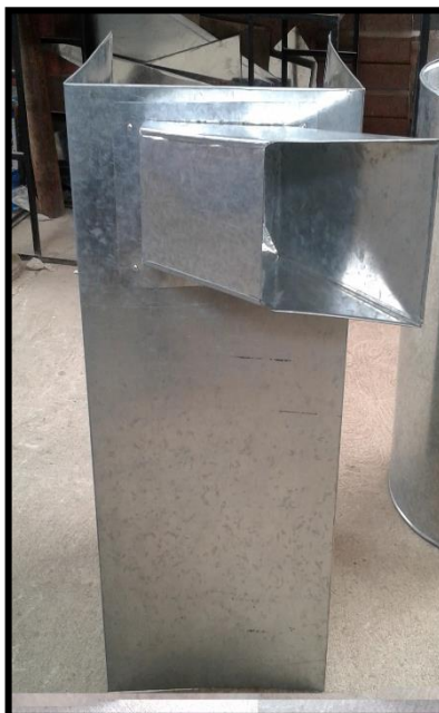
Figura N° 4.17.- Contenedor de la maquina con tolva para recepción de las papas
