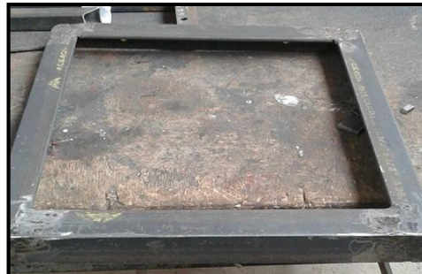
Figura 4.9.- Unión de las cuatro piezas para la estructura cuadrada.
