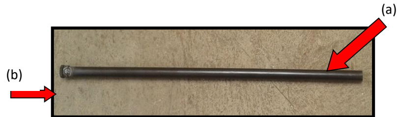
Figura 4.10.- Templador con tuerca soldada.
