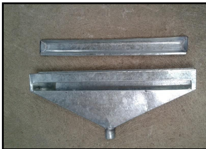
Figura N°4.18.- Elemento de desfogue para el agua y cáscara de papas.
