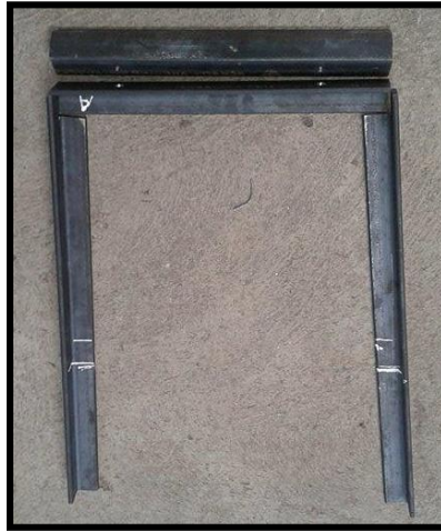
Figura 4.12.- Corte de las piezas para la estructura inferior
