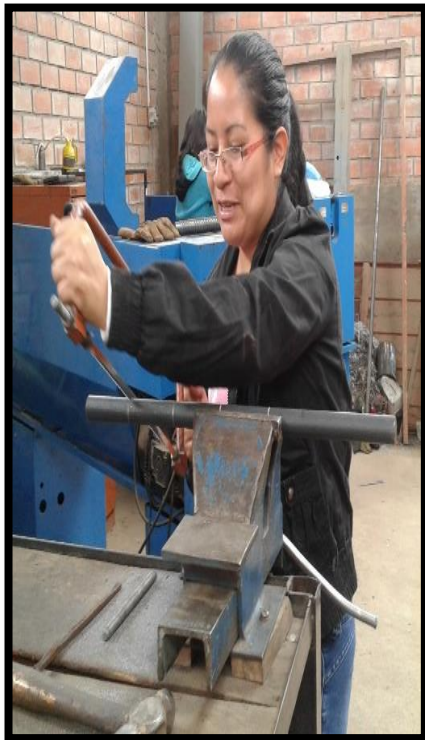
Figura 11.- Corte del eje para fabricar tapas.
