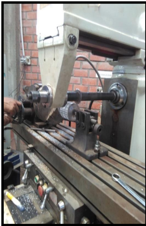
Figura 14.- Fresado de los engranajes pequeños
