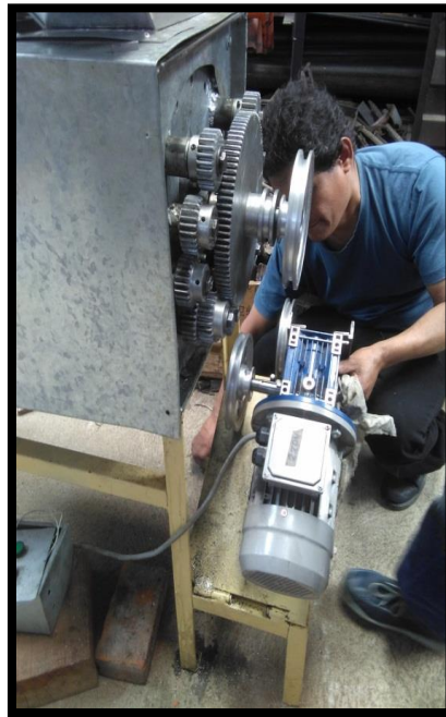
Figura 24.- Colocando el motor, las poleas y las fajas.
