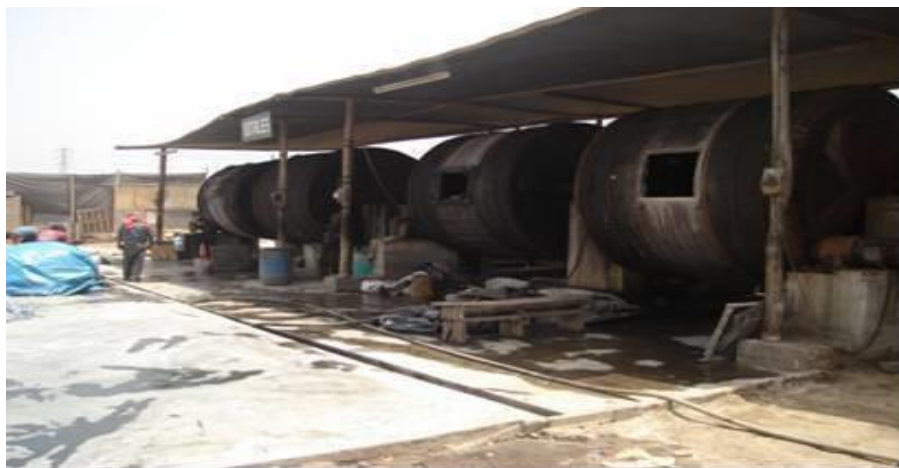
Figura N° 10: Máquina de Ecurrido. Generación de un residuo líquido altamente contaminado que sin un previo tratamiento es destinado a la red de desagüe. Fuente: Empresa de curtiembre Tauro
