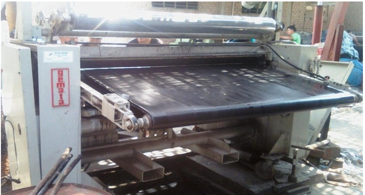
Figura N° 24: Etapa de acabado – Pintado a roller. Método más eficiente en cuanto a cantidad de insumos y el tiempo empleado Fuente: Empresa de curtiembre Tauro
