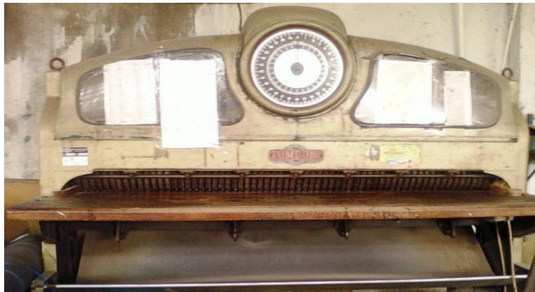
Figura N° 26: Medidora, para calcular el pesaje de cada plancha de cuero Fuente: Empresa de curtiembre Tauro
