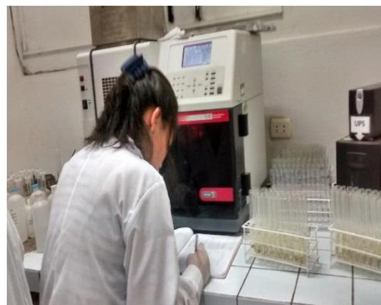
Lectura de minerales por el método de espectrofotómetro de absorción atómica
