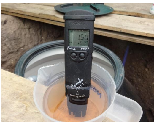
Fig. N° 74. Medición de C.E. 1,50 de solución nutritiva.
