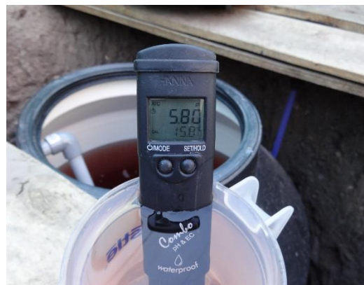
Fig. N° 73. Medición de pH 5,80 de solución nutritiva.
