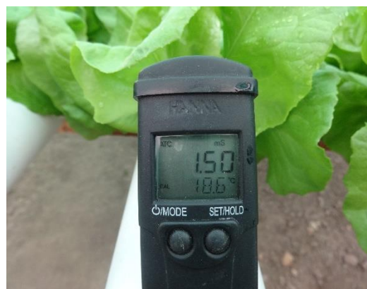
Fig. N° 95. Medición de C.E. 1,50 en tubo de PVC.
