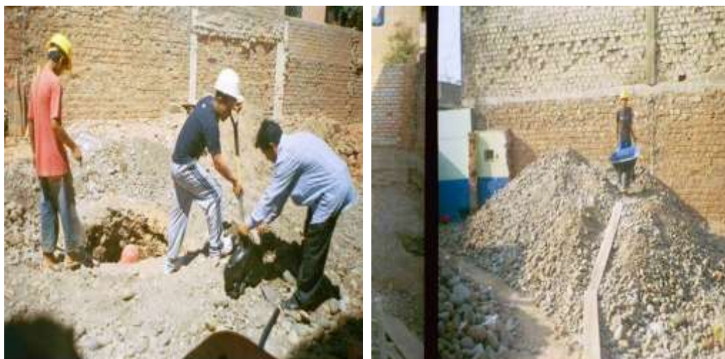
MUESTRA DE MATERIAL PARA ESTUDIO DE SUELOS ABRIL - 2008 Jr. Enrique León García N° 276 – Santa Catalina - La Victoria – Lima
