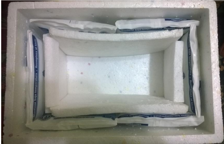
FOTO N° 11: Caja de tecnopor acondicionada con gel refrigerante para el traslado de muestras.
