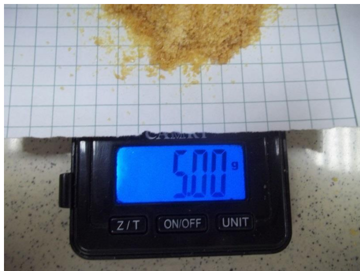
FOTO N° 16: Pesaje de cinco gramos de pluripeptona para la preparación del caldo enriquecido.
