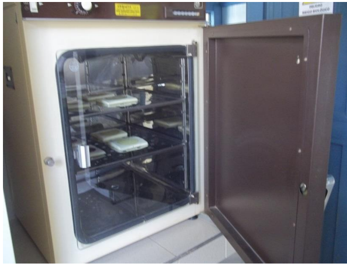
FOTO N° 25: placas de petrifilm llevados a la incubadora a una temperatura de 37°C donde permanecerán 24 horas hasta el momento de hacer el conteo de colonias.
