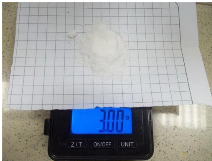
FOTO N° 14: Pesaje de tres gramos de cloruro de sodio para la preparación del caldo enriquecido.
