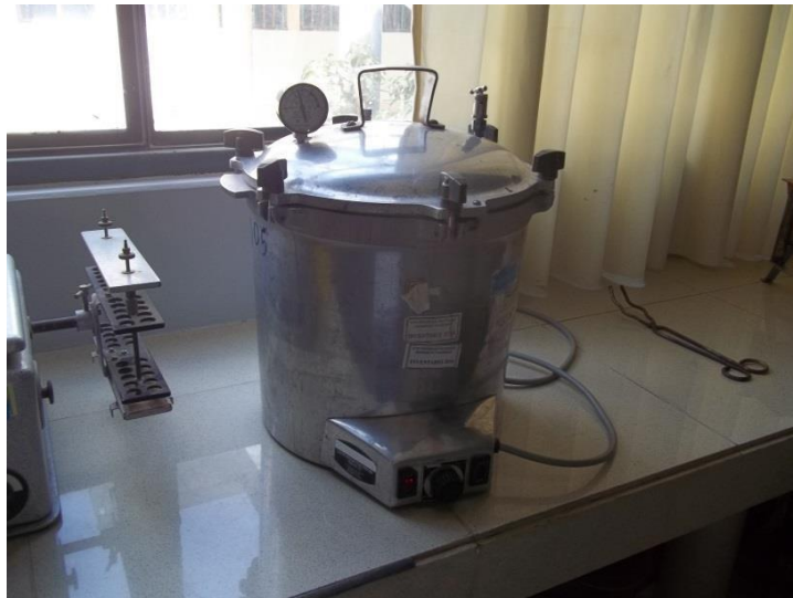
FOTO N° 18: Olla autoclave con los matraces que contienen el caldo enriquecido en su interior.
