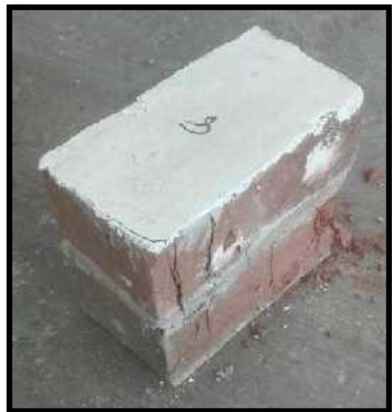
Figura 27. Falla por fisuras verticales – Artesanal.
