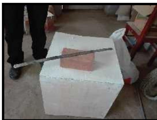
Figura 9. Medición del alabeo en el ladrillo artesanal como unidad
