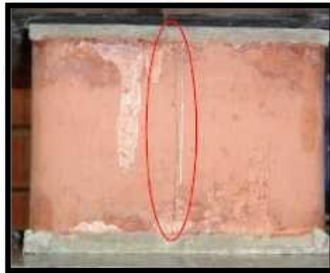
Figura 14. Ensayo a compresión de unidad de ladrillo Semi Industrial
