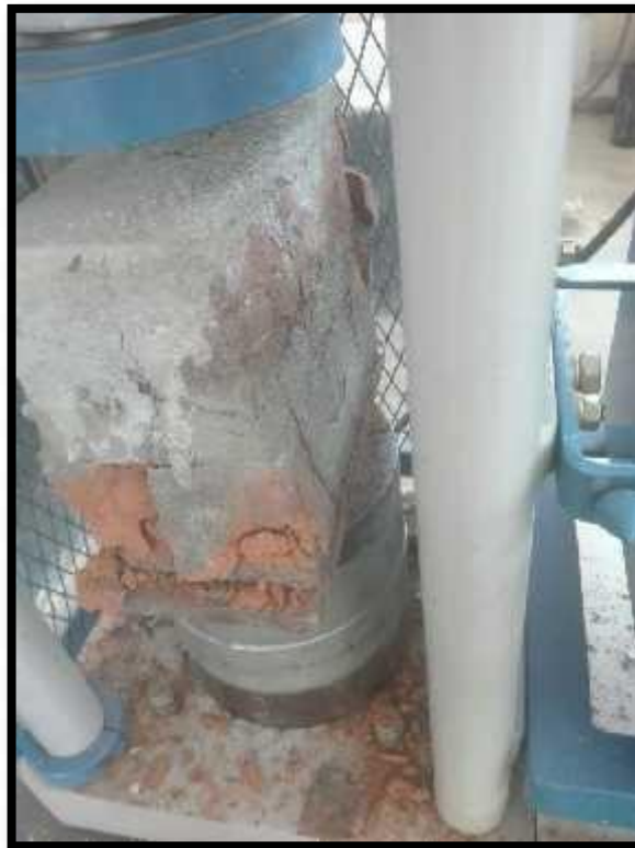
Figura 75. Ensayo a compresión axial para 2 hiladas en prismas de Albañilería.
