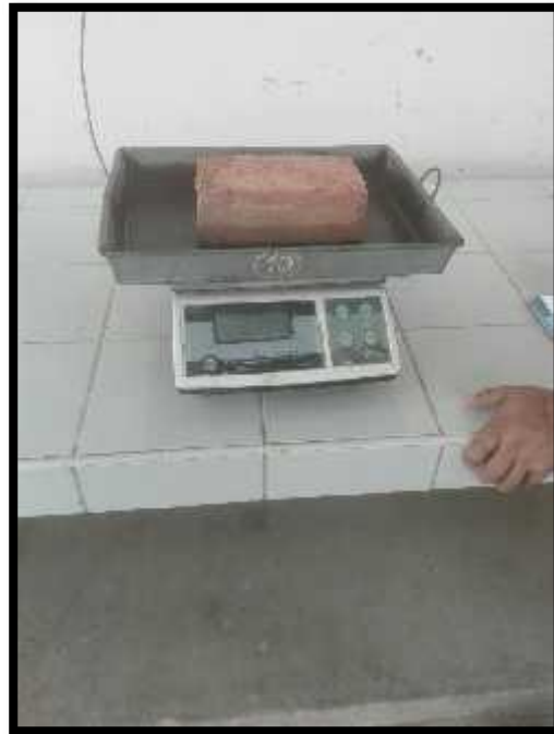
Figura 60. Peso sumergido, para ensayo a succión.
