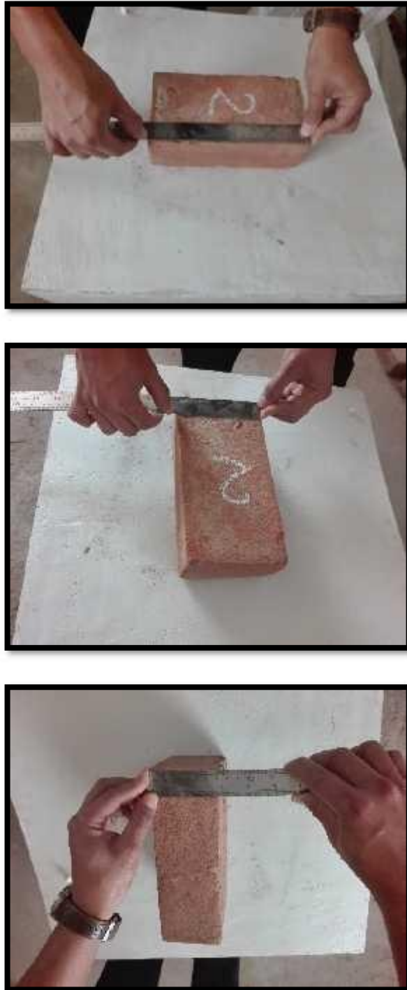
Figura 53. Medida de los lados del ladrillo artesanal.
