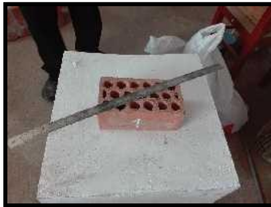
Figura 8. Medición del alabeo en el ladrillo semi industrial como unidad
