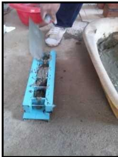
Figura 67. Molde para hacer los cubos de motero.
