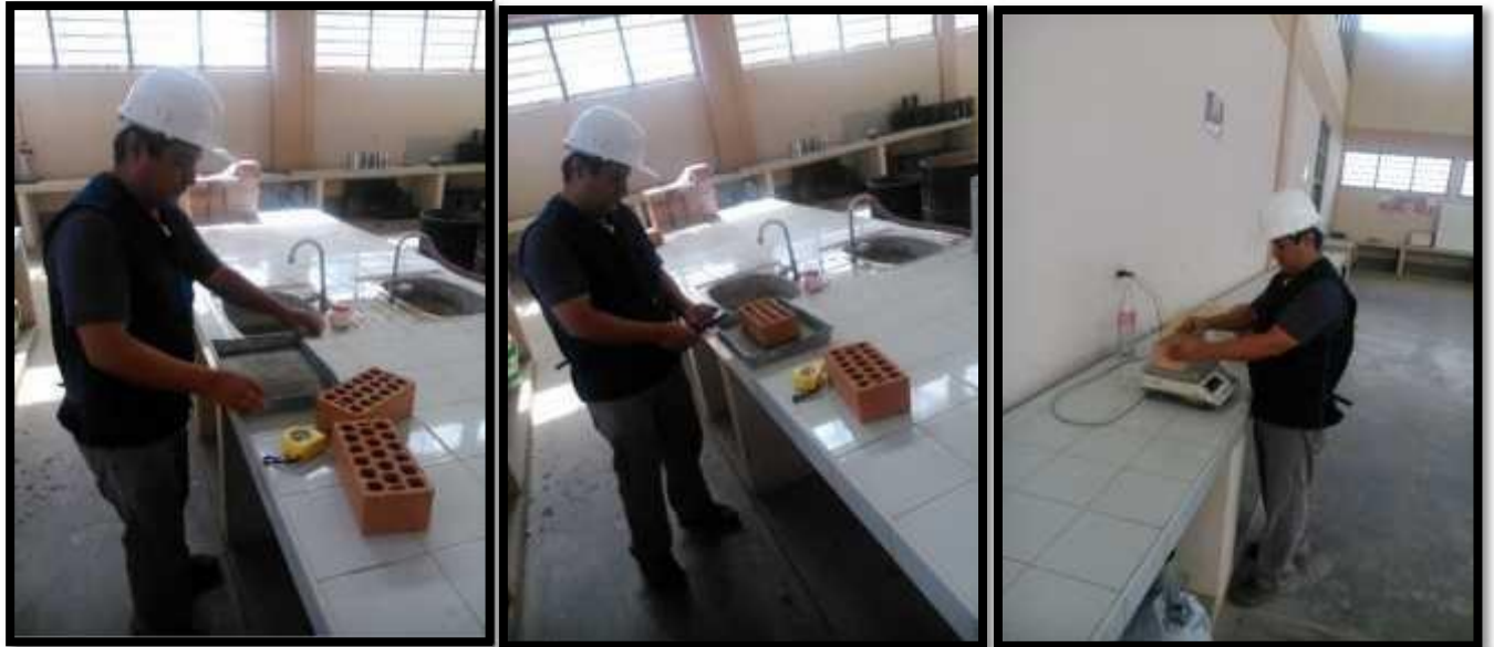
Figura 10. Ladrillo Semi Industrial sumergido por un minuto con un nivel constante.
