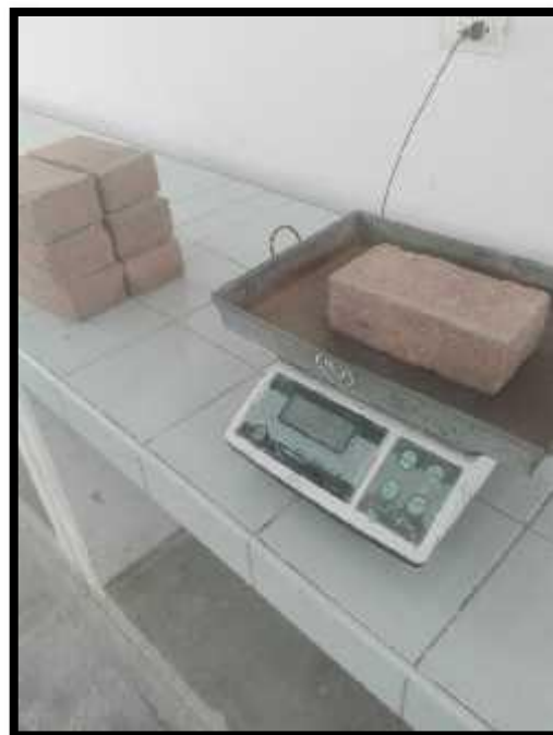
Figura 59. Peso seco de la unidad de ladrillo.
