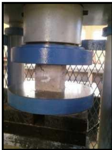
Figura 69. Cubo de mortero para ensayo a la resistencia a compresión
