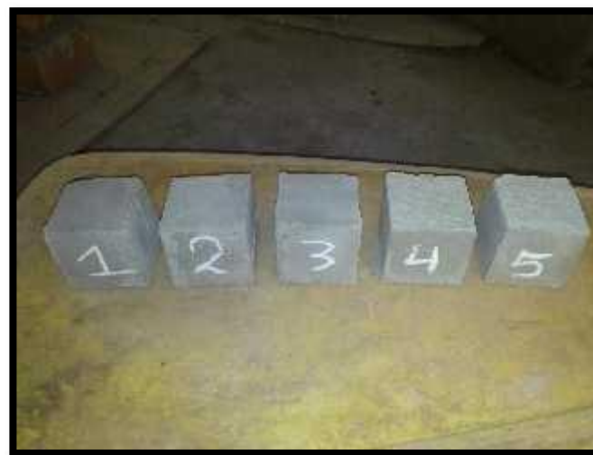
Figura 68. Cubos de concreto remojado por 28 días.
