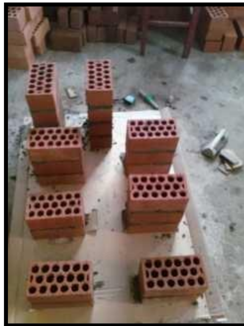
Figura 70. Construcción de los prismas de albañilerías.
