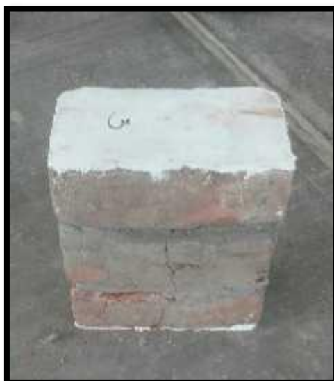
Figura 30. Grieta vertical vista lateral – Artesanal.
