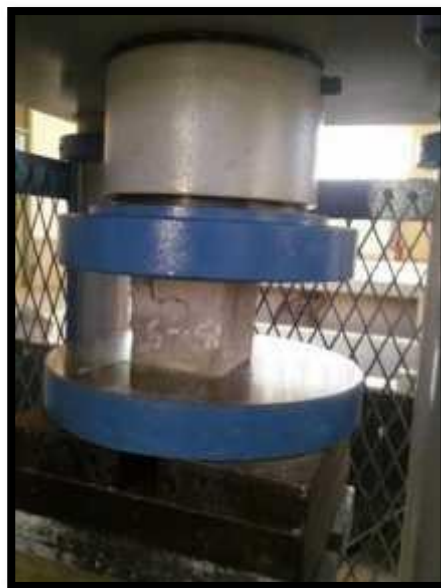
Figura 18. Cubo de mortero sometido a compresión axial
