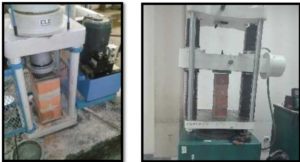
Figura 21. Pila instalada para ensayo a compresión axial
