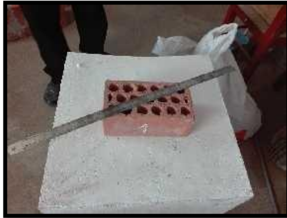
Figura 54. Midiendo el alabeo en ladrillos semi industrial.
