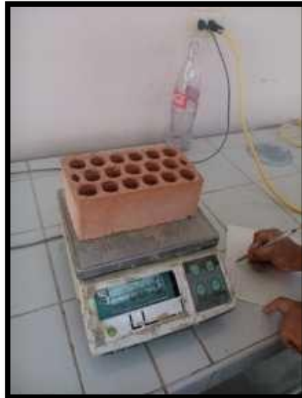
Figura 56. Peso seco de la unidad de ladrillo.
