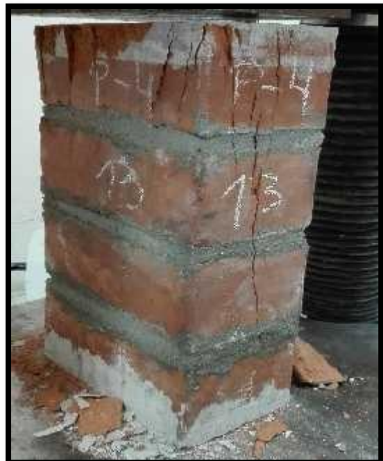
Figura 49. Falla por trituración y fisura vertical vista lateral - Artesanal.
