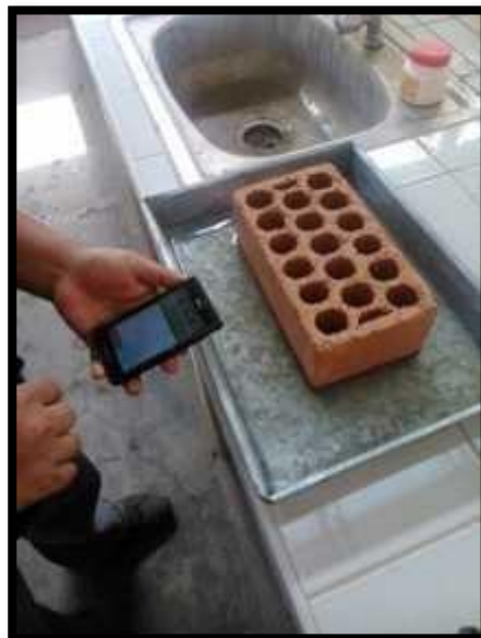
Figura 57. Unidad de ladrillo sumergido por un minuto.
