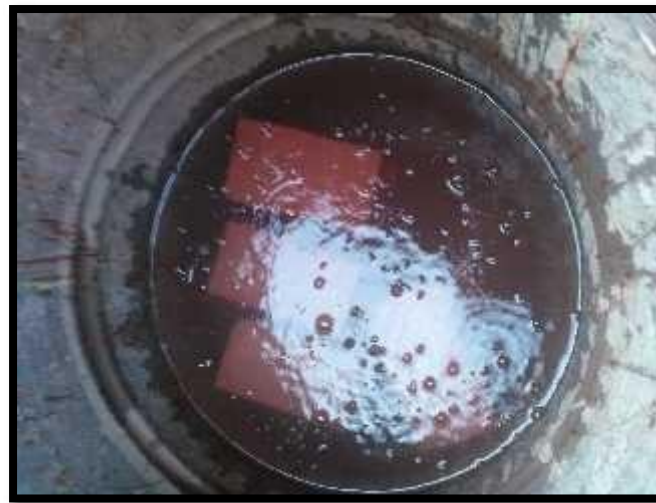
Figura 62. Unidad de ladrillo sumergido por 24 horas.
