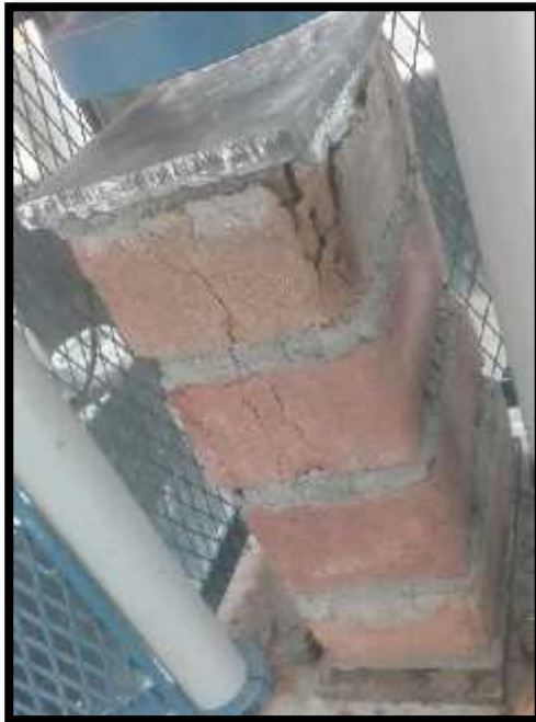
Figura 40. Falla por trituración vista lateral – artesanal.
