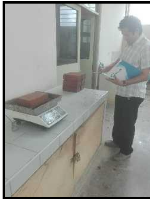
Figura 65. Peso sumergido, para ensayo de absorción.
