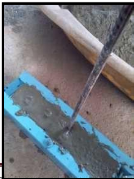
Figura 17. Mortero en molde para ensayo
