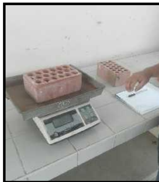
Figura 61. Peso seco de la unidad de ladrillo.
