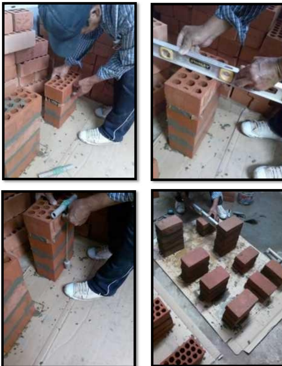
Figura 19. Asentado verticalmente con nivel de carpintero.
