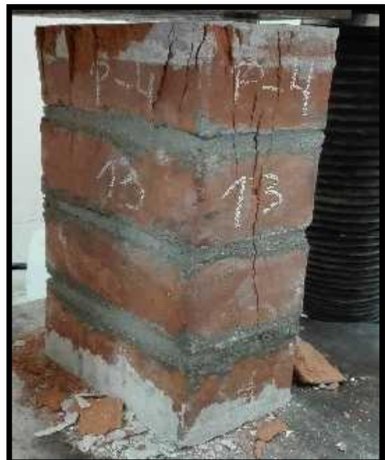
Figura 43. Falla por trituración vista lateral – Semi industrial.
