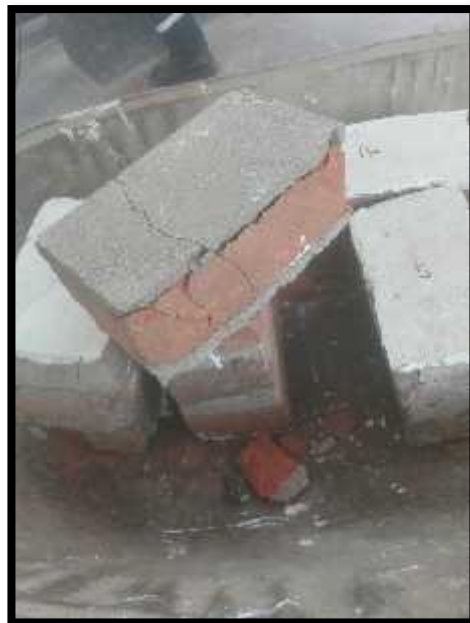
Figura 15. Ensayo a compresión de unidad de ladrillo Artesanal
