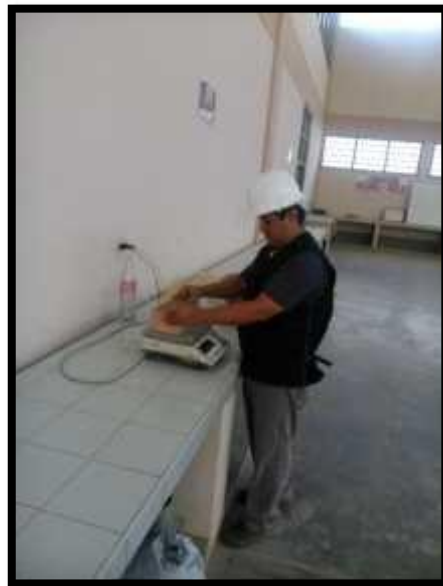
Figura 58. Peso sumergido, para ensayo a succión.
