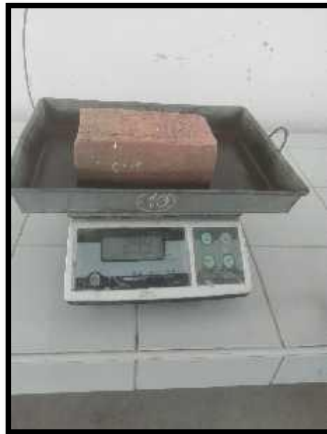
Figura 11. Ladrillo Artesanal sumergido por un minuto con un nivel constante.
