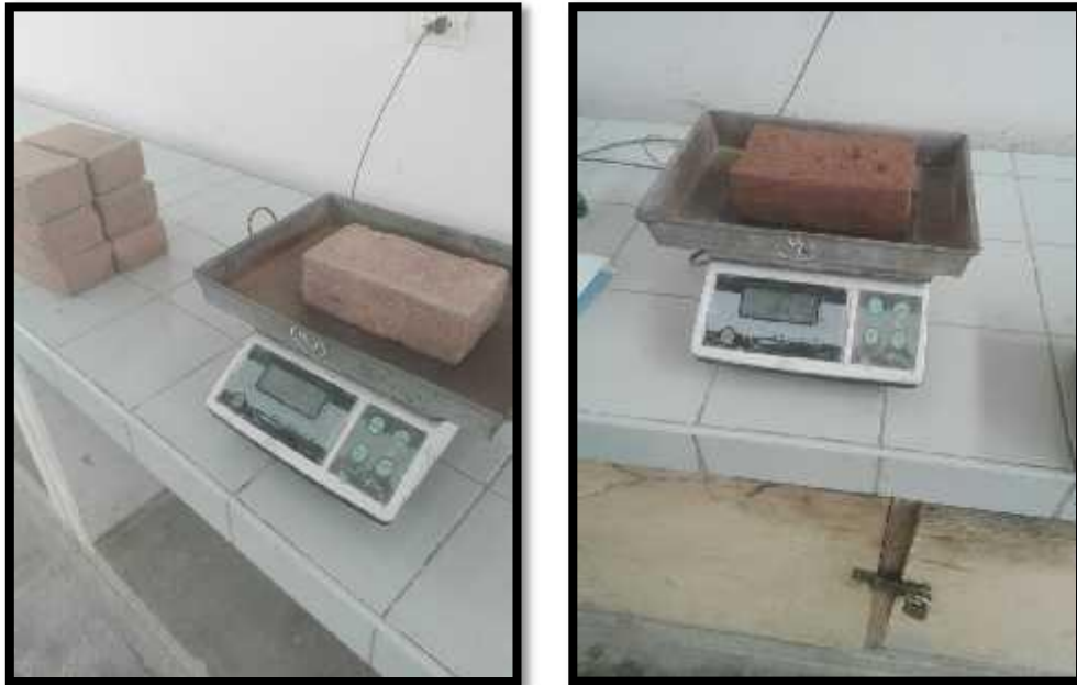
Figura 13. Ladrillo artesanal sumergidos por 24 horas.
