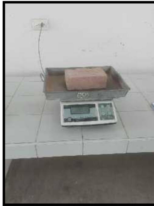
Figura 64. Peso seco de la unidad de ladrillo.
