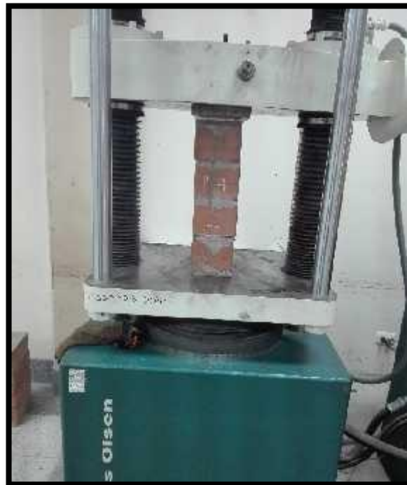
Figura 74. Ensayo a compresión axial para 3 y 4 hiladas en prismas de Albañilería.
