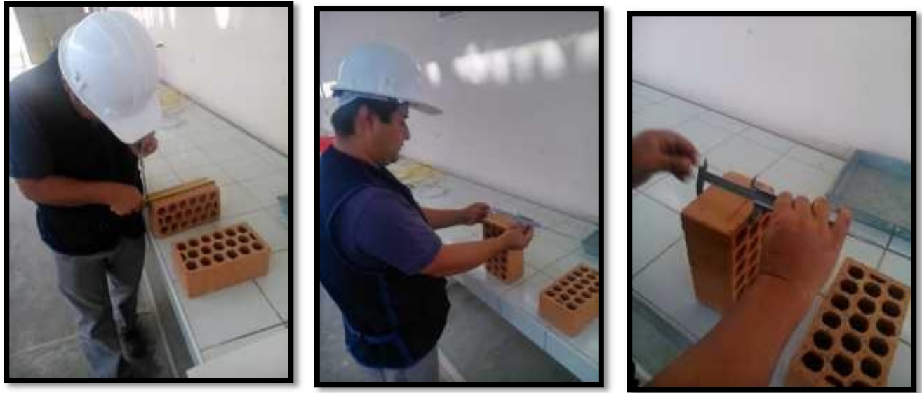
Figura 6. Medición del ladrillo semi industrial como unidad
