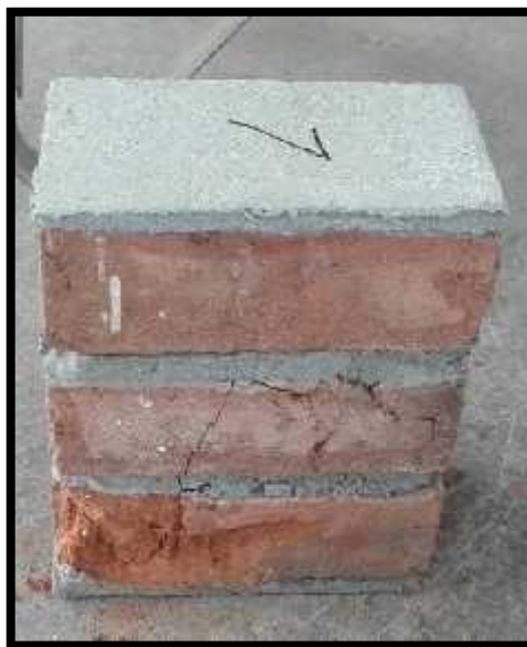
Figura 39. Falla por trituración frontal – Artesanal.
