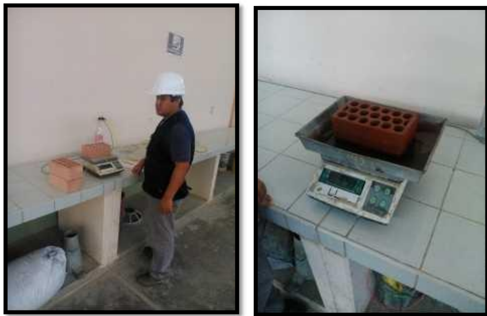
Figura 12. Ladrillos Semi Industrial sumergidos por 24 horas.
