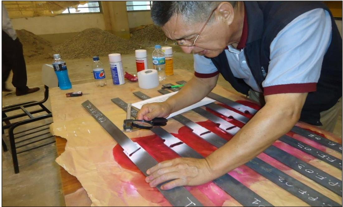
Figura 48: Ensayo visual y por Líquidos Penetrantes
