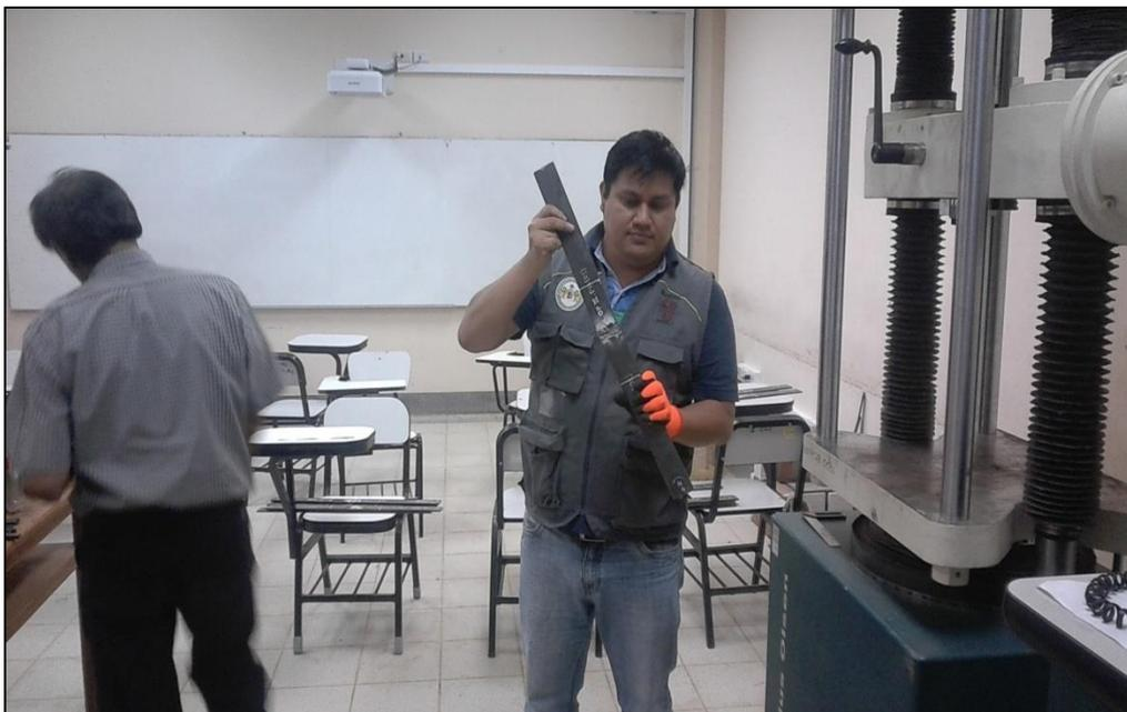
Figura 113: Ensayo Destructivo (Maquina Universal)
