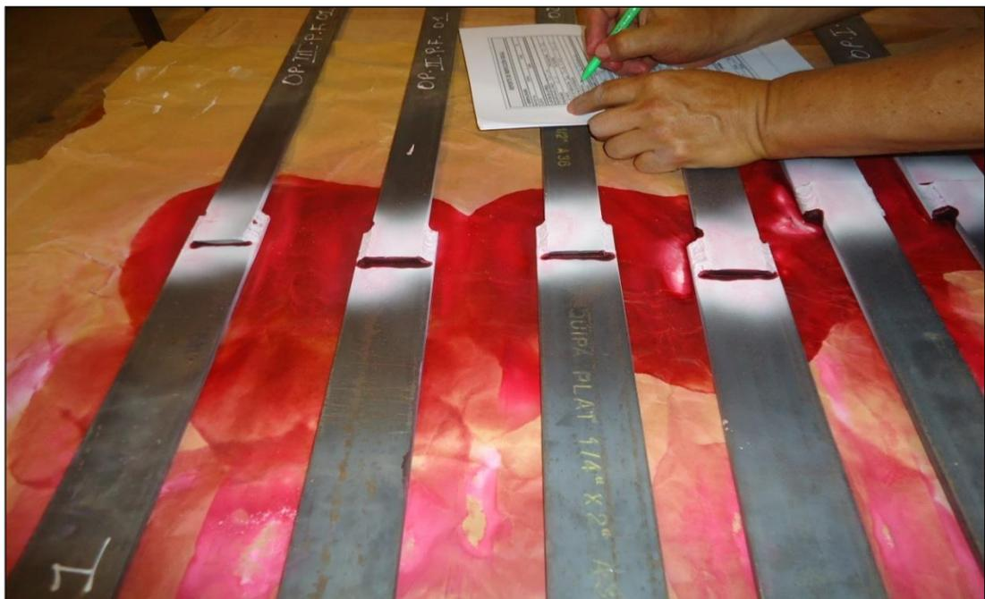
Figura 47: Ensayo visual y por Líquidos Penetrantes
