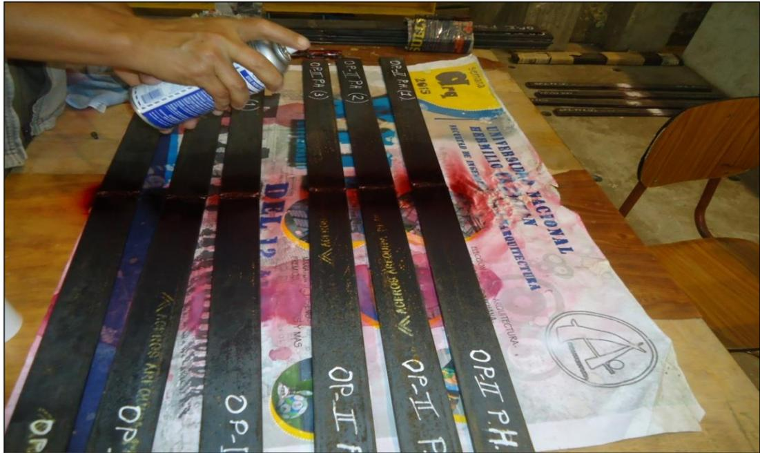
Figura 46: Ensayo visual y por Líquidos Penetrantes
