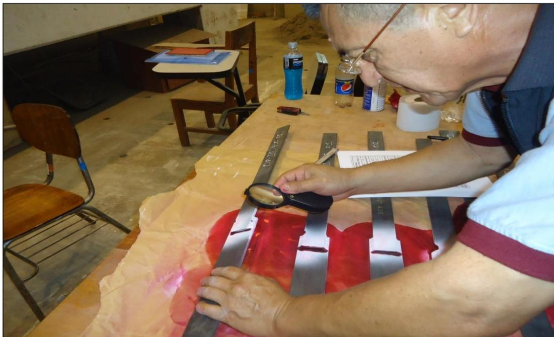
Figura 49: Ensayo visual y por Líquidos Penetrantes
