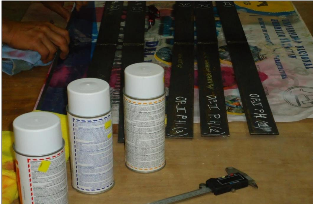
Figura 44: Ensayo visual y por Líquidos Penetrantes
