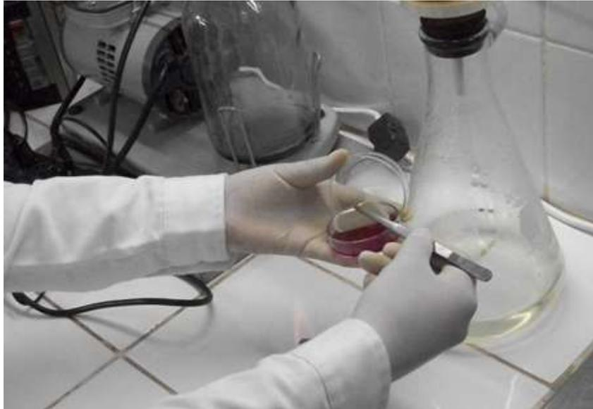
**Fotografía 11.** Colocando el filtro de membrana en la placa petri que contiene agar FC el cuál es específico para *Escherichia coli*.
