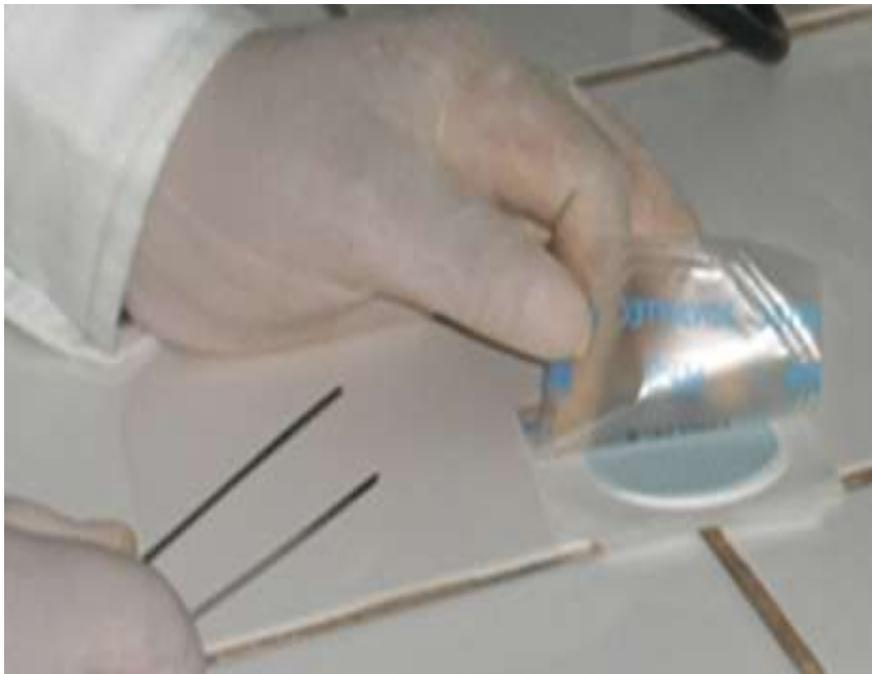
**Fotografía 12.** Filtro de membrana utilizado para la determinación de *Escherichia coli*.
