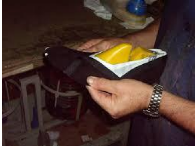
Ilustración 6 Operación de descalzado
