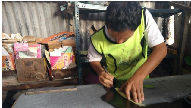
Ilustración 2 Operación manual de corte utilizando una mata de cuero
