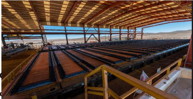
**secha:** Consiste en retirar los cátodos que tienen 6 días de depósito y sustituirlos por cátodos iniciales. Luego, se repite el ciclo.
