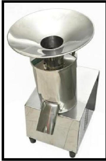
Figura 5. Despulpadora vertical fuente motriz inferior
