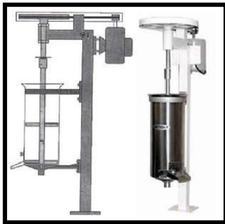
Figura 6. Máquina despulpadora vertical fuente motriz superior
