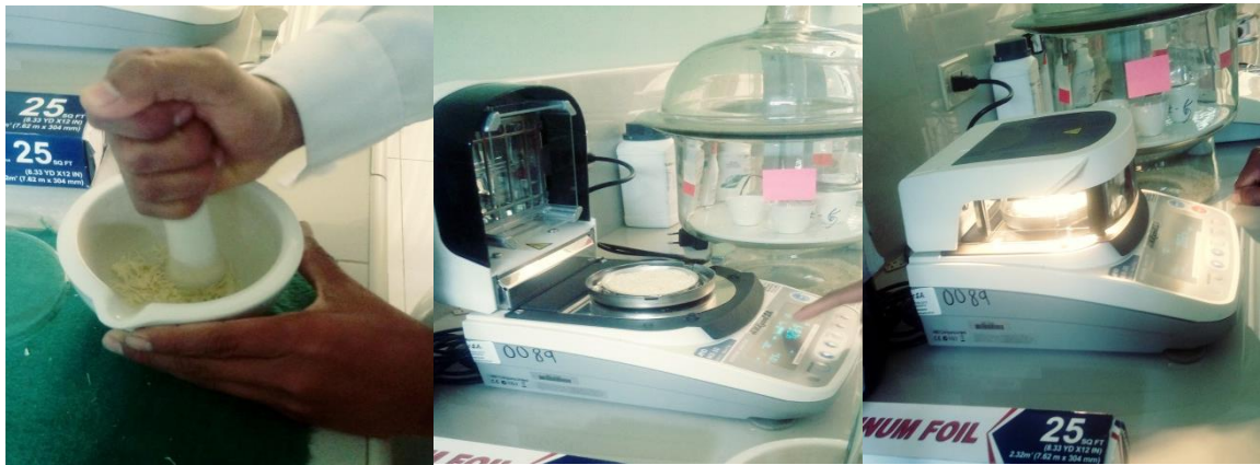
Figura 25. Determinación de humedad de las harinas para la formulación del suplemento en polvo.
