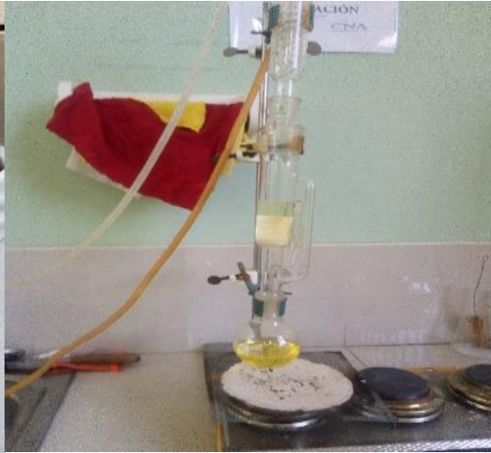
Extracción de grasa por soxhlet.
