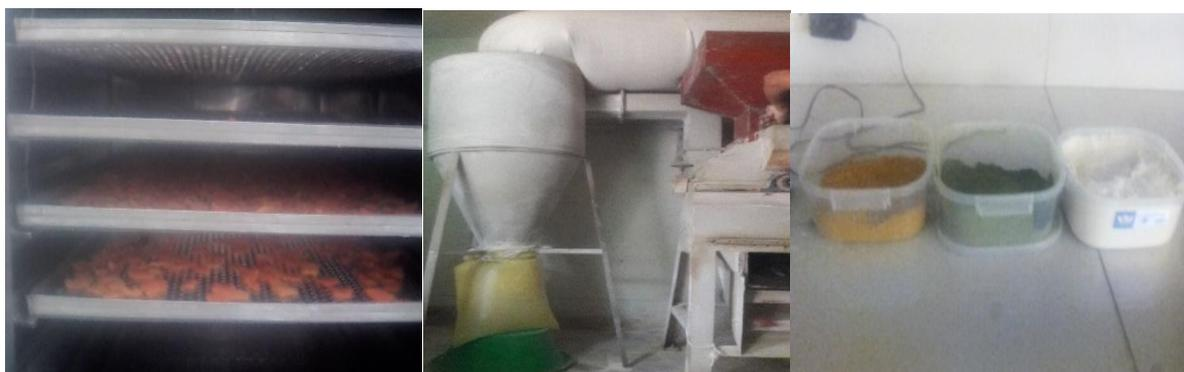
Figura 06. Secado, molido y formulación de la materia prima.
