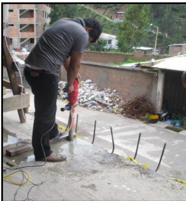
Fotografía 19. Espécimen de extracción de núcleo de 2"x4".
