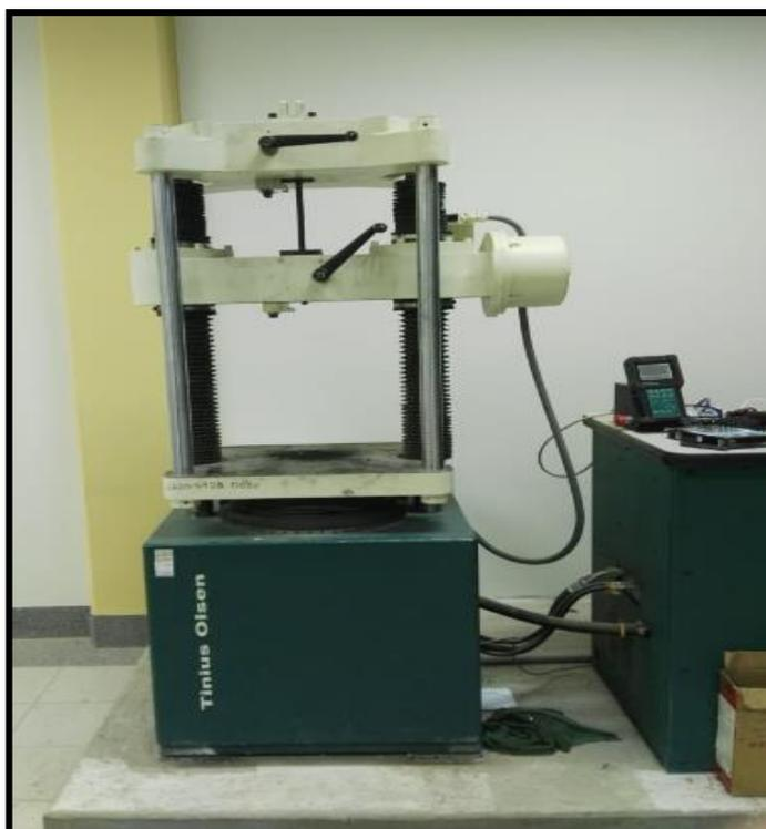
Se realiza el ensayo en la maquina universal para cada diámetro de varilla midiendo sus medidas iniciales y finales de cada prueba.
