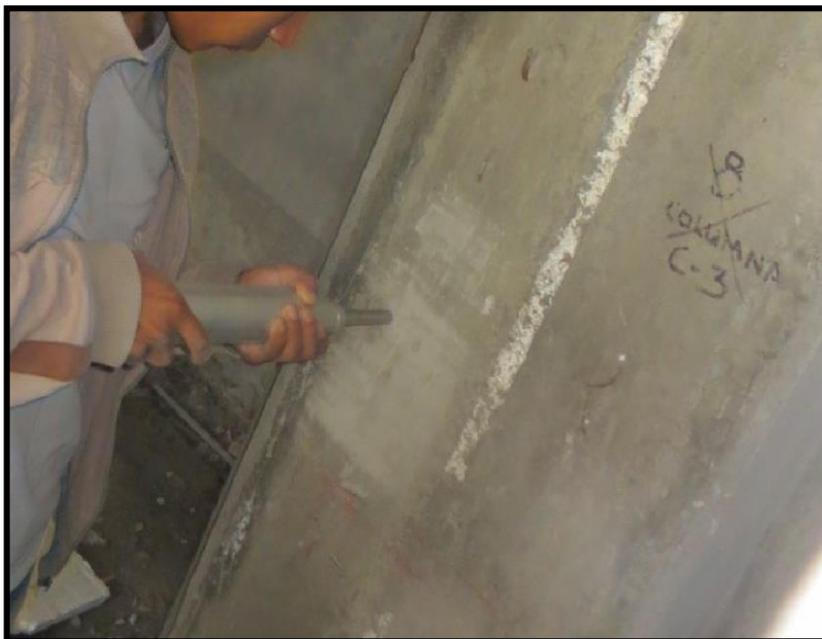
Fotografía 16. Prueba de esclerómetro viga 25x60.
