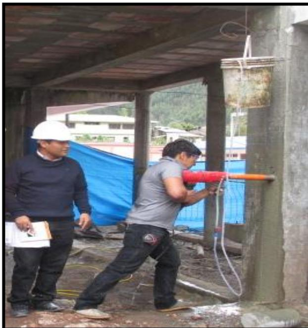
*Fotografía 18. Extracción de núcleo de concreto de losa aligerada.*
