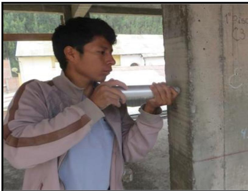
Fotografía 15. Prueba de esclerómetro columna T.
