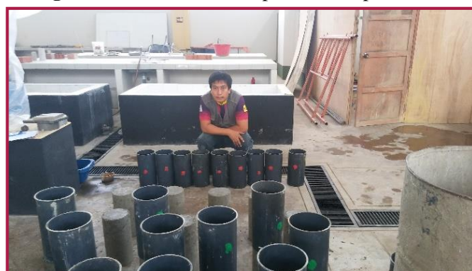
Fotografía N° 11. Moldes de probetas de plástico de 6".
