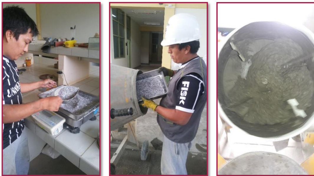
Fotografía N° 24. Elaboración de probetas con material PET.
