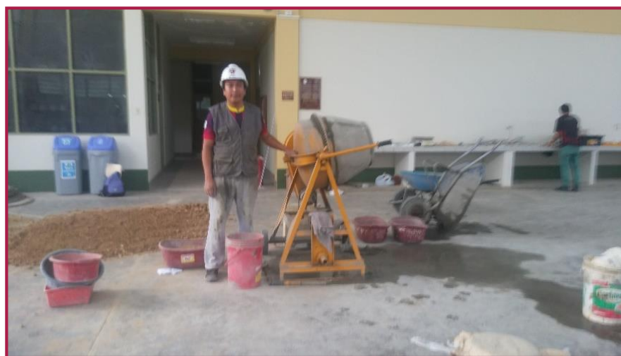
Fotografía N° 16. Elaboración de las probetas con mezcladora.
