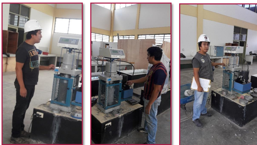
Fotografía N° 29. Ensayo de resistencia a la compresión a los 7, 14 y 28 días.
