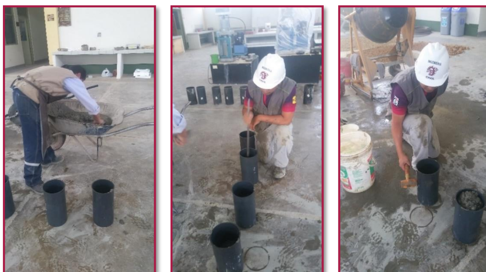
Fotografía N° 18. Elaboración de las probetas.
