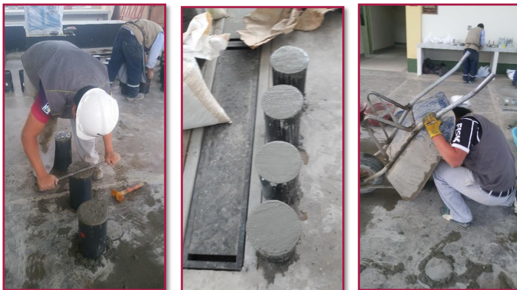
Fotografía N° 19. Acabado final de las probetas.
