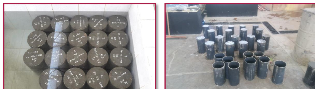
Fotografía N° 23. Elaboración de las probetas.
