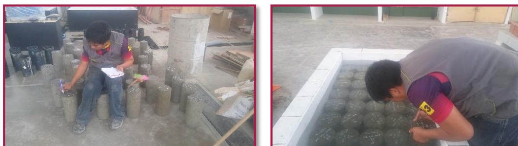
Fotografía N° 22. Identificación y curado de las mezclas.
