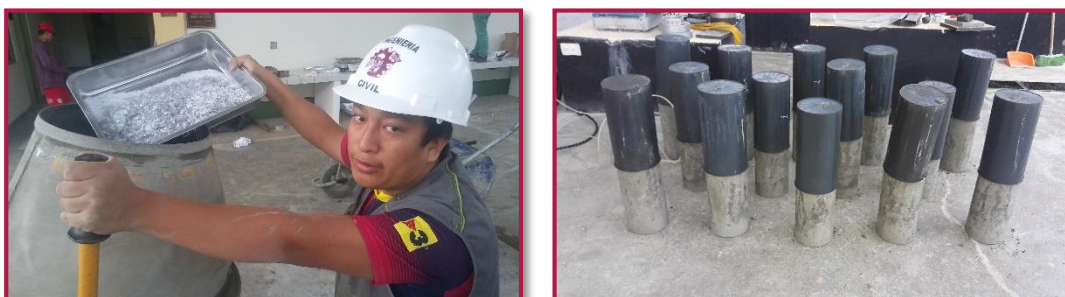
Fotografía N° 25. Agregado PET en el diseño de mezclas.
