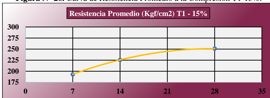
Figura N° 26. Curva de Resistencia Promedio a la Compresión T1-15%.
