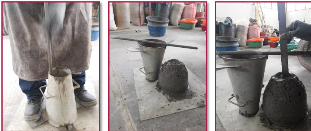
Fotografía N° 12. Ensayo de asentamiento con el cono de Abrams.
