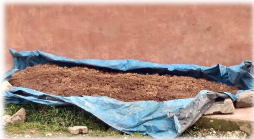
Fotografía N° 07. En la imagen podemos apreciar el secado de la Tierra extraída de la cantera Cruz Pata-Jesús –Lauricocha.
