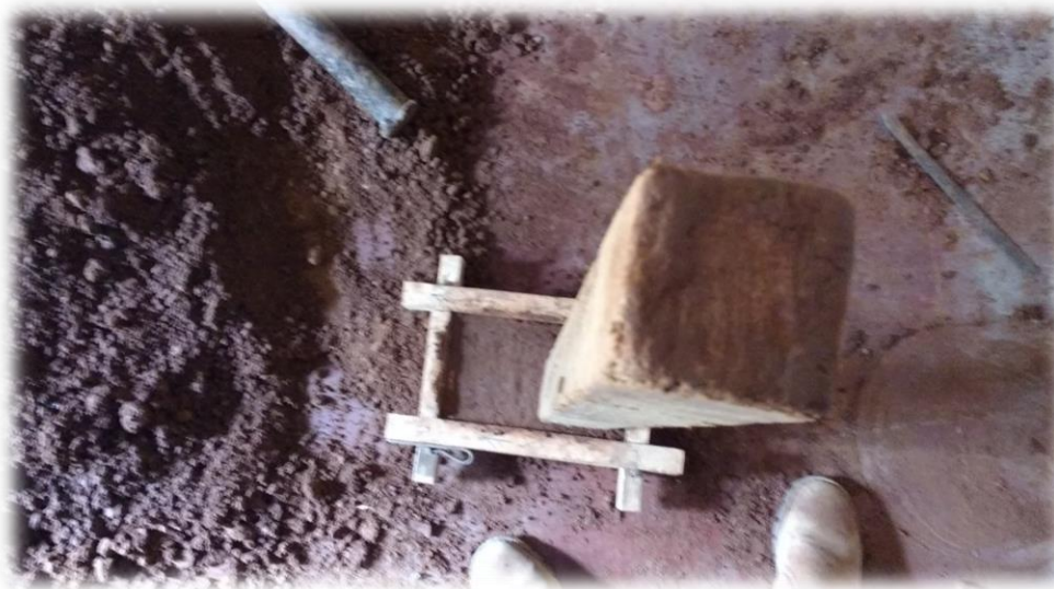
Fotografía N° 12. En la imagen podemos apreciar la elaboración del Adobe la compactación se realizó teniendo en cuenta las indicaciones de Proctor, es decir 25 golpes con masó de 5kg por cada capa (3capas).
