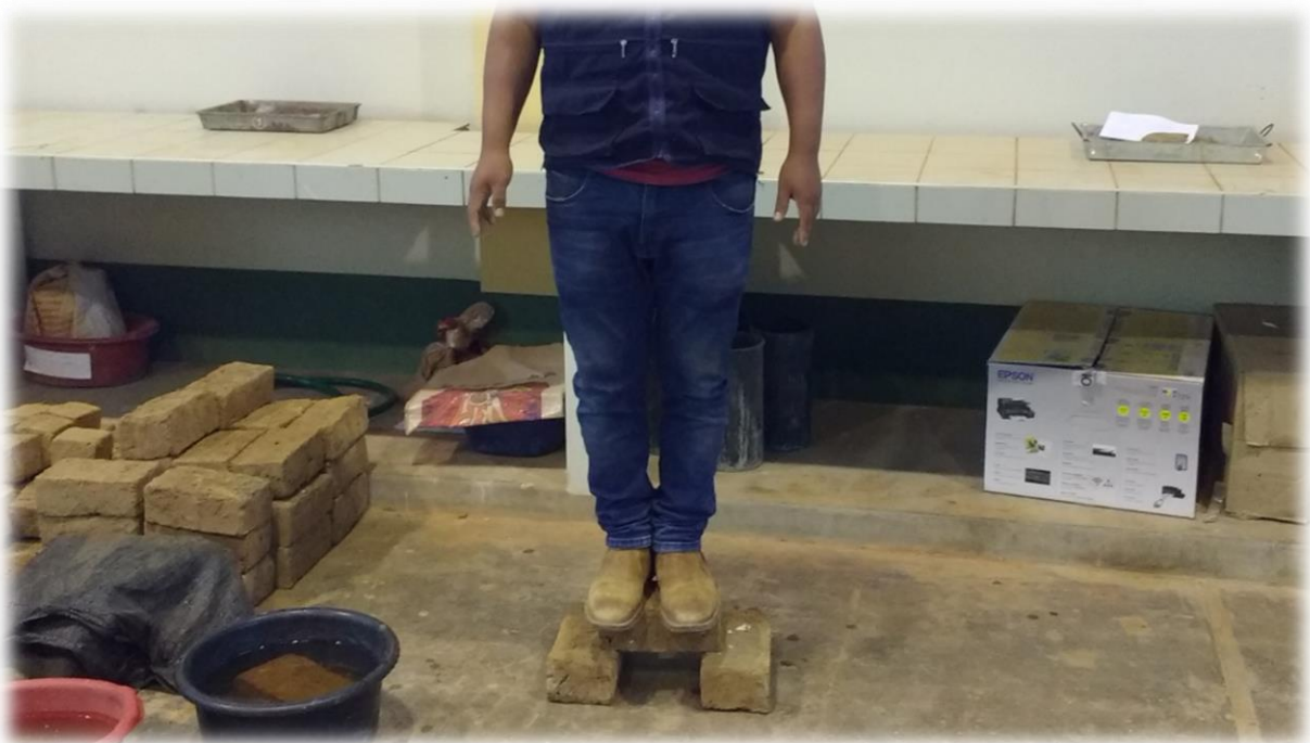
Fotografía N° 03. Adobe de prueba (prueba de resistencia).
