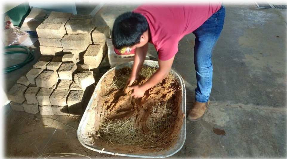
Fotografía N° 15. En la imagen podemos apreciar la elaboración del Mortero (Laboratorio de la FIC-UNHEVAL).
