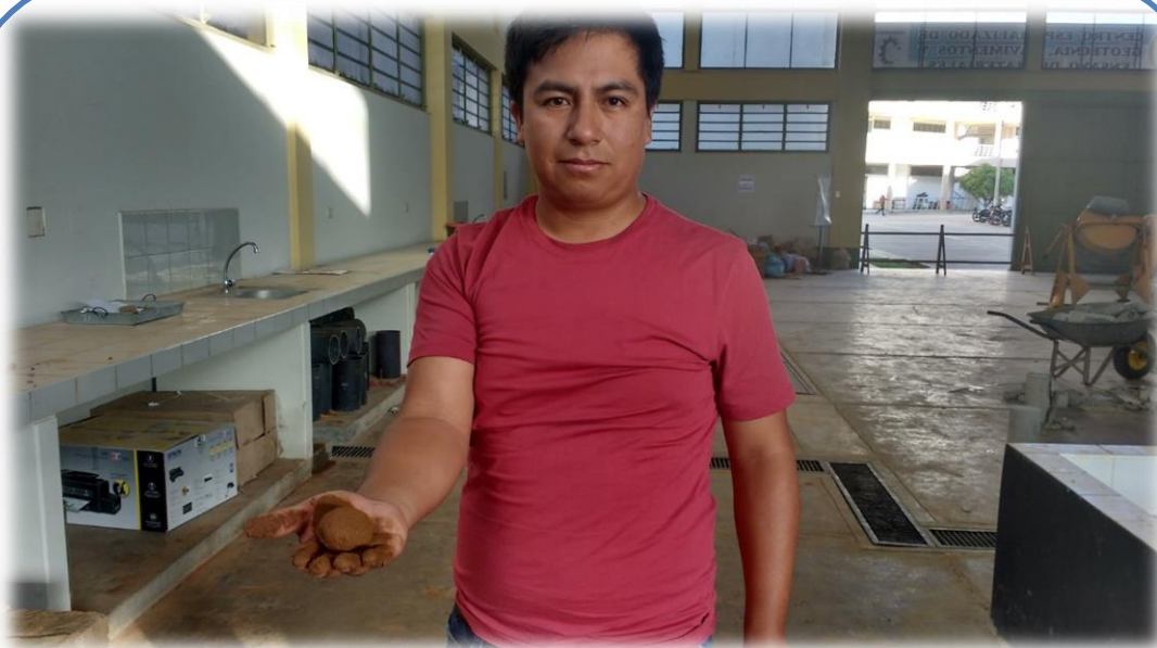
Fotografía N° 03. En la imagen podemos apreciar: Prueba de la resistencia seca de la bolita – cantera cruz pata
