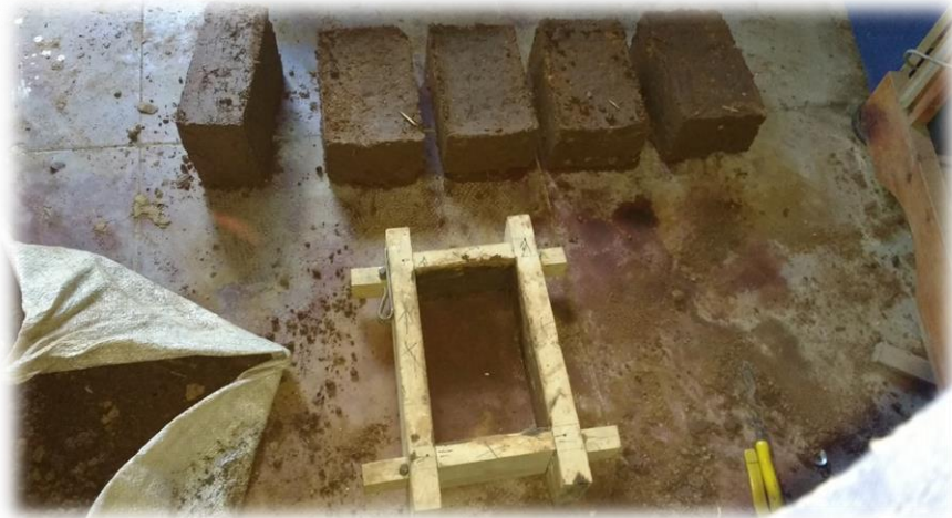
Fotografía N° 11. En la imagen podemos apreciar la elaboración del Adobe compactando la tierra humedecida con el aditivo impermeabilizante. La compactación se realizó teniendo en cuenta las indicaciones de Proctor.
