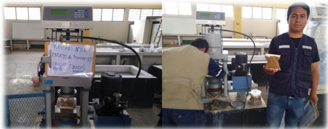
Fotografía N° 10. Ensayo a la compresión de unidades de adobe normal y adobes hechos con el aditivo.
