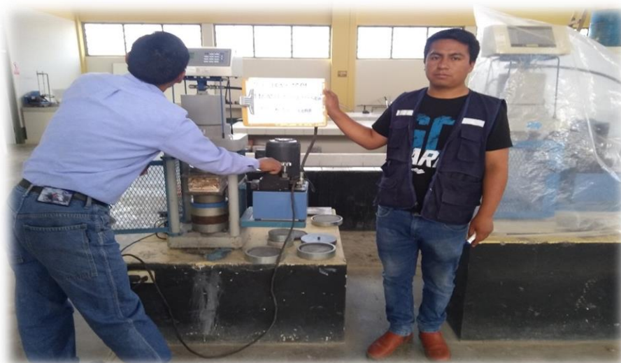
Fotografía N° 20. Ensayo de resistencia a la compresión unidad de adobe de (12*23*9 cm).
