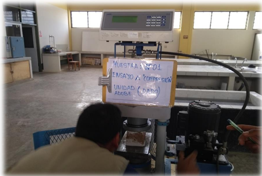
Fotografía N° 19. Ensayo de resistencia a la compresión unidad de adobe de (10*10*10cm).
