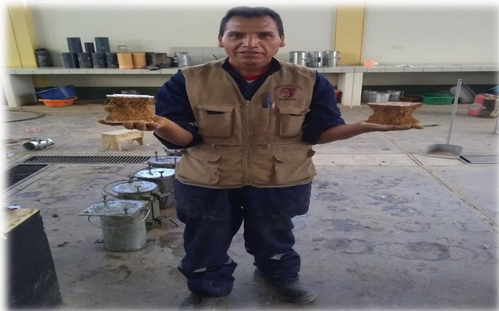
Fotografía N° 22. La unidad de adobe con aditivo y adobe tradicional ensayada presenta una falla adecuada, es decir el plano de falla es de 45^\circ como se aprecia en la imagen.
