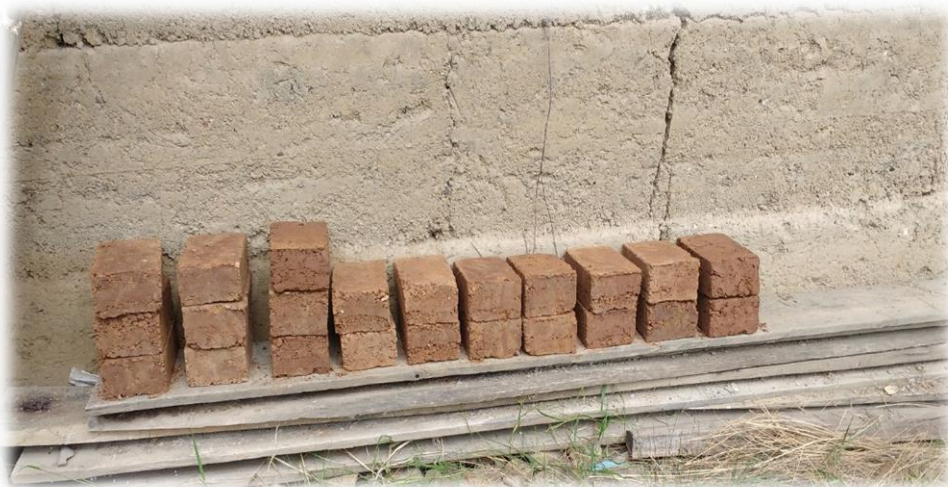
Fotografía N° 14. En la imagen podemos apreciar los adobes ya Elaborados, en proceso de secado para posteriormente a los 28 días Aproximadamente ser ensayados en el laboratorio.
