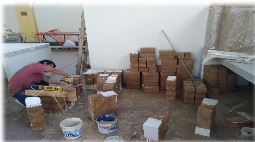
Fotografía N° 18. En la imagen podemos apreciar que ya se encuentran capeados las pilas, y muretes de adobes normales y adobes con aditivo
