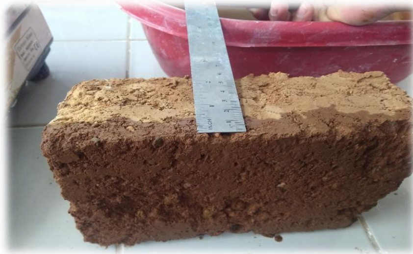
Fotografía N° 07. Ascenso capilar del agua en la muestra del adobe elaborado con el aditivo impermeabilizante.
