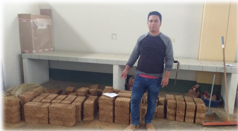
Fotografía N° 17. En la imagen podemos apreciar que ya se encuentran elaborados las pilas, y muretes de adobes normales y adobes con aditivos (Laboratorio de la FIC-UNHEVAL).
