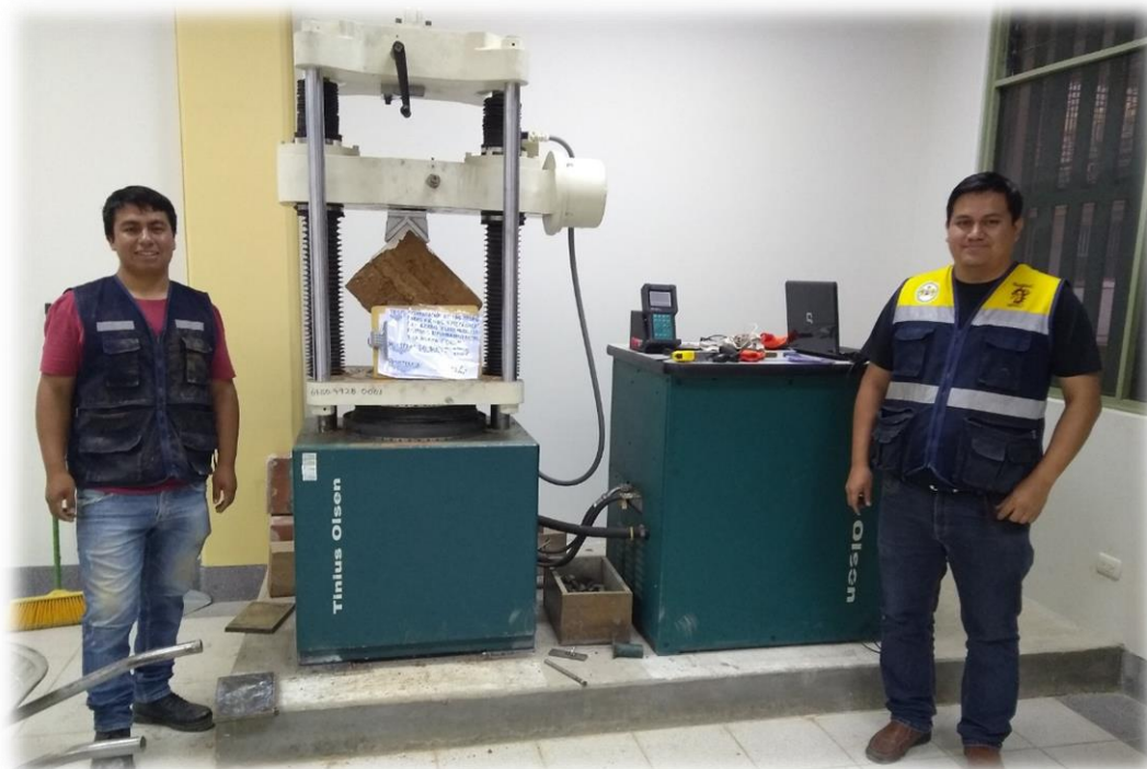
Fotografía N° 26. Ensayo de compresión de muretes del adobe con aditivo en la maquina Universal - FIC-UNHEVAL.
