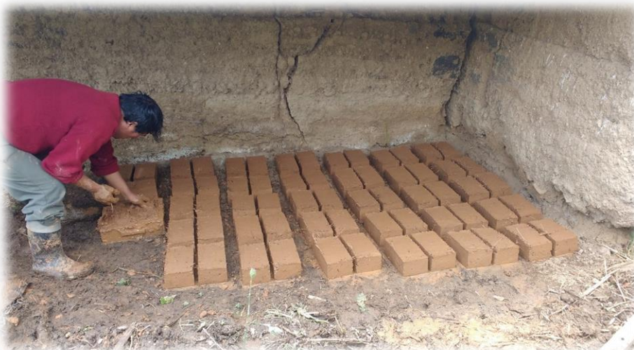
Fotografía N° 06. En la imagen podemos apreciar los adobes ya fabricados, los cuales van secar aproximadamente 28 días para realizar los ensayos en el laboratorio de la FIC- UNHEVAL.
