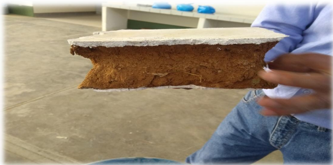
Fotografía N° 21. La unidad de adobe con aditivo ensayada presenta una falla adecuada, es decir el plano de falla es de 45^\circ como se aprecia en la imagen.
