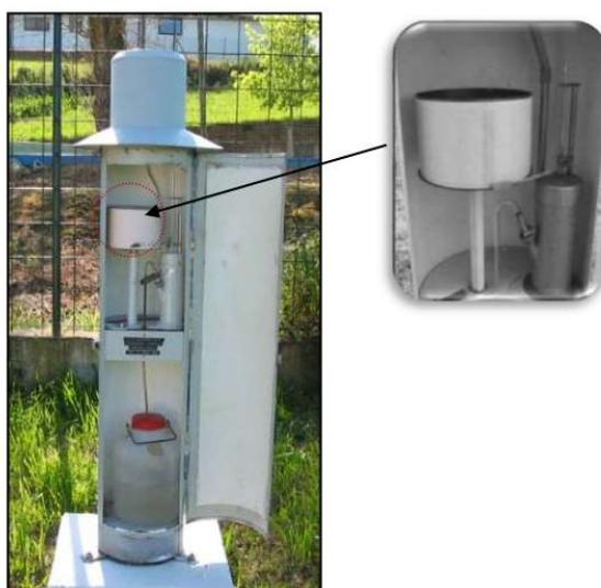
**Figura 16.** Pluviógrafo de Flotador Automático
