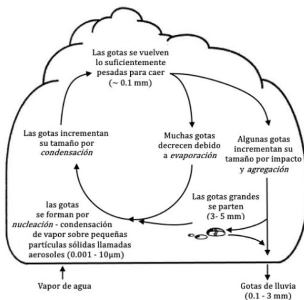
**Figura 4.** Formación de la precipitación en las nubes. Fuente: V.T. Chow, 1994.
