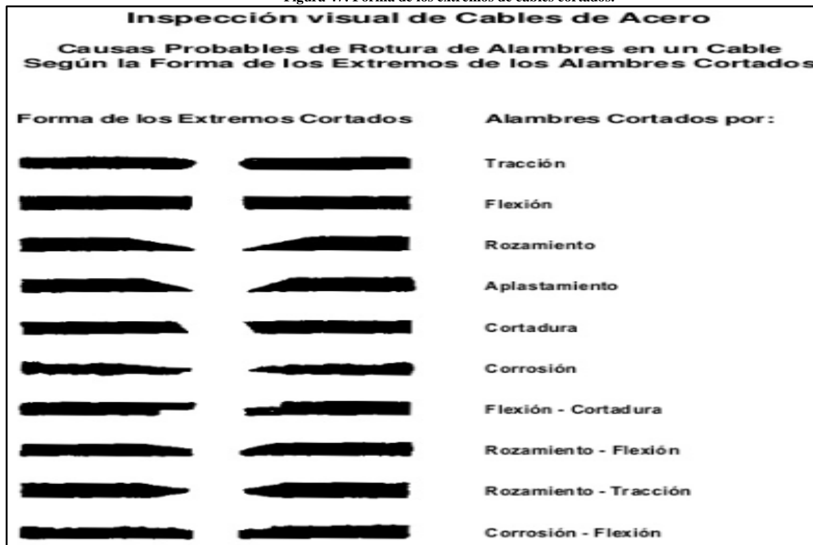
Figura 47: Forma de los extremos de cables cortados.
