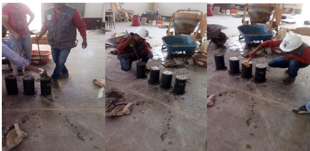
Fotografía N° 9. Elaboración de Probetas.
