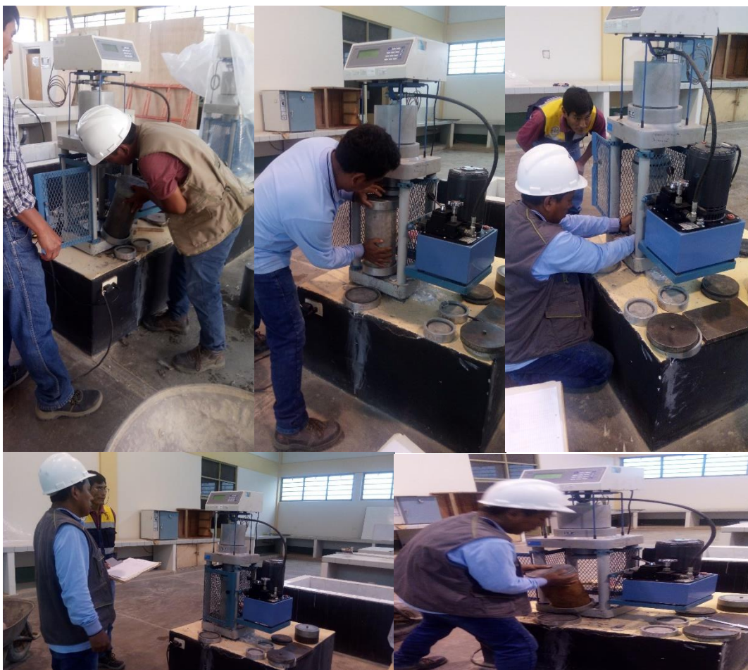
Fotografía N° 18. Ensayo de probetas de concreto en estado endurecido.
