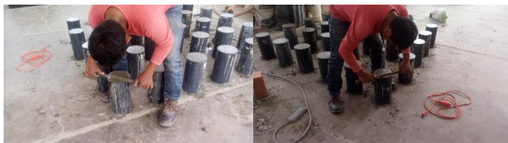
Fotografía N° 10. Acabado final de la elaboración de Probetas.
