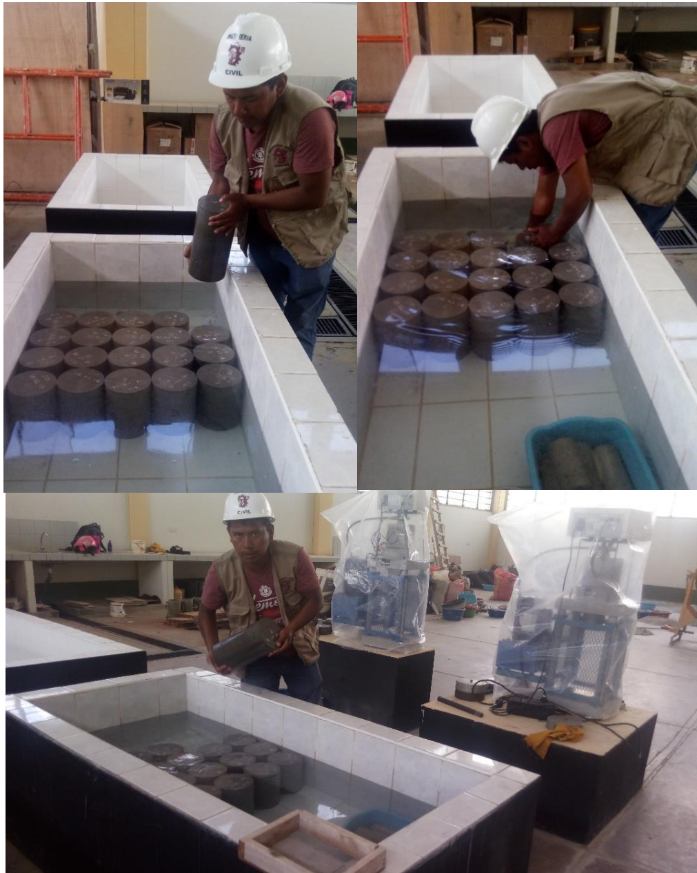
Fotografía N° 14. Curado sumergido en agua de probetas de concreto hidráulico.
