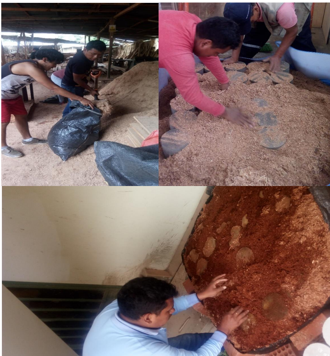
Fotografía N° 15. Curado con fibras de celulosas unidas con lignina de probetas de concreto hidráulico.
