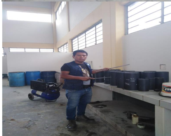
Fotografía N° 6. Moldes de probetas de plástico de 6".
