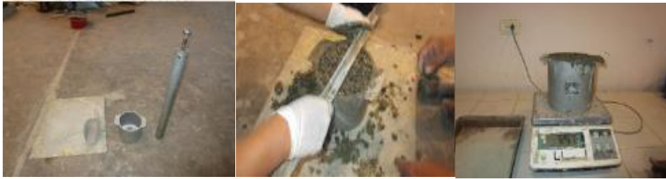
Fotografía N° 17. Ensayo de peso unitario y contenido de aire del concreto.
