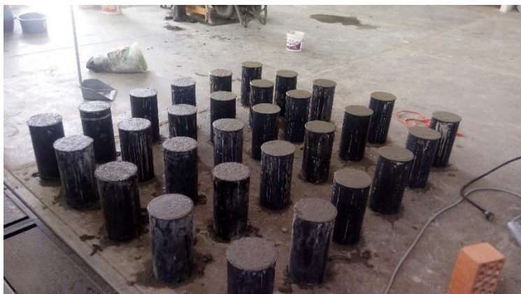
Fotografía N° 11. Moldes finales incluidos internamente las probetas.
