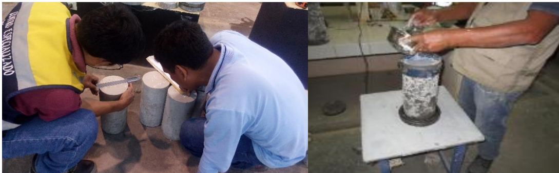
Fotografía N° 16. Capping de probetas de concreto hidráulico.
