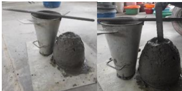
Fotografía N° 7. Ensayo de asentamiento con el cono de Abrams.
