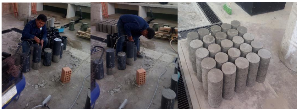
Fotografía N° 12. Desmoldado de las probetas.
