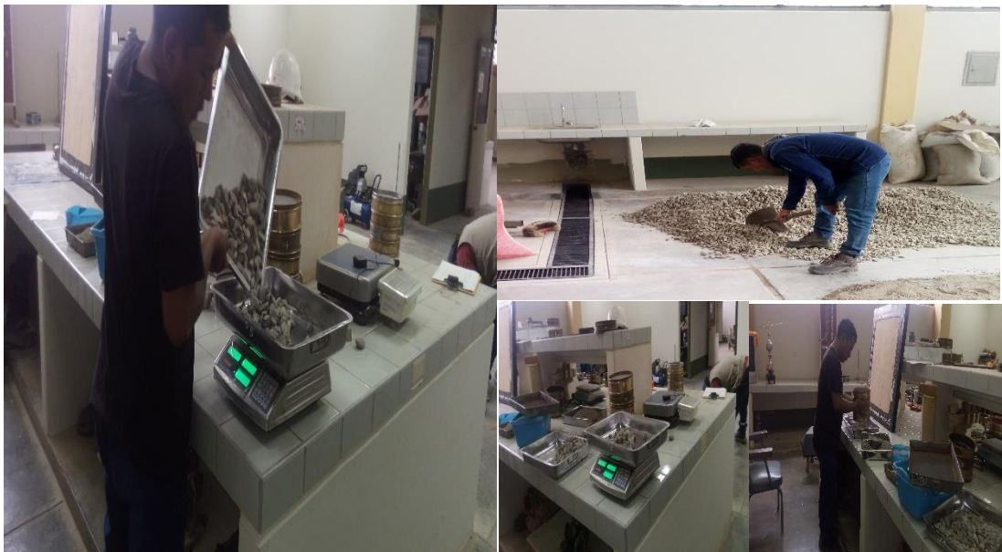
Fotografía N° 1. Ensayo de Granulométrica del Agregado Grueso.
