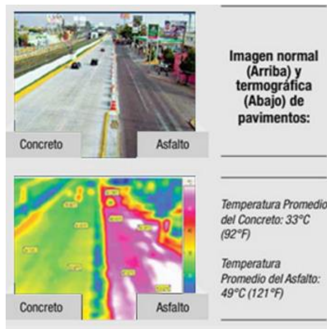
Figura 43. Efecto de la temperatura en los pavimentos.
