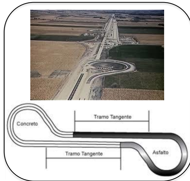
Figura 19. Autopista de prueba del experimento AASHTO.
