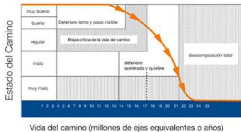
Gráfico 1. Vida útil de un pavimento
