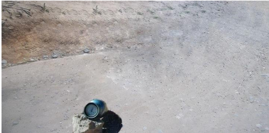
Gráfico 19: Determinación de contenido de humedad insitu (Medidor Humedad tipo Speedy)
