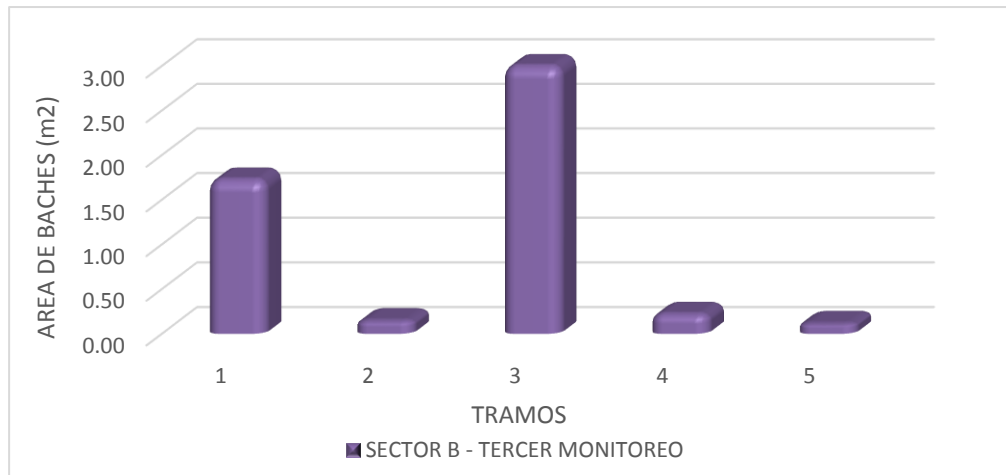
Gráfico 4.19.- Deterioro superficial (baches) – Sector con enzima pz-22x Fuente: Elaboración Propia
