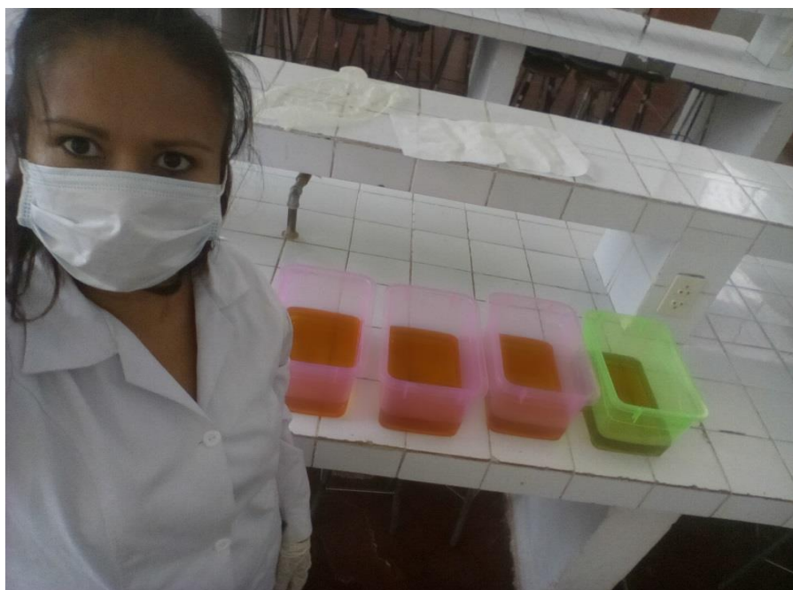
Foto 6: Se filtró con una gasa y luego con papel filtro doble hoja, se obtuvo la tintura de cicuta, la cual se evaporó en la estufa a 40 grados por 48 horas
