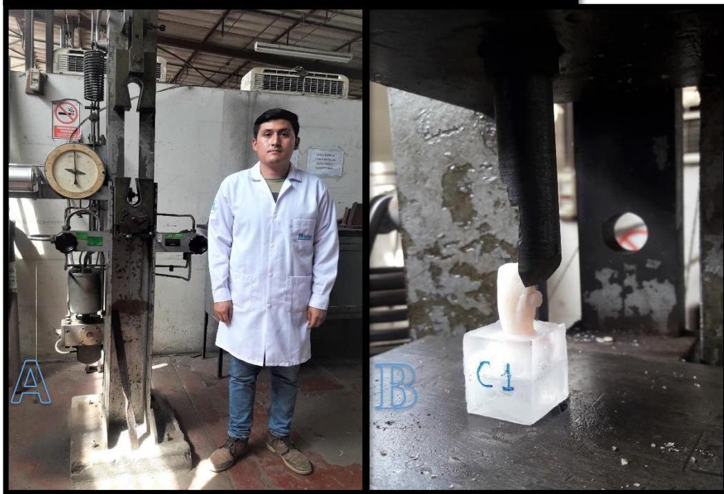
Figura N° 27. A) Fotografía del autor en los laboratorios de prueba de materiales de la Facultad de ingeniería mecánica de la Universidad Nacional de Ingeniería del Perú, al lado de la máquina de ensayos universales Amsler. B) Espécimen sometido al ensayo de cizallamiento.
