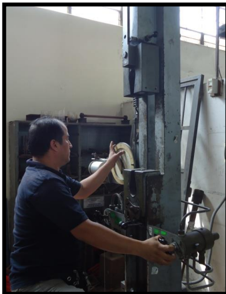
Figura N° 22 y 23. Ensayo de compresión con la máquina de ensayo universal.
