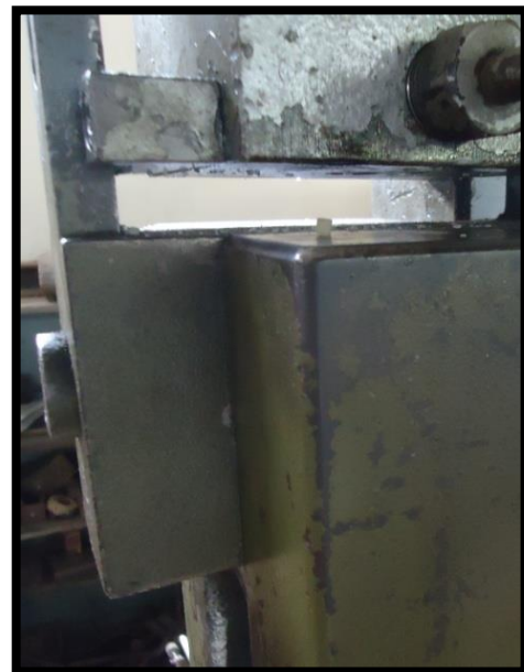
Figura N° 22 y 23. Ensayo de compresión con la máquina de ensayo universal.
