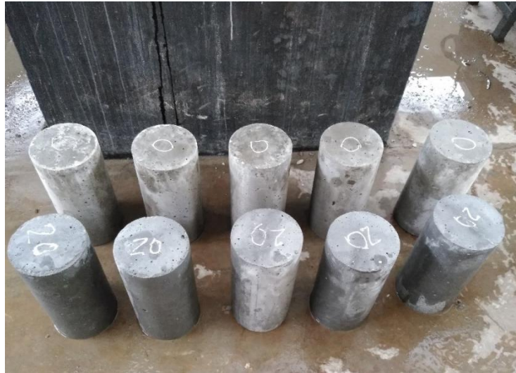
Figura 5: Muestras Cilíndricas De Concreto Para Ensayos De Compresión
