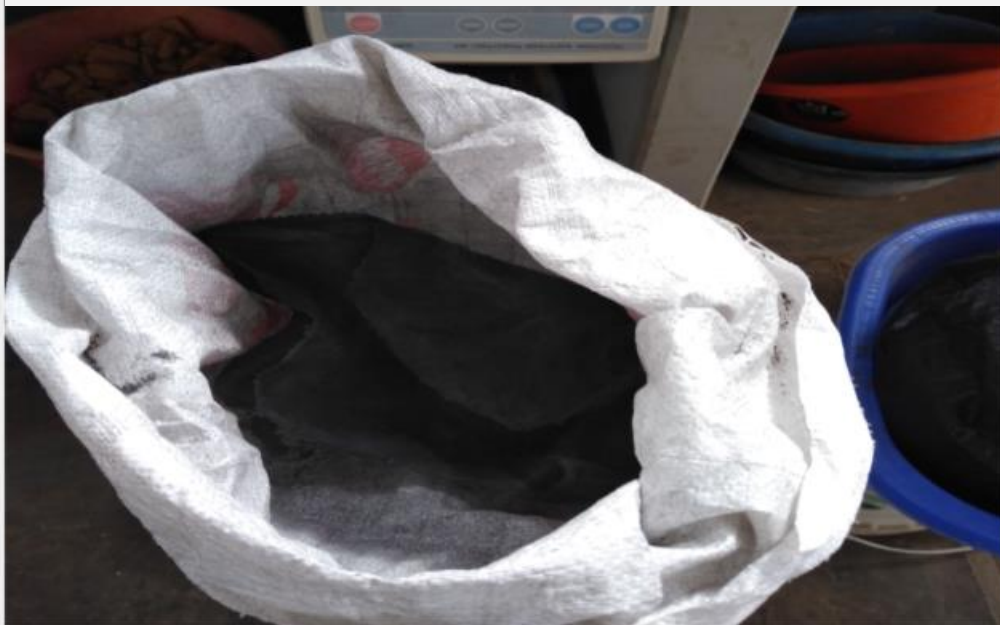
Fotografía 31: Se observa la CBCA en dos bolsas debido a su fineza.
