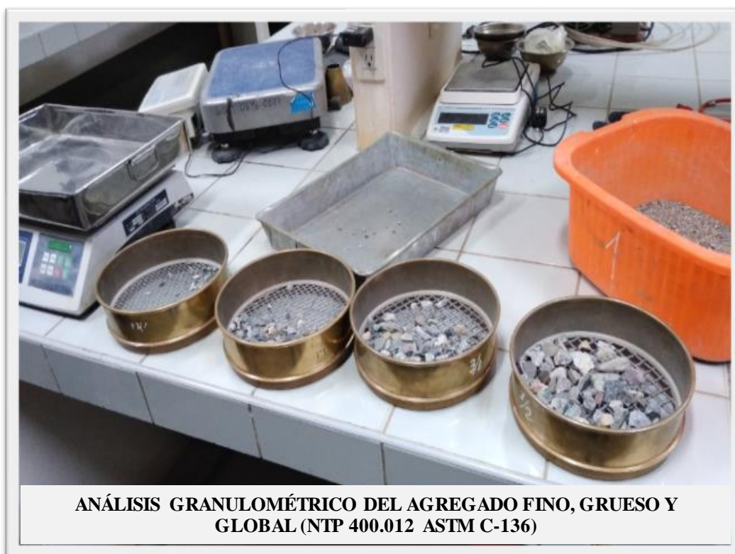
Fotografía 15: Se distingue al tesista realizando el ensayo granulométrico de la muestra de piedra.
