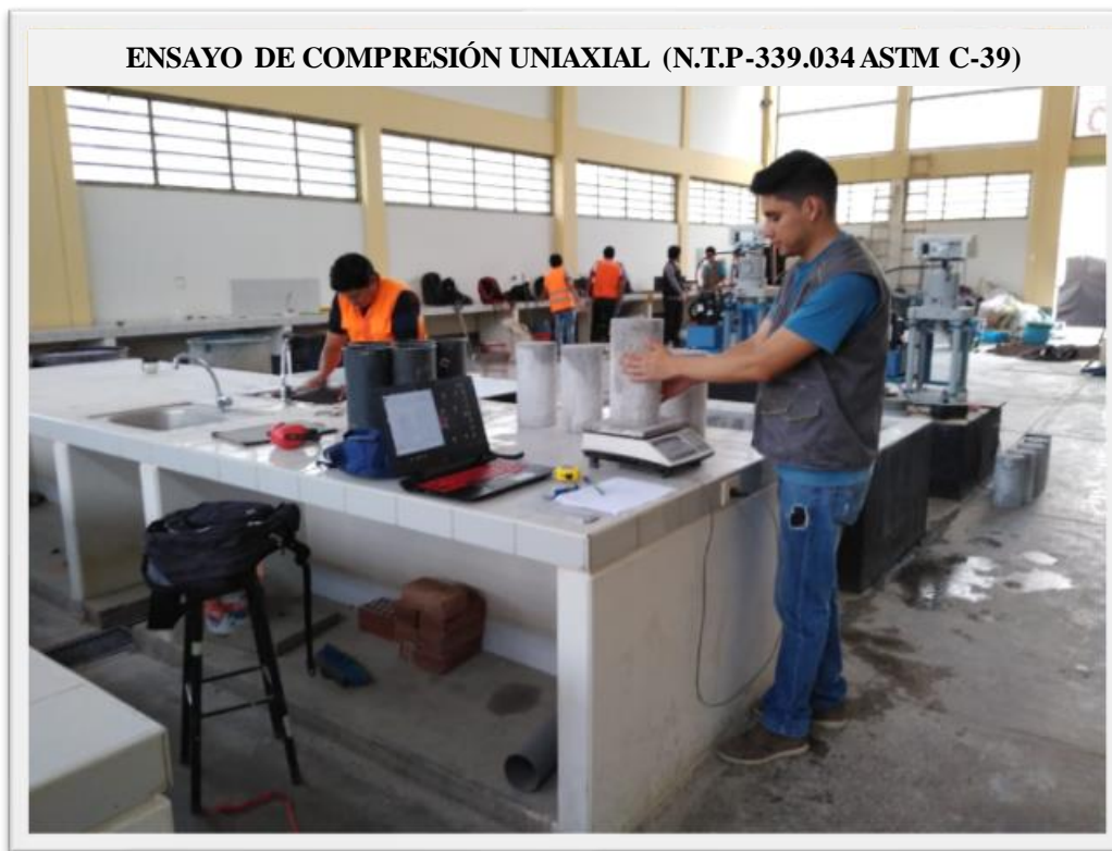
Fotografía 55: Luego se procedió a pesar cada probeta siguiendo con la recolección de datos.
