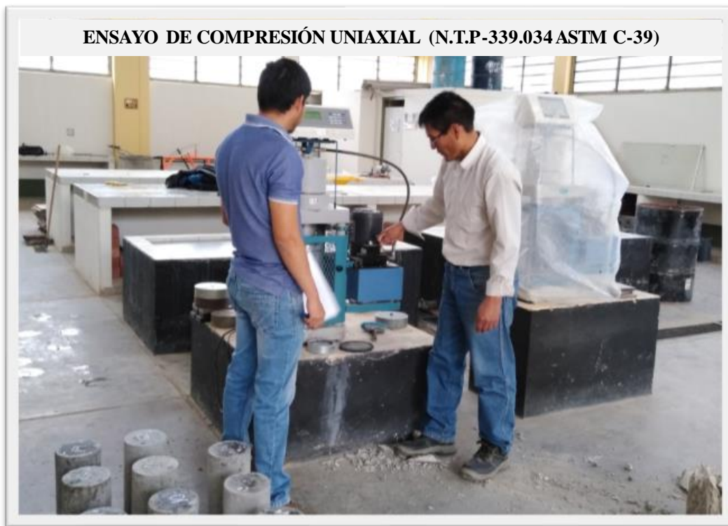
Fotografía 59: Se procedió al montaje de los especímenes en la prensa de compresión y se realizó el ensayo.
