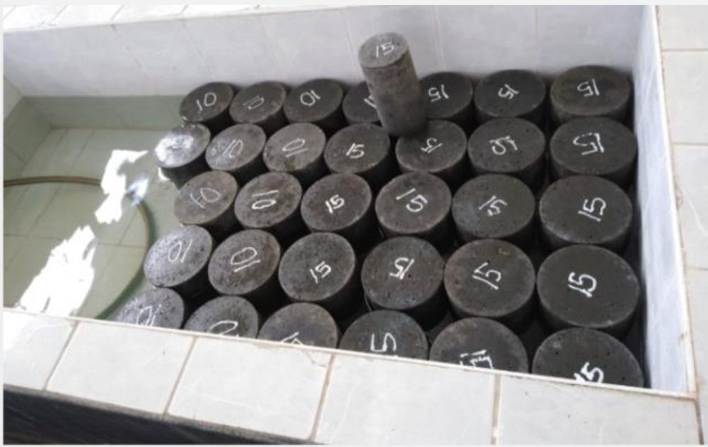
Fotografía 49: Luego de retirarlas se procedió a marcarlas para su posterior identificación.
