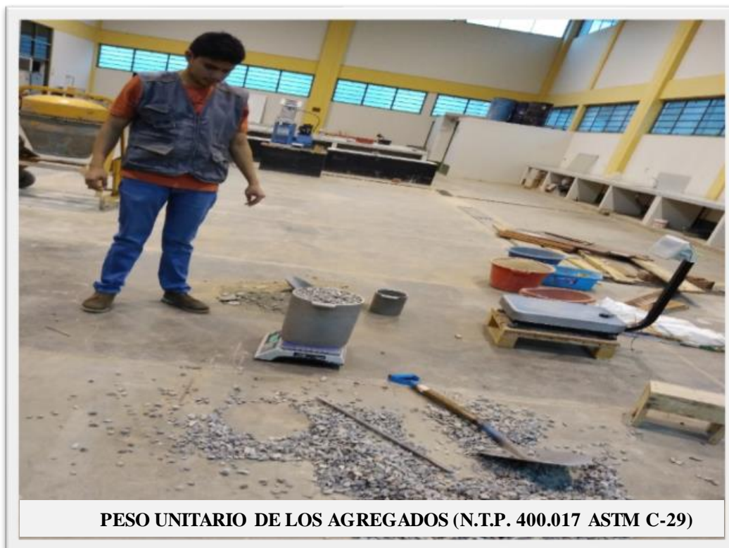
Fotografía 3: Se observa la nivelación de la superficie con la varilla de apisonado.
