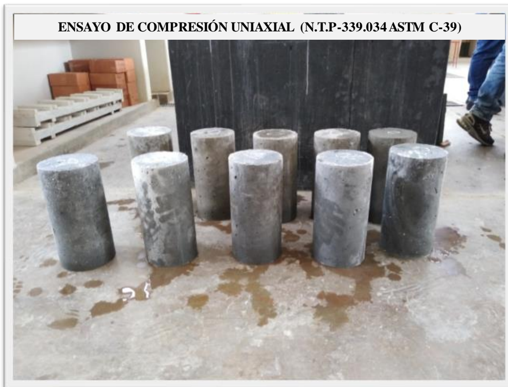
Fotografía 51: Observamos un grupo de probetas las cuales se someterán al ensayo de compresión.
