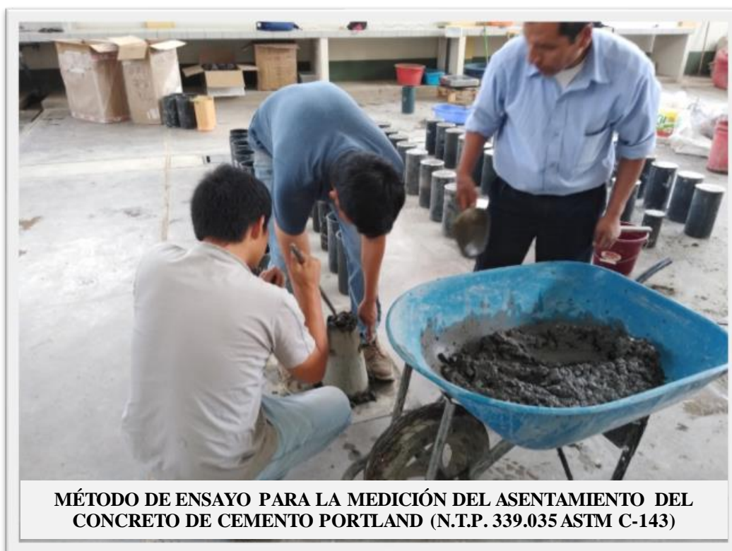
Fotografía 39: El molde mojado se mantiene firme mientras el personal llena el mismo en 3 capas.
