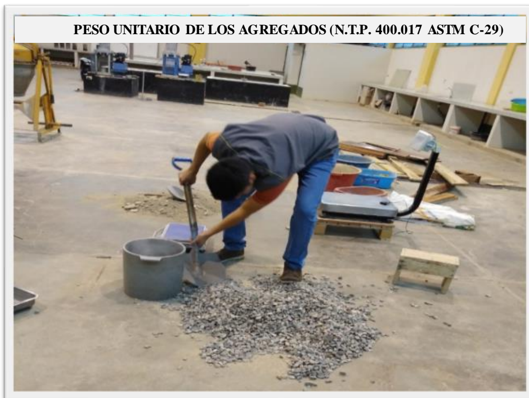
Fotografía 1: Se observa al tesista vaciando la piedra al recipiente metálico con agarraderas.
