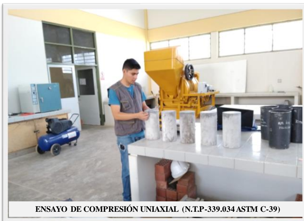
Fotografía 54: Se tomó dos anotaciones por cada lado, orientándose así 4 lecturas del diámetro para posteriormente promediarlas y hallar el área de contacto.
