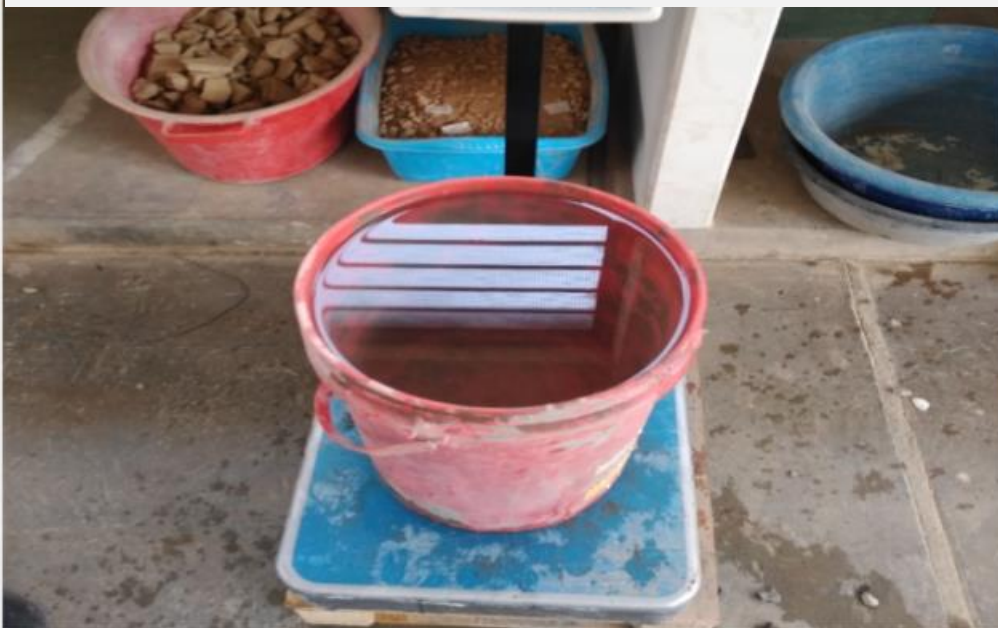
Fotografía 37: Observamos el peso de la cantidad de agua necesaria para la mezcla.
