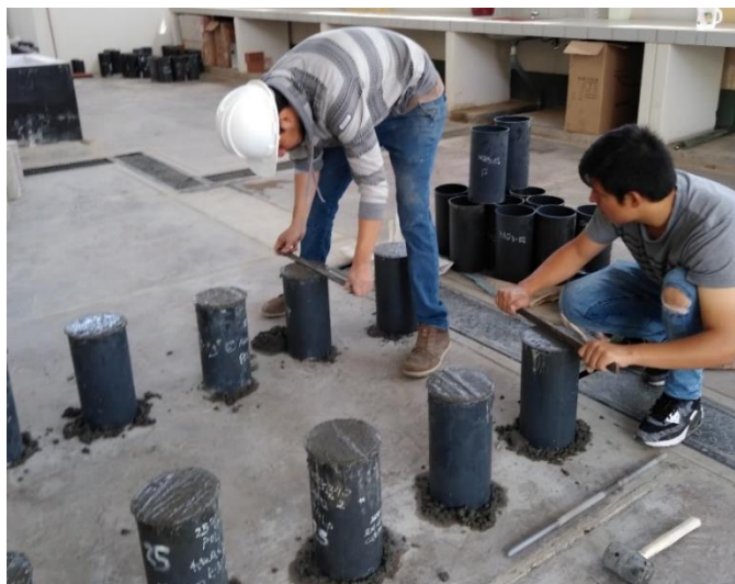
Figura 29: Enrase y alisamiento de superficie de probetas
