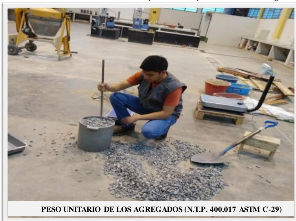
Fotografía 1: Se observa al tesista vaciando la piedra al recipiente metálico con agarraderas.
