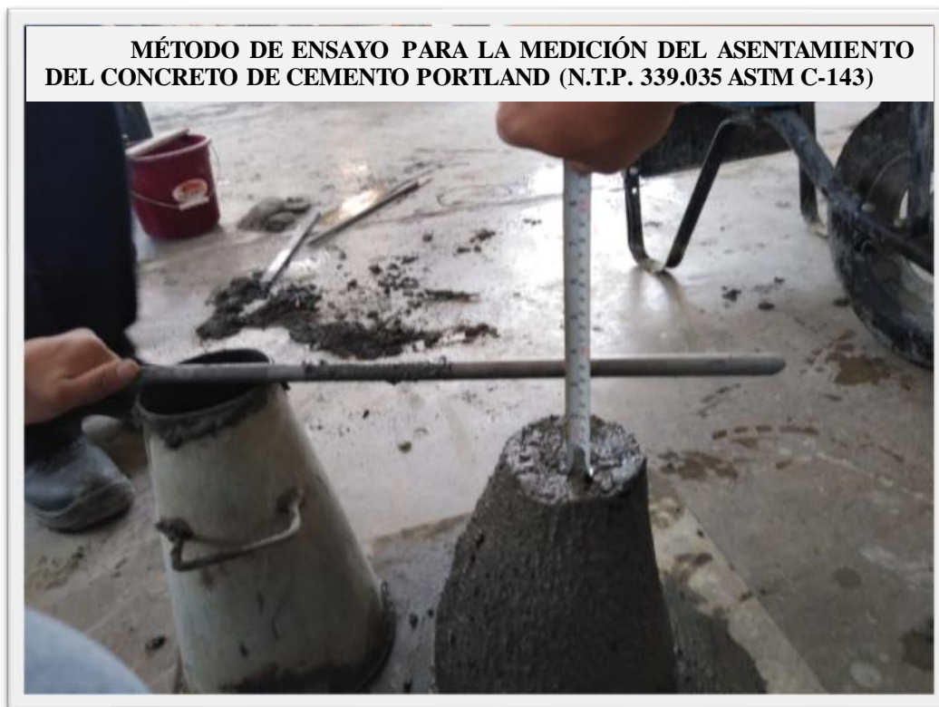
Fotografía 41: Rápidamente se procedió a medir el asentamiento que homogéneamente fue de 3”.
