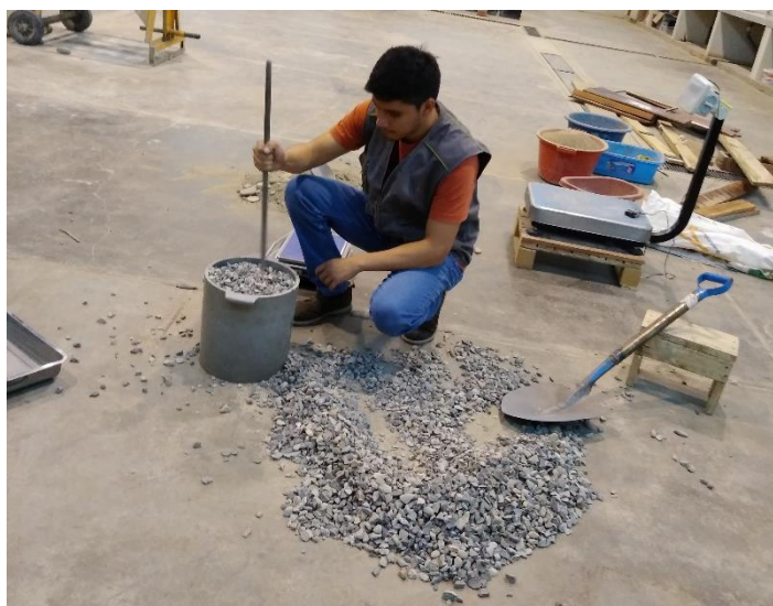
Figura 20: Ensayo de Peso Unitario Compactado del Agregado Grueso
