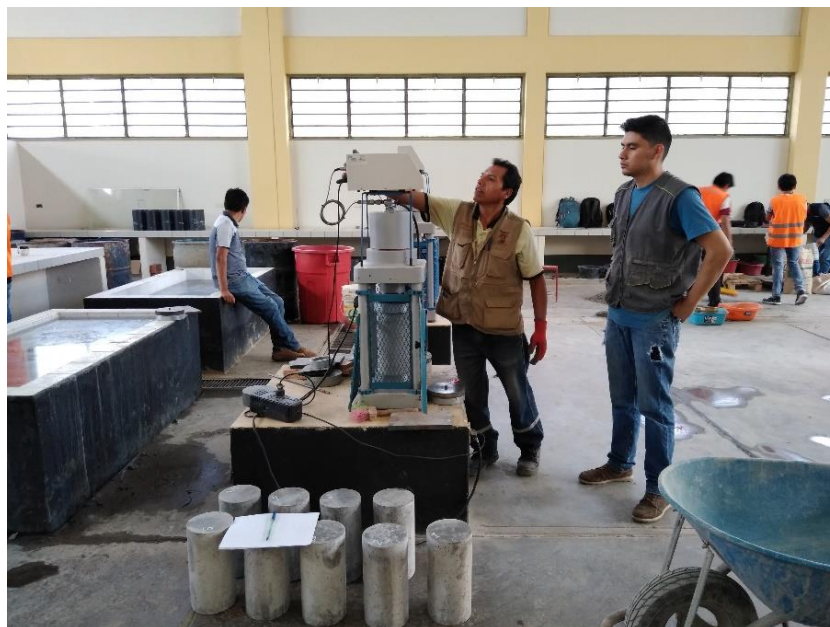
Figura 33: Realización del ensayo de Compresión Uniaxial
