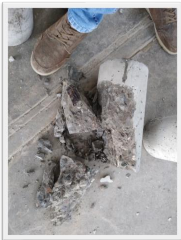
Fotografía 61: Probeta de Concreto con Ceniza al 10% con una falla tipo 4.
