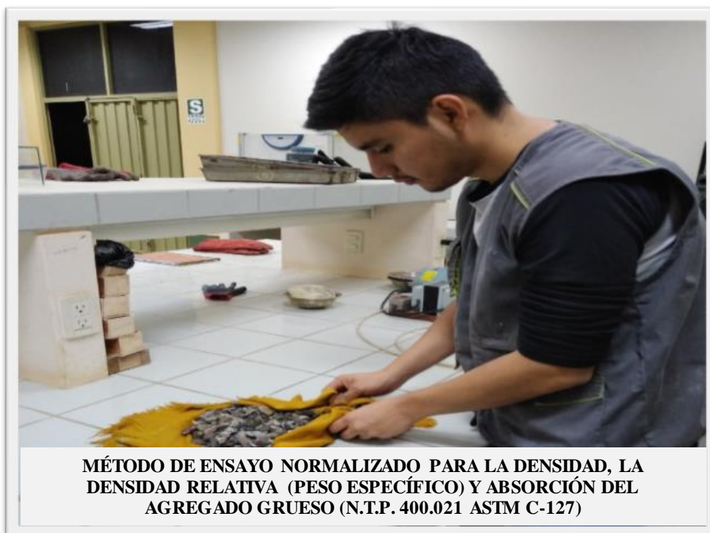
Fotografía 21: Se sumergió la muestra en agua por 24h y se calculó su peso sumergido.
