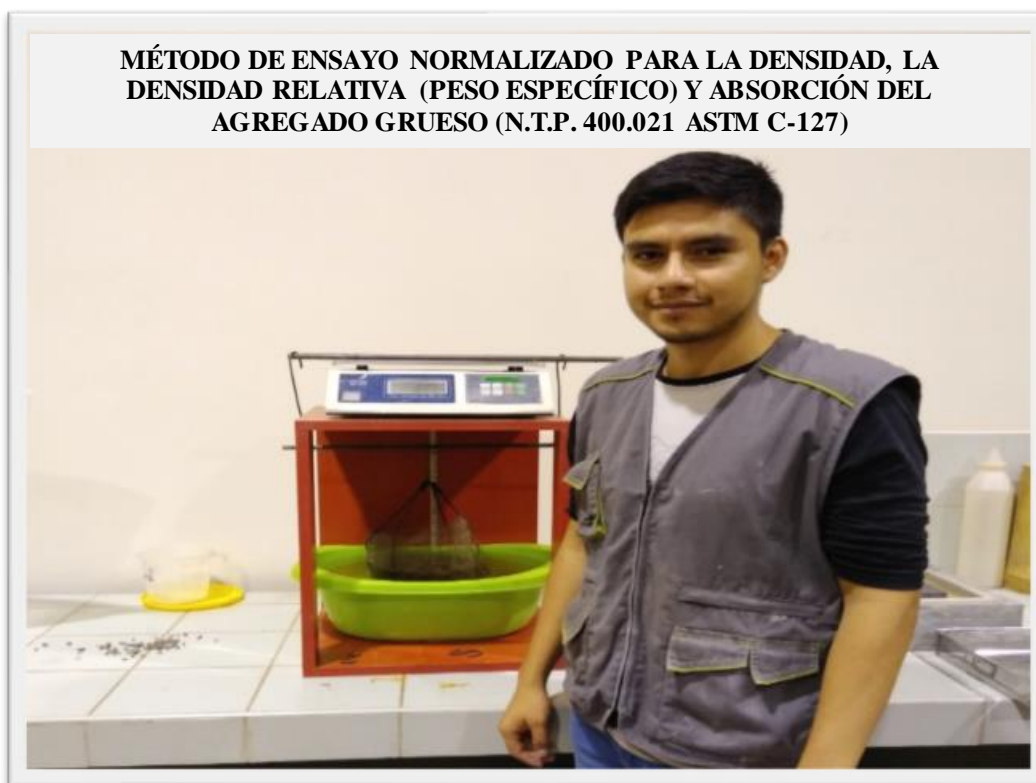
Fotografía 21: Se sumergió la muestra en agua por 24h y se calculó su peso sumergido.
