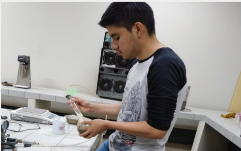
Fotografía 19: Se observa la muestra siendo vertida en el picnómetro.
