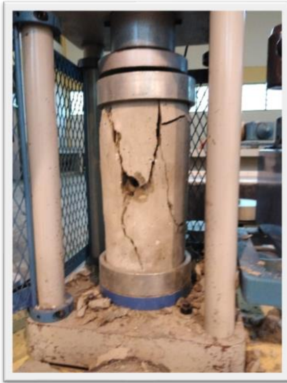
Fotografía 63: Probeta de Concreto con Ceniza al 5% con una falla tipo 3.
