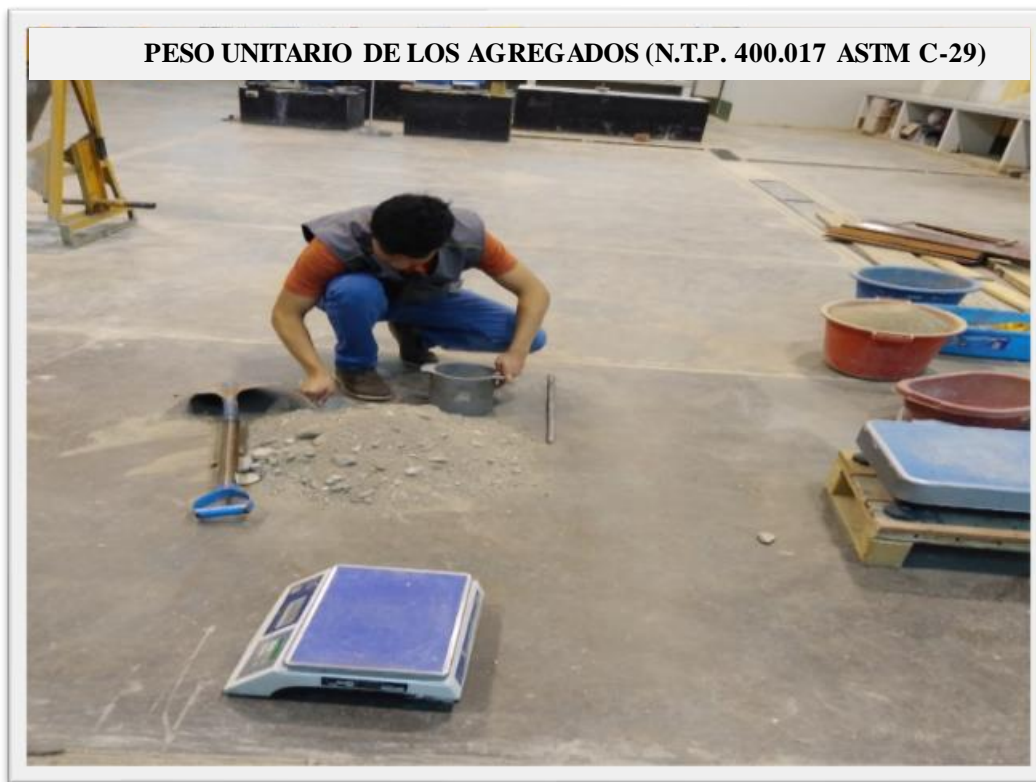
Fotografía 5: Se observa al tesista vaciando la arena gruesa al recipiente metálico con agarraderas.
