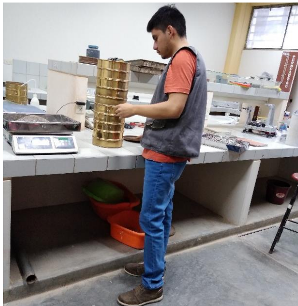
Figura 11: Ensayo de Granulometría.
