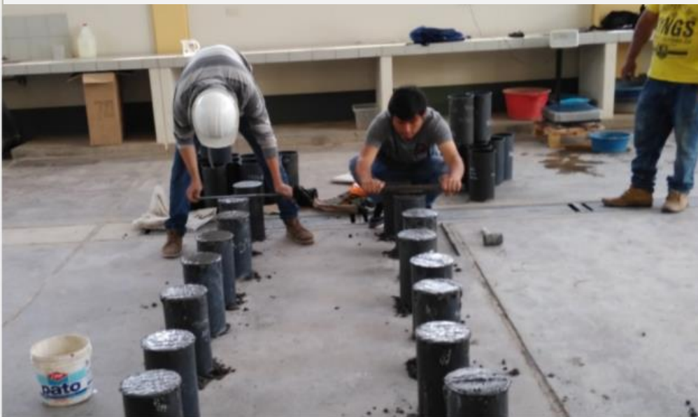
Fotografía 45: Se visualiza el enrase de las probetas, el cual nos permite una superficie nivelada.
