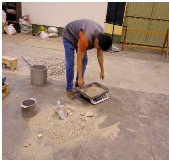
Figura 10: Muestreo del Agregado Fino.
