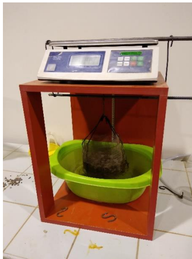
Figura 22: Ensayo de Peso Específico del Agregado Grueso
