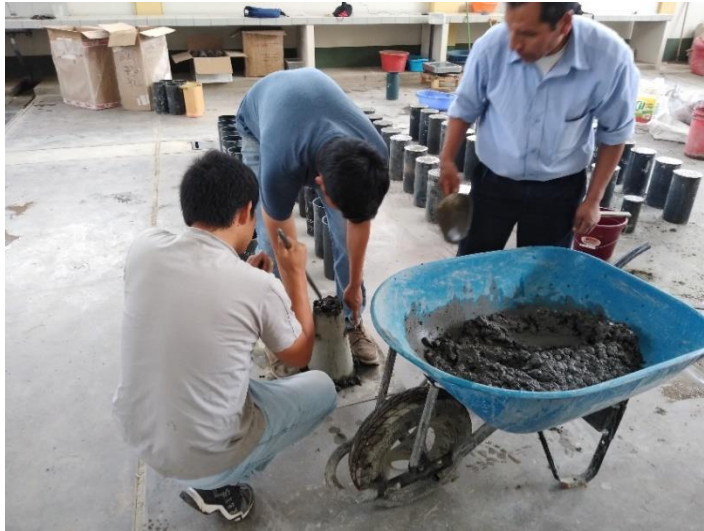
Figura 28: Medición del Revenimiento del concreto.
