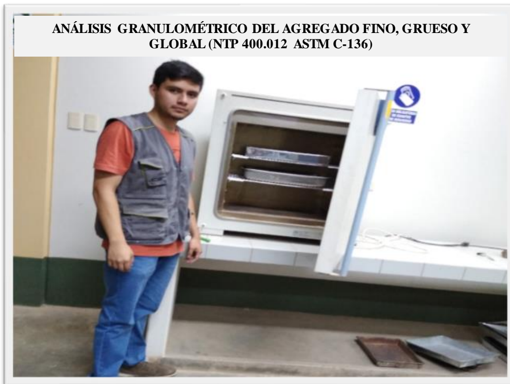
Fotografía 13: Se visualiza las dos muestras en el horno para su posterior análisis granulométrico.
