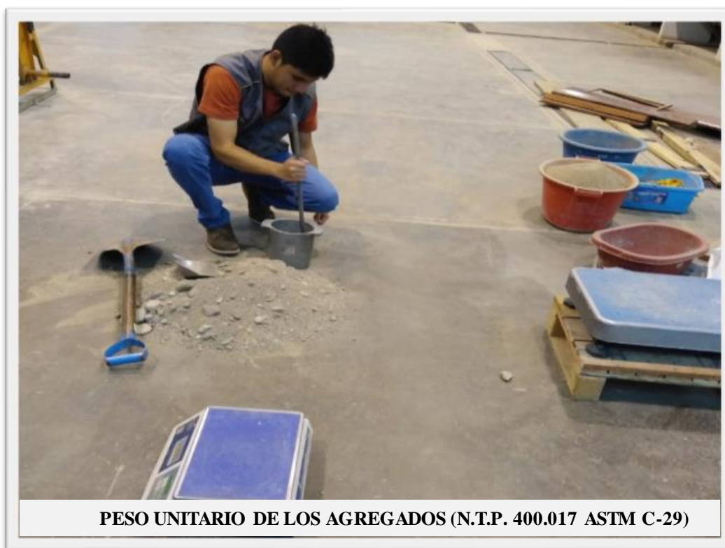
Fotografía 5: Se observa al tesista vaciando la arena gruesa al recipiente metálico con agarraderas.
