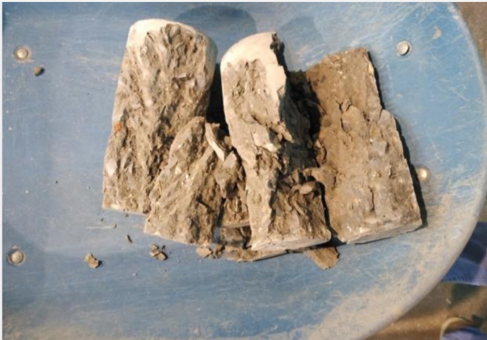
Fotografía 64: Probetas de Concreto con Ceniza al 5% con una falla tipo 3
