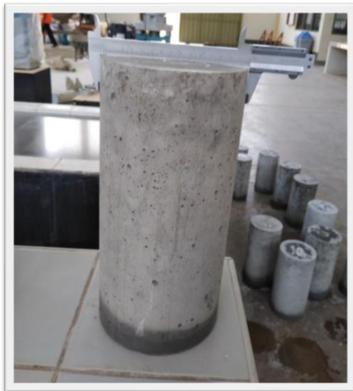
Fotografía 53: Se procedió a medir el diámetro de los especímenes cilíndricos en los extremos.
