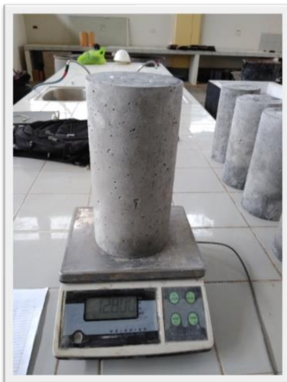
Fotografía 55: Luego se procedió a pesar cada probeta siguiendo con la recolección de datos.
