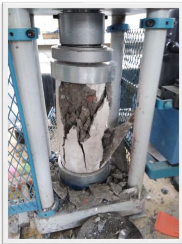
Fotografía 58: Posteriormente se anotó la máxima carga aplicada y se observó el tipo de falla que produjeron los especímenes de concreto.
