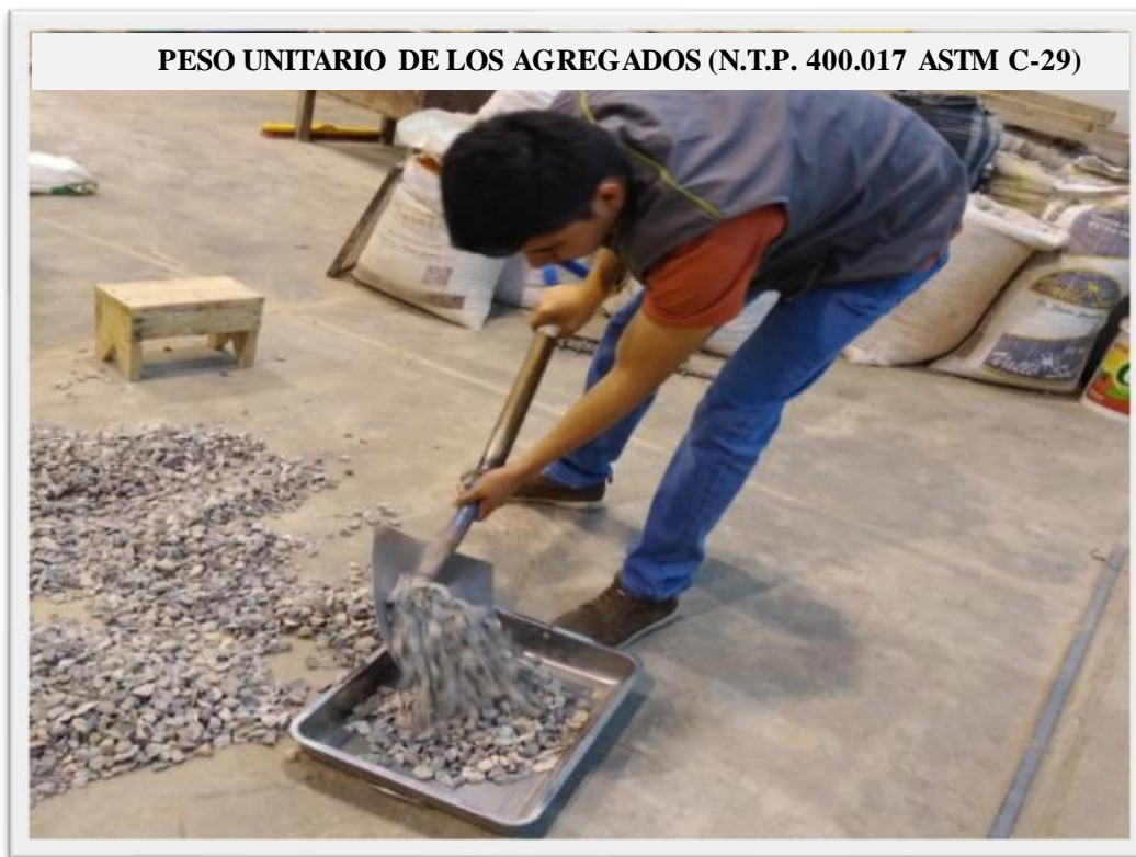
Fotografía 9: Se observa al tesista recolectando una muestra para llevarla al horno.
