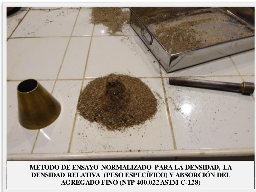
Fotografía 18: Forma cónica terminada que tiene la humedad correspondiente a la condición de superficie seca.
