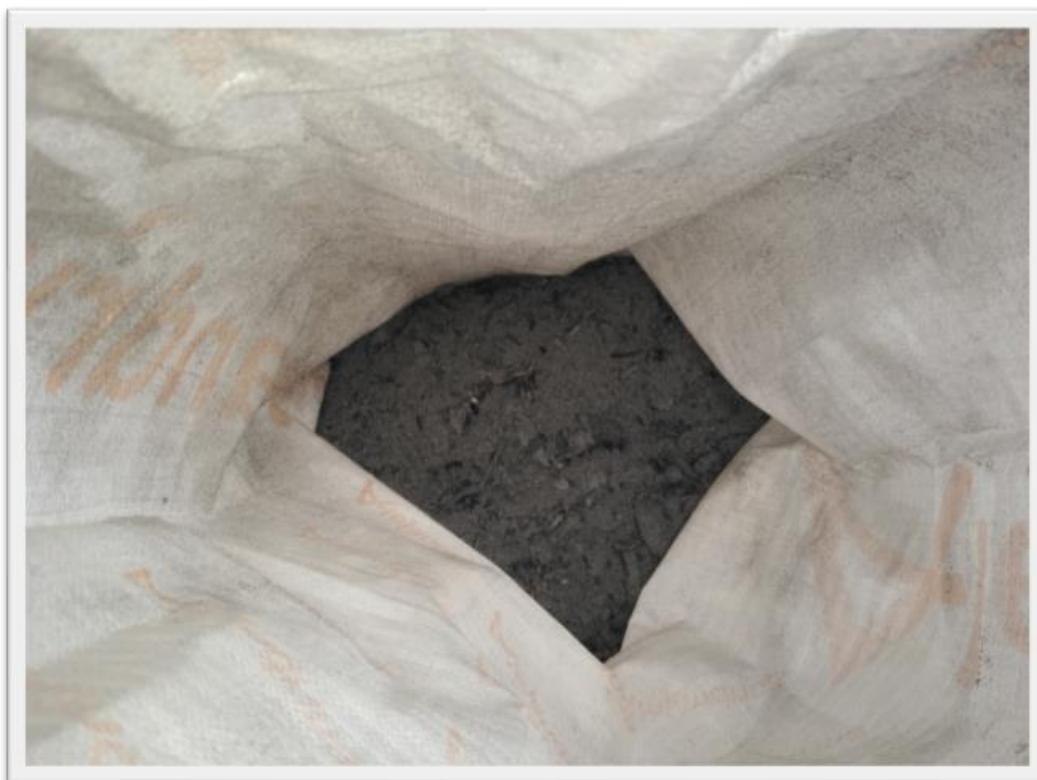
Fotografía 26: Aquí observamos la Ceniza del Bagazo de Caña de Azúcar recolectada.
