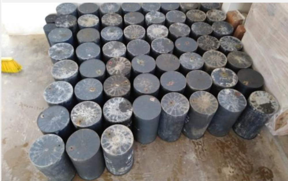
Fotografía 35: Se visualiza los moldes de plástico que usaremos para las probetas.
