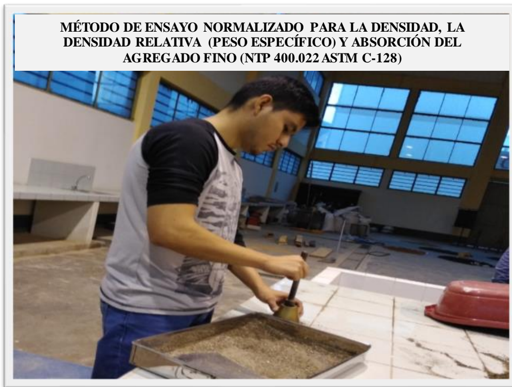
Fotografía 17: Se visualiza al tesista dando los 25 golpes para apisonar la arena en tres capas.
