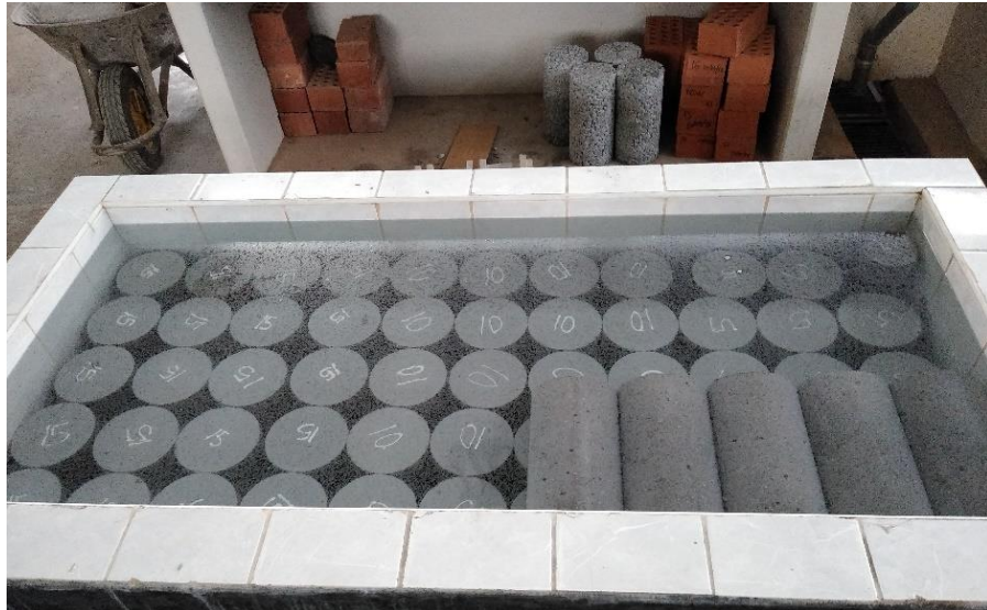
Figura 32: Probetas siendo curadas en las piscinas de inmersión
