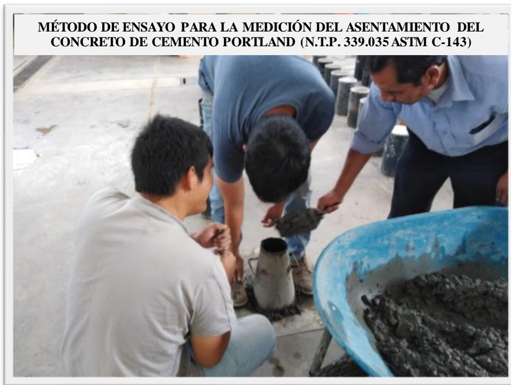
Fotografía 39: El molde mojado se mantiene firme mientras el personal llena el mismo en 3 capas.
