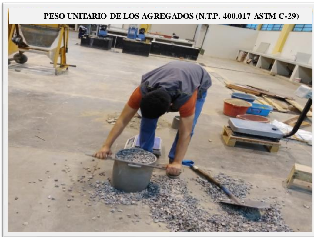
Fotografía 3: Se observa la nivelación de la superficie con la varilla de apisonado.
