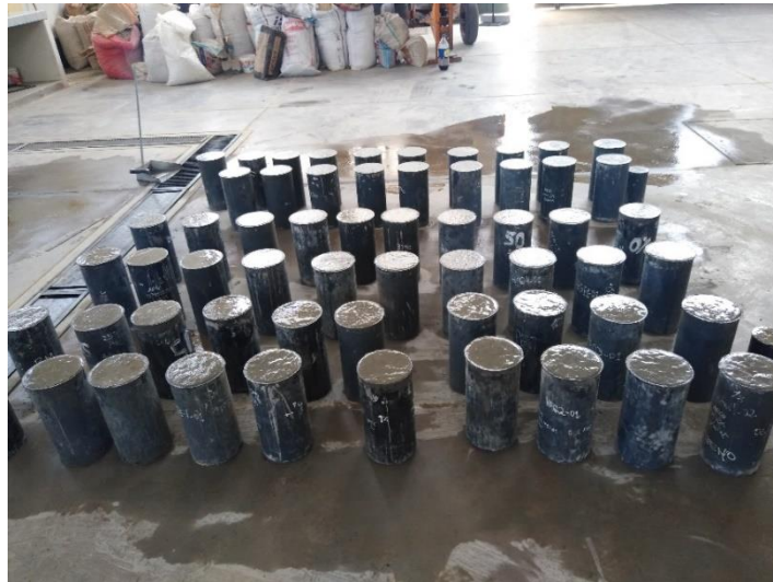
Figura 30: Probetas de Concreto listas para ser almacenadas
