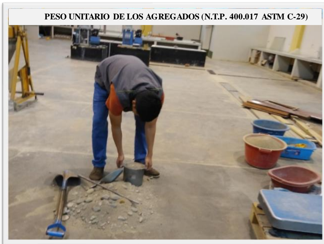
Fotografía 7: Se observa la nivelación de la superficie con la varilla de apisonado.
