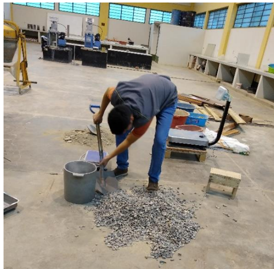
Figura 19: Ensayo de Peso Unitario del Agregado Grueso
