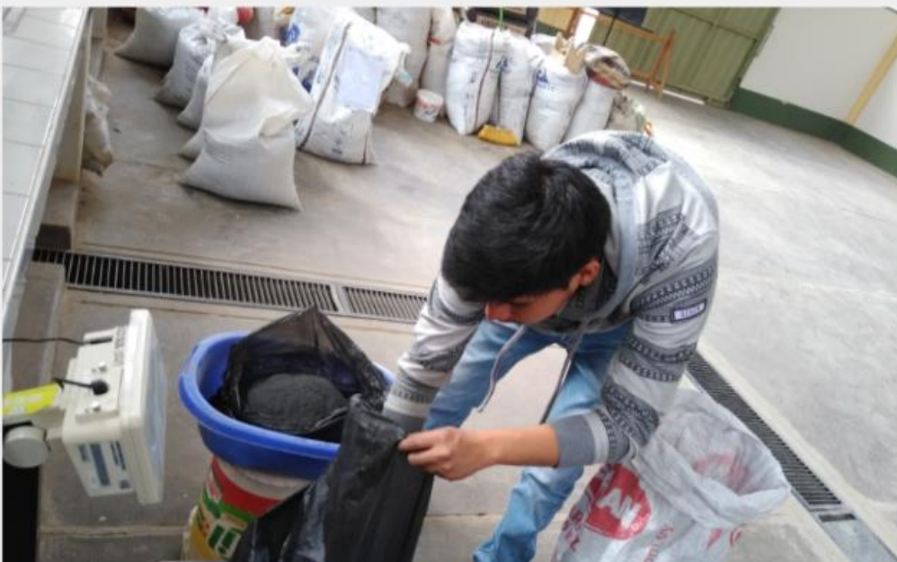
Fotografía 29: Se observa el pesaje de la piedra chancada \frac{3}{4} " para realizar la mezcla.
