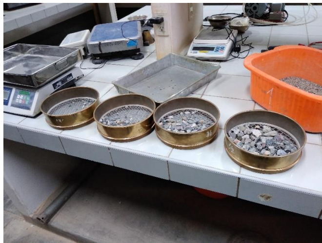
Figura 18: Ensayo de Granulometría del Agregado Grueso.
