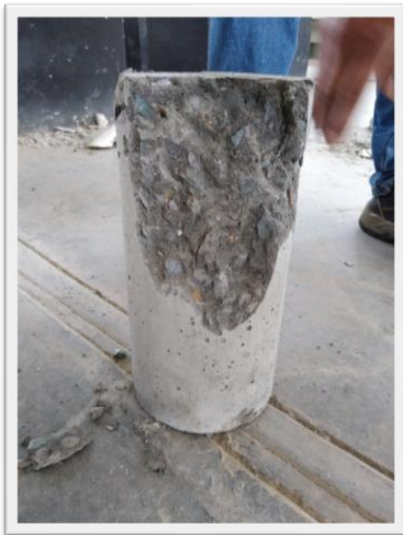
Fotografía 60: Probeta de concreto con ceniza al 20% una falla tipo 4.
