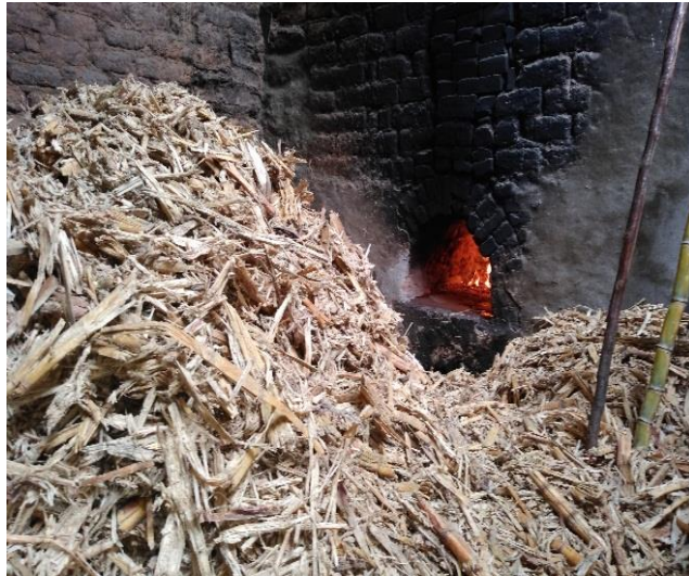
Figura 8: Bagazo de Caña de Azúcar en proceso de Calcinación
