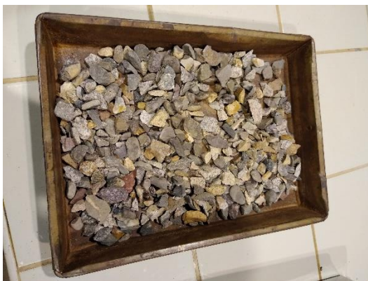
Figura 23: Muestra de Agregado Grueso de la Cantera Figueroa.
