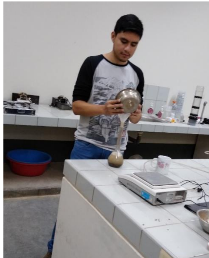
Figura 15: Ensayo de Peso Específico del Agregado Fino
