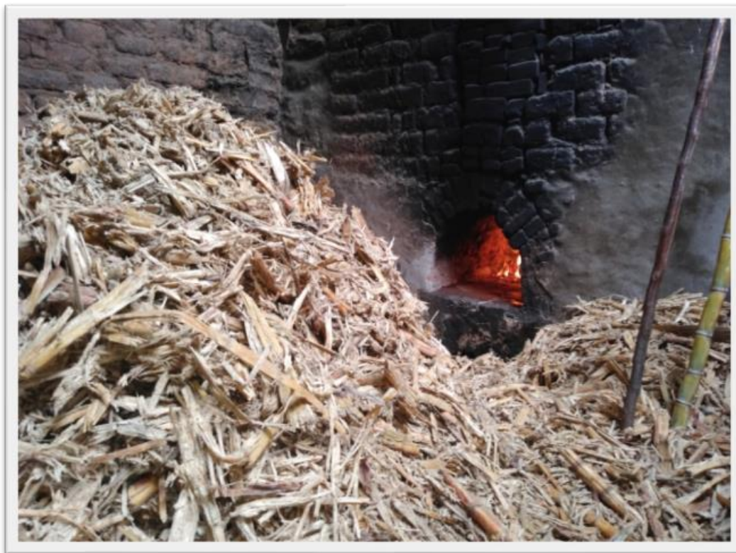
Fotografía 25: El horno del Fundo Pacán funciona enteramente con el bagazo de caña de azúcar.
