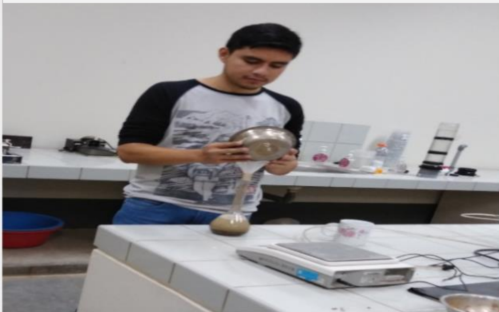
Fotografía 19: Se observa la muestra siendo vertida en el picnómetro.
