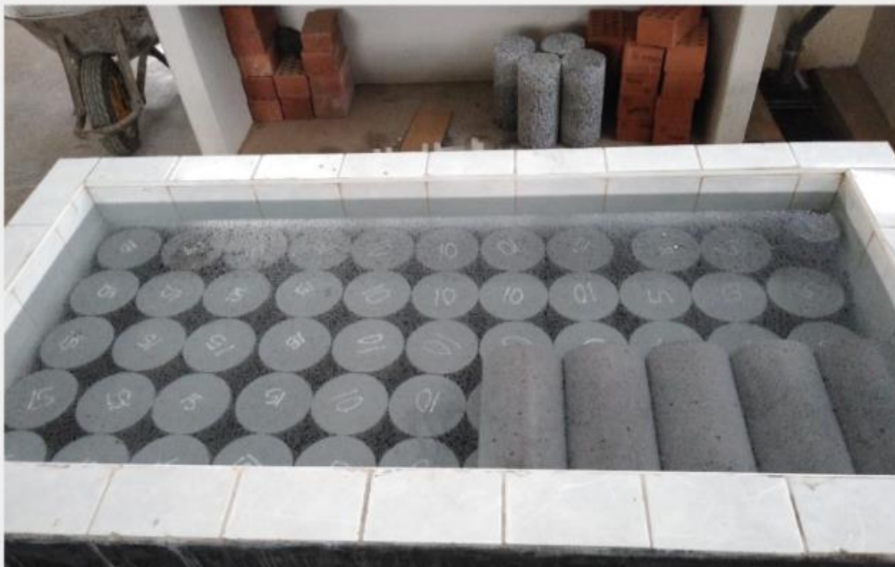
Fotografía 49: Luego de retirarlas se procedió a marcarlas para su posterior identificación.
