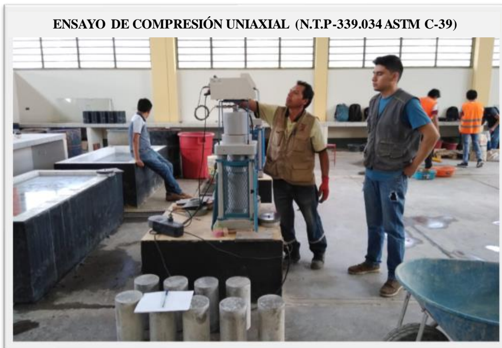
Fotografía 57: Se colocó los cabezales con neopreno a cada extremo de los especímenes, esto con el fin de uniformizar la carga en las superficies de contacto de la probeta.
