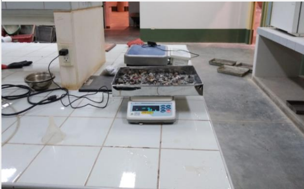
Fotografía 23: Posteriormente se peso la muestra saturada.
