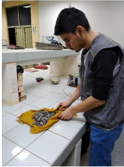
Figura 21: Ensayo de Absorción del Agregado Grueso
