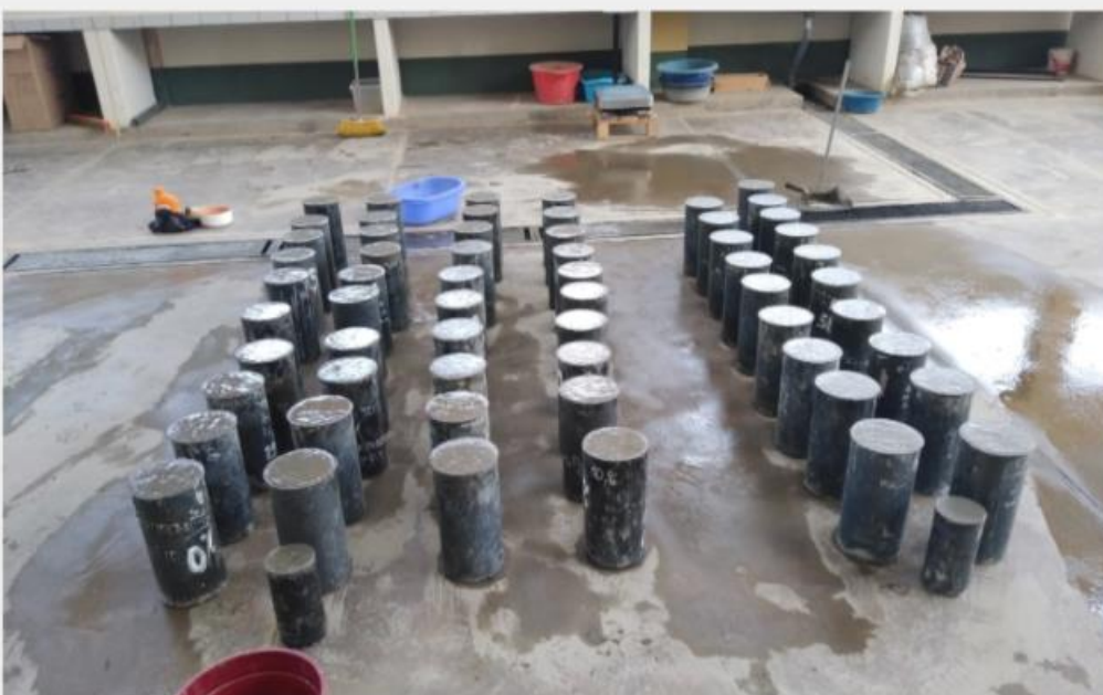
Fotografía 45: Se visualiza el enrase de las probetas, el cual nos permite una superficie nivelada.
