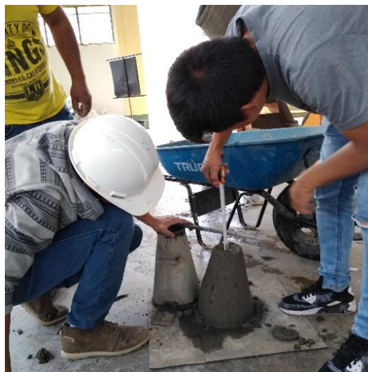
Figura 24: Verificación del SLUMP en la mezcla
