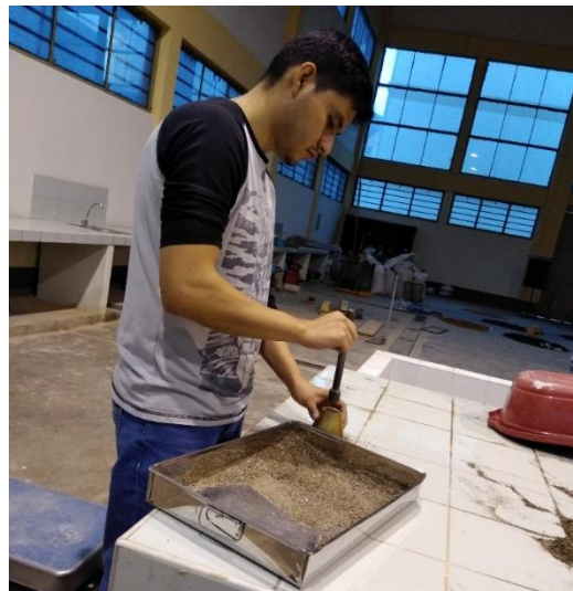
Figura 14: Ensayo de Absorción del Agregado Fino.
