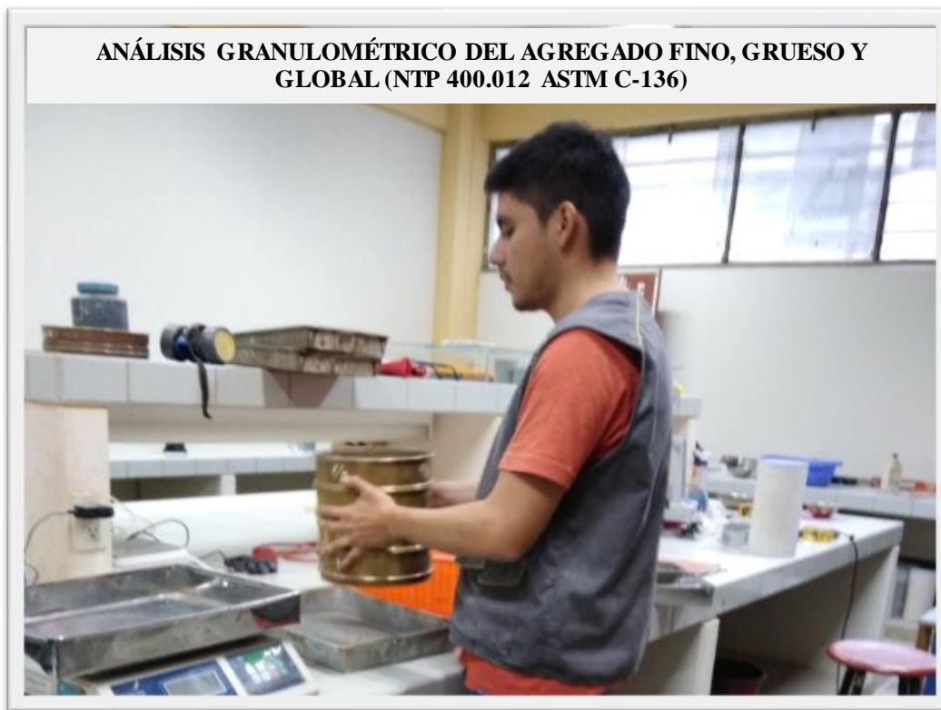
Fotografía 15: Se distingue al tesista realizando el ensayo granulométrico de la muestra de piedra.
