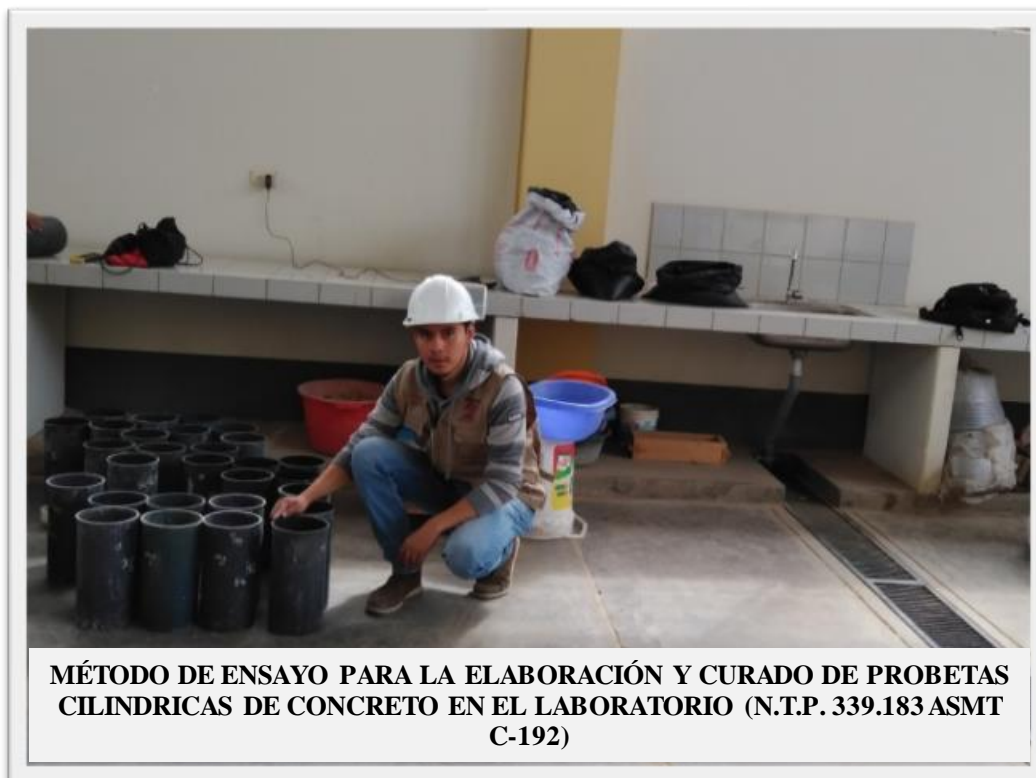
Fotografía 34: Se visualiza los moldes de plástico que usaremos para las probetas.
