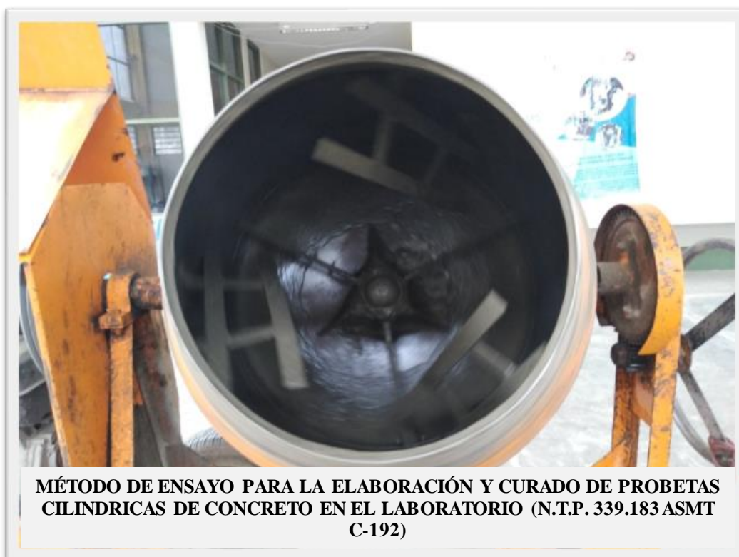
Fotografía 42: Al concluir cada mezcla se procedió al lavado y secado de la mezcladora.
