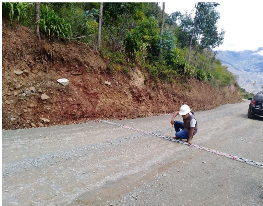
Fotografía 12. Medición del ahuellamiento - Sector III
