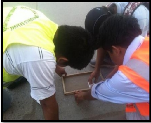
Foto N° 19: Marco mancha de arena
