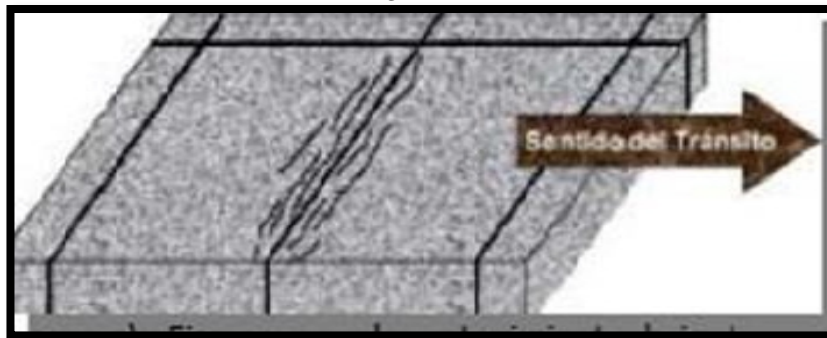
Figura N° 3. Agrietamiento de durabilidad.
