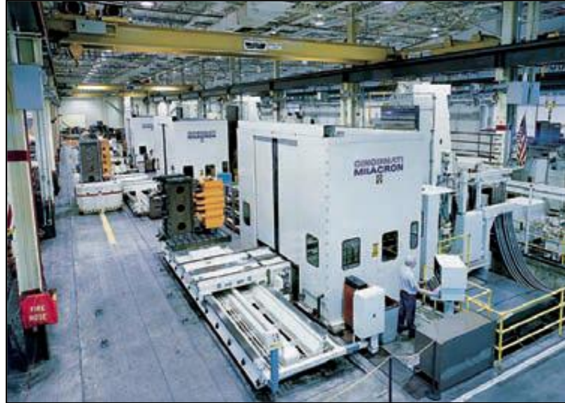
Figura 1. Uno de los cuatro grandes centros de maquinado que forman parte del sistema de producción flexible de la planta de Cincinnati Milacron, en Mt. Orab, Ohio.
