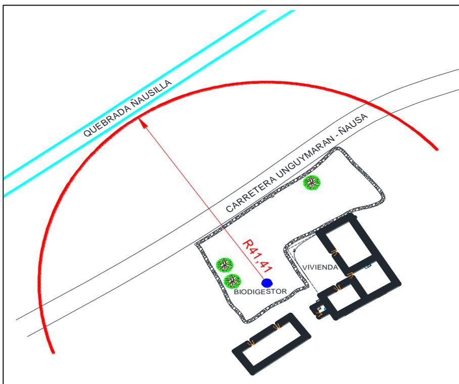
**Figura 34.** Distancia Biodigestor – Corrientes de agua:  $41.41 > 15.00$  m.
