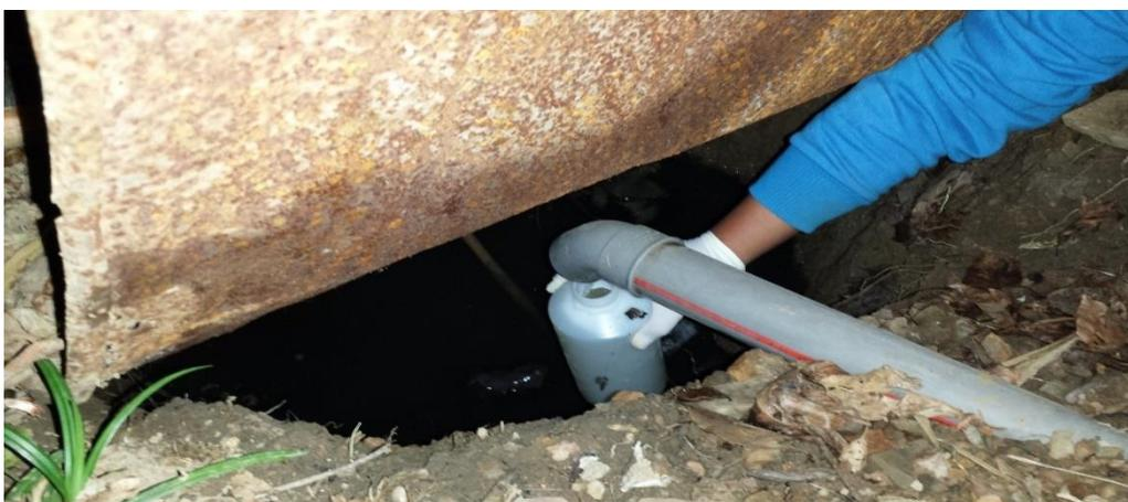
FOTO N° 10: Toma de muestra en el efluente – Pozo de absorción
