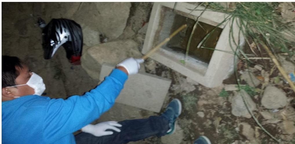
FOTO N° 04: Homogenización de las aguas negras en la caja de inspección
