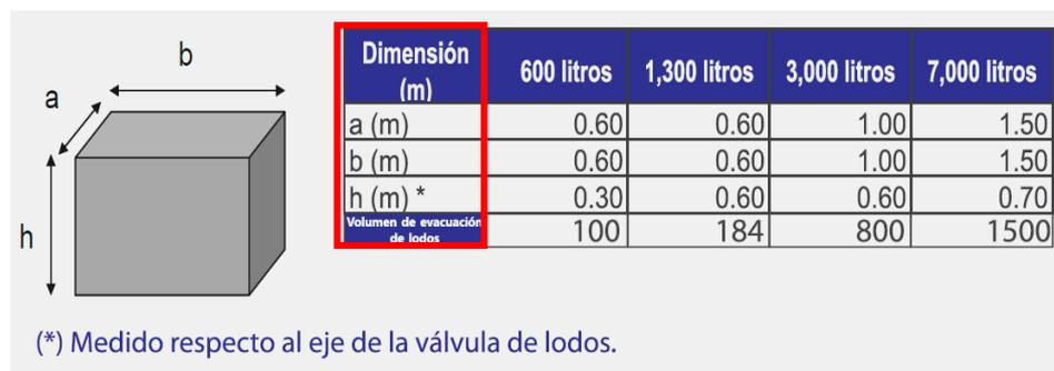
**Figura 55.** Pre dimensionamiento de la caja de lodos
