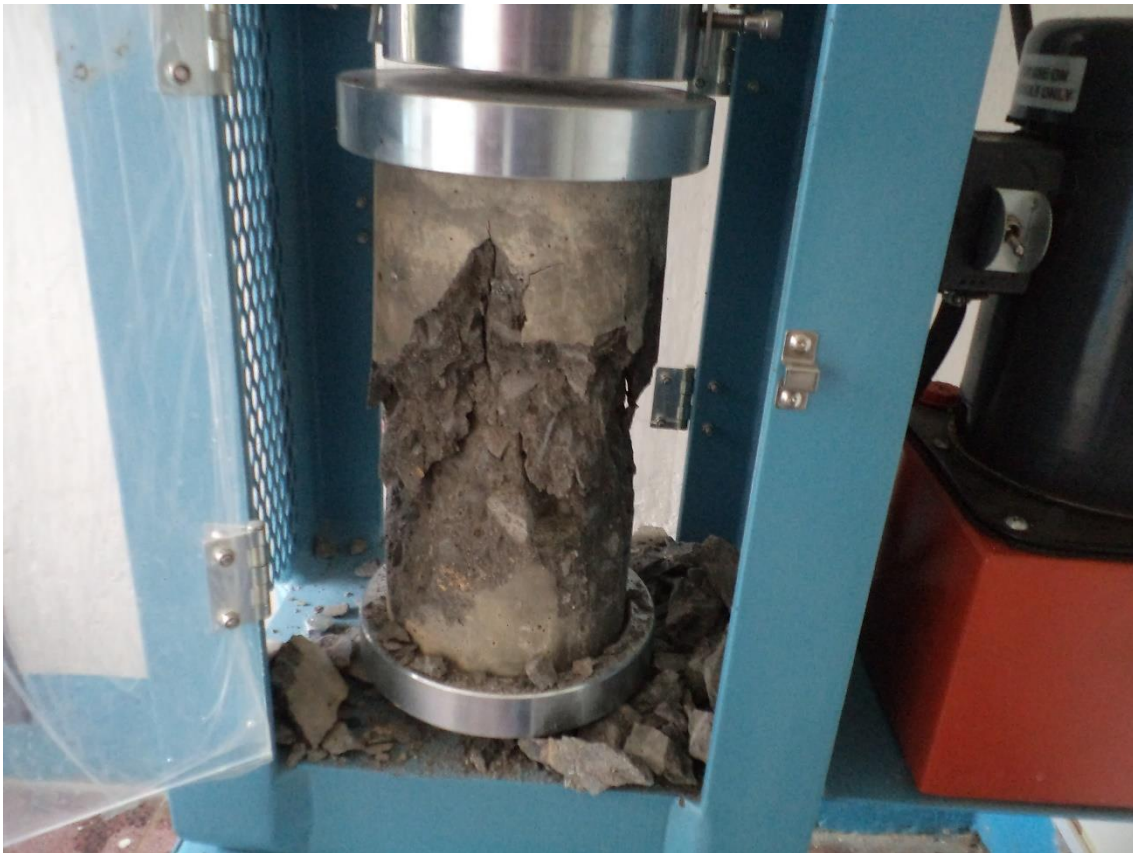
Fotografía N°24: Rotura de la probeta fijada por 2 platos de retención de neopreno
