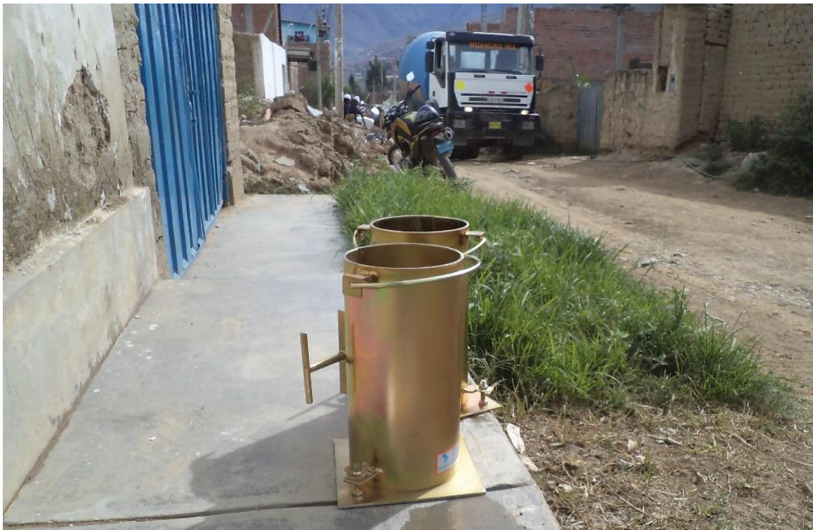
Fotografía N°14: Los moldes cilíndricos 6"x12" para realizar los especímenes de concreto y realizar el ensayo de compresión.
