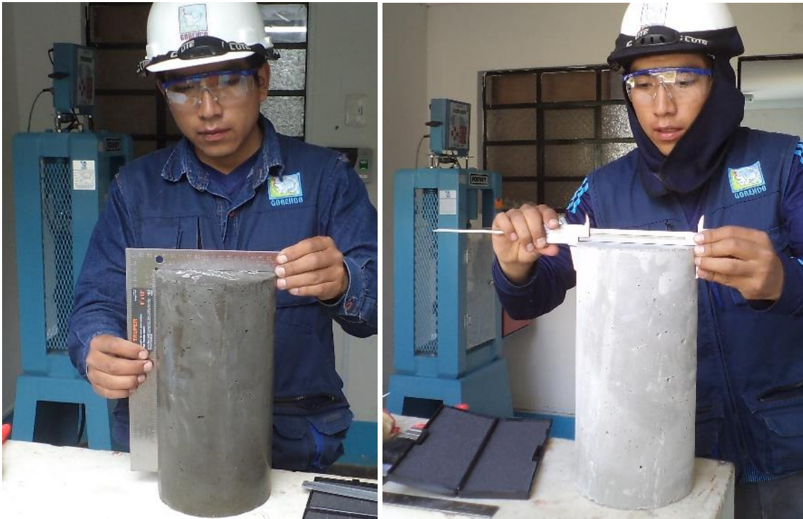
Imagen N° 9: medición de la probeta para realizar el ensayo de resistencia a la compresión
