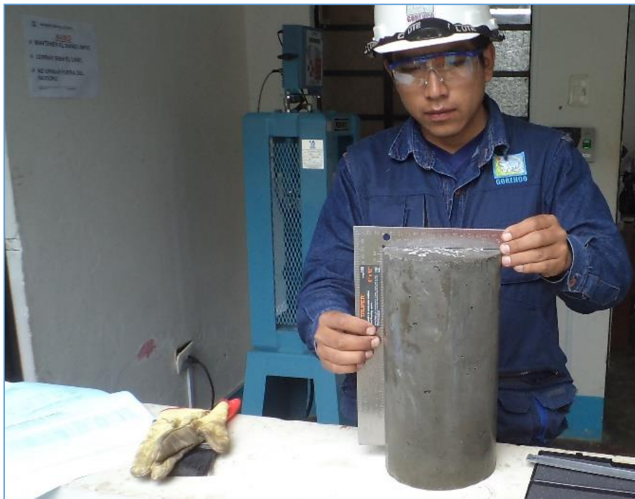
Fotografía N°22: Verificando la perpendicularidad de la probeta con la escuadra
