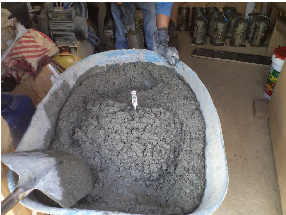
Fotografía N°16: Control de temperatura a la muestra de concreto premezclado.
