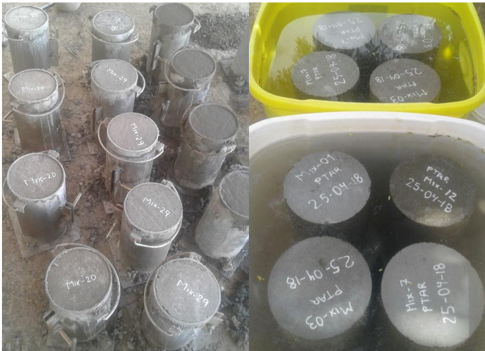
Fotografía N°20: Etiquetado y curado de los especímenes de concreto 6"x12" para realizar el ensayo a compresión.
