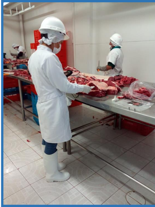
Figura 15. Toma de pH en sala de cortes a las 48 horas (bife angosto), durante proceso.
