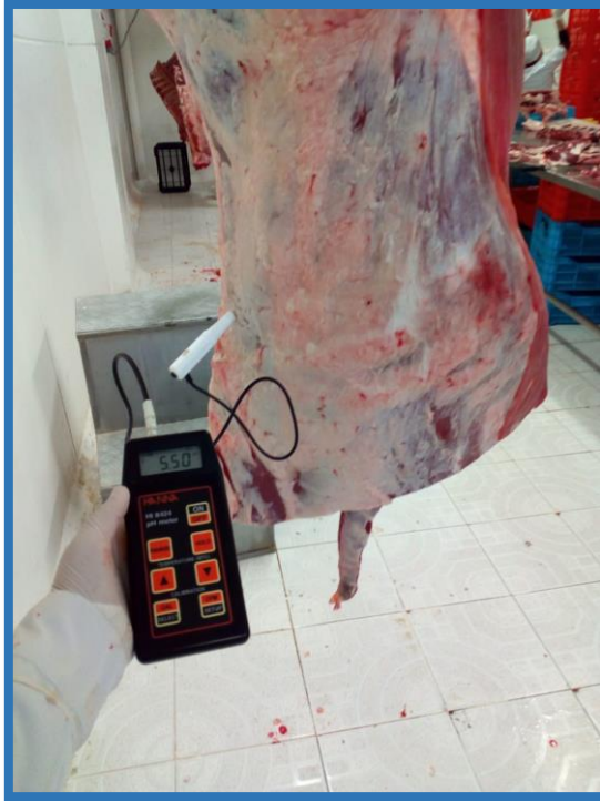
Figura 13. Toma de pH en sala de cortes a las 48 horas.
