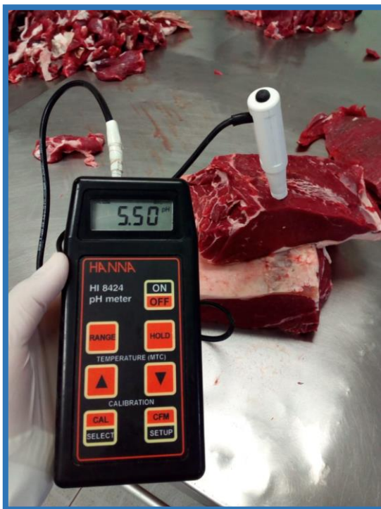
Figura 16. Toma de pH a las 48 horas durante proceso en sala de cortes.
