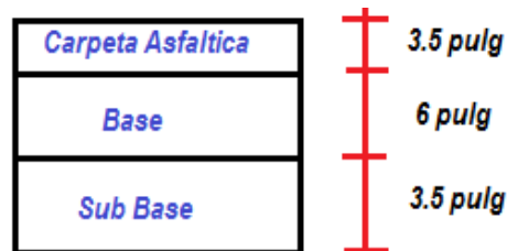
Figura N° 17: Estructura del pavimento flexible – método AASHTO 93
