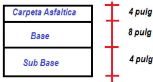
Figura N° 16: Estructura del pavimento flexible – método MTC
