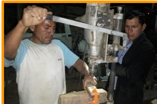
Figura 58. Perforado de la madera para la estructura del eje “X” (taladro de mesa).
