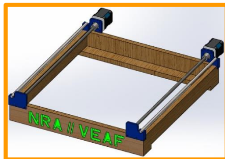
Figura 57: Ensamblaje de la estructura física del eje “Y”.
