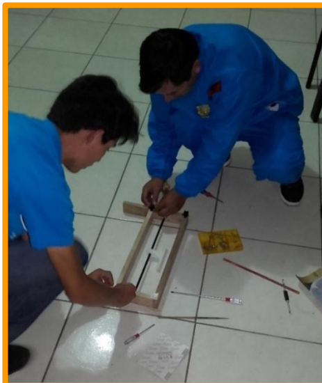
Figura 59. Ensamblado de la estructura de madera del eje “X” con varilla roscada.
