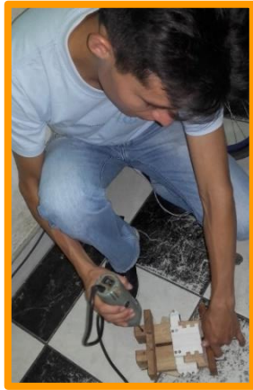
Figura 62. Realizando agujero para asegurar el motor del eje "Z".
