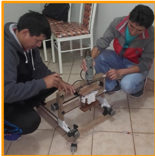
Figura 63. Afirmando la estructura de madera para el eje "Z".
