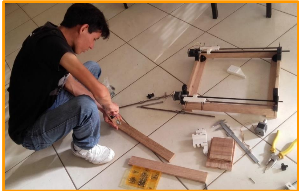
Figura 56: Ensamblado de la estructura física del eje “Y”.
