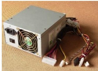
Figura 33: Fuente alimentación 12V de 25A.
