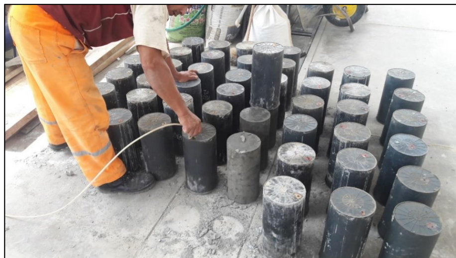
Figura N° 37 Desmoldado de los especímenes.
