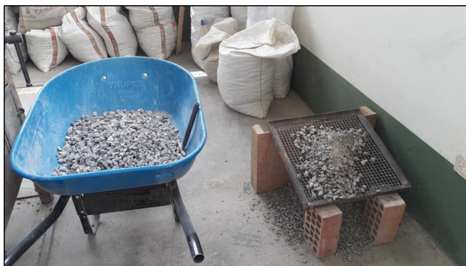
Figura N° 12 Separación mediante tamizado de agregados gruesos reciclados.
