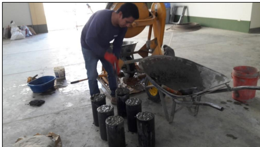
Figura N° 34 Consolidación por varillado de los especímenes.
