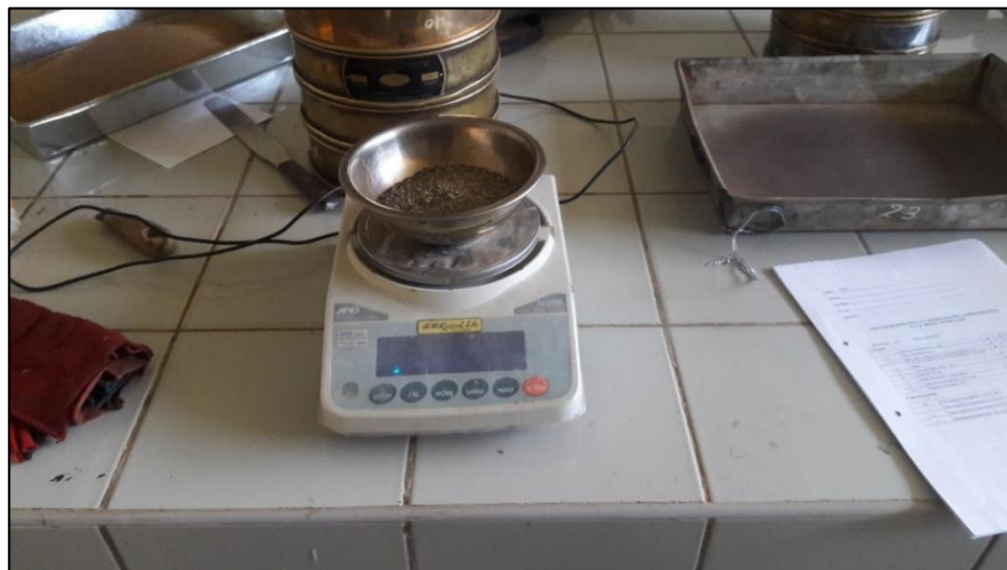
Figura N° 21 Pesado de la muestra final durante el ensayo de grav. específica
