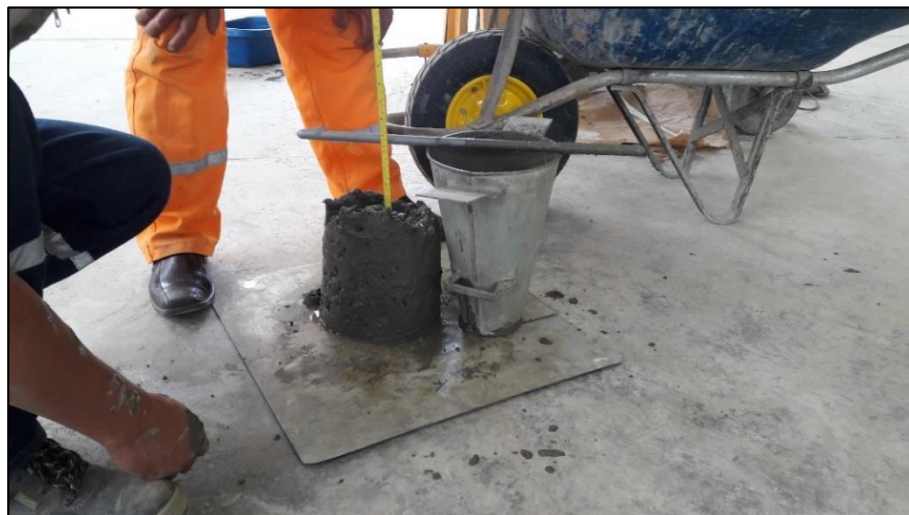
Figura N° 40 Medida de asentamiento durante ensayo en concreto fresco 1.
