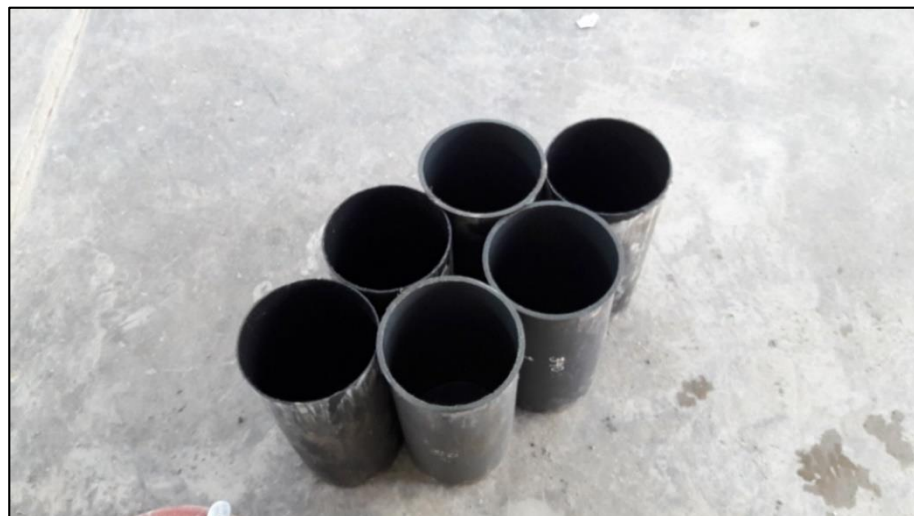
Figura N° 29 Moldes para especímenes de concreto.
