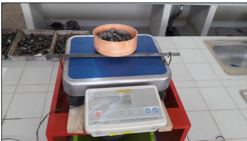
Figura N° 22 Pesaje de muestra en el estado S.S.S. durante ensayo de peso específico y absorción de los agregados gruesos.
