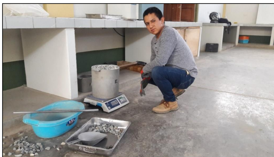
Figura N° 17 Ensayo de Peso Unitario
