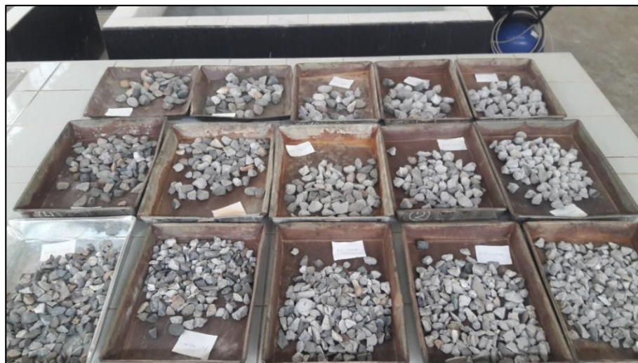
Figura N° 24 Secado de las muestras a temperatura ambiente, ensayo de peso específico y absorción de los agregados gruesos.
