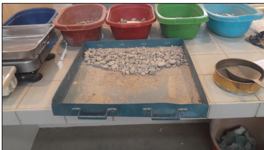
Figura N° 27 Descarga de muestra y tamizado durante ensayo de Abrasión Los Ángeles
