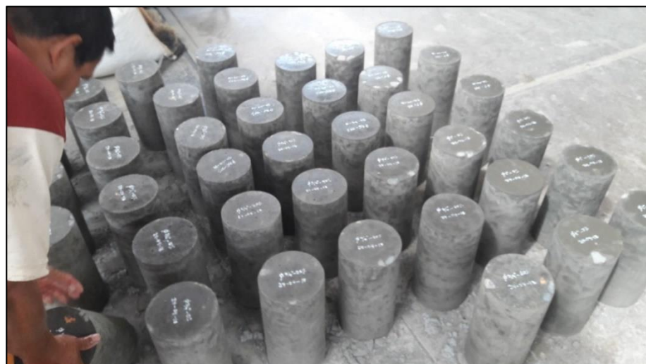
Figura N° 38 Especímenes desmoldados y rotulados.
