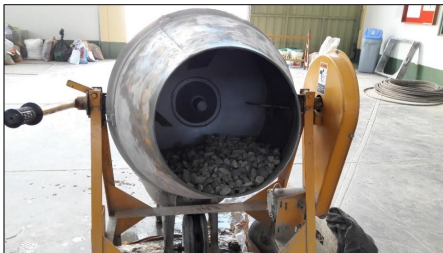
Figura N° 31 Mezclado con máquina.
