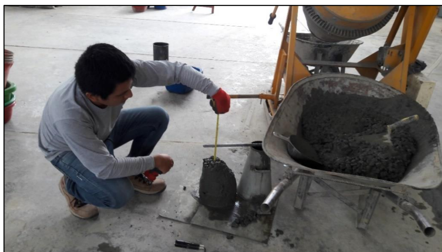
Figura N° 41 Medida de asentamiento durante ensayo en concreto fresco 2.
