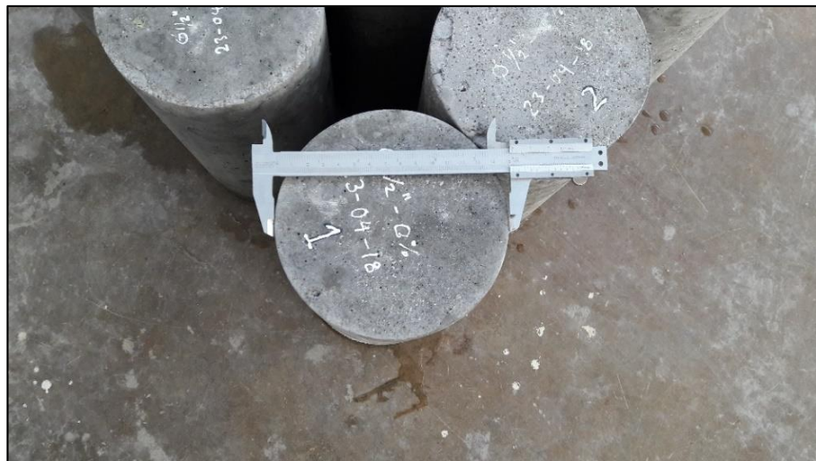
Figura N° 43 Registro de medidas de los especímenes.
