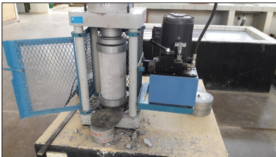
Figura N° 45 Colocado de especímenes en la máquina de ensayo.
