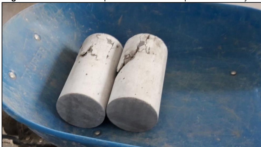
Figura N° 49 Patrones de tipos de fracturas en especímenes ensayados 2.
