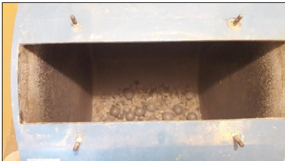
Figura N° 26 Colocación de muestra y carga abrasiva en la maquina Los Ángeles
