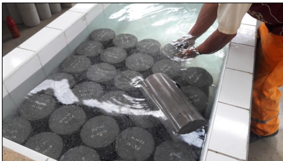
Figura N° 39 Curado de los especímenes.
