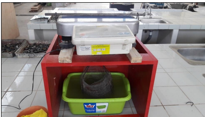
Figura N° 23 Pesaje de muestra sumergida en agua, ensayo de peso específico y absorción de los agregados gruesos.
