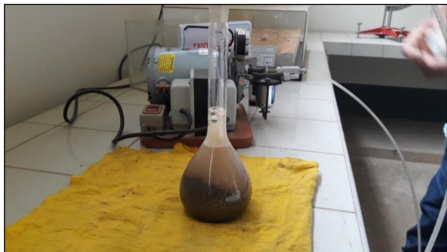
Figura N° 20 Extracción de aire del matraz durante el ensayo de gravedad esp.
