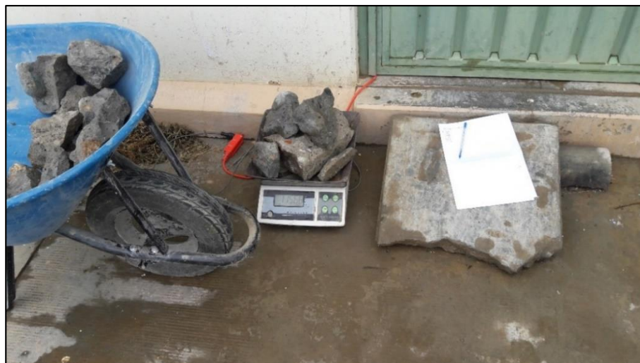
Figura N° 08 Pesado de bloques de concreto.
