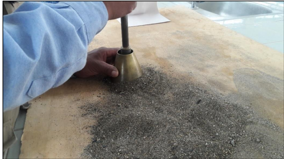
Figura N° 19 Prueba del cono durante el ensayo de gravedad específica.
