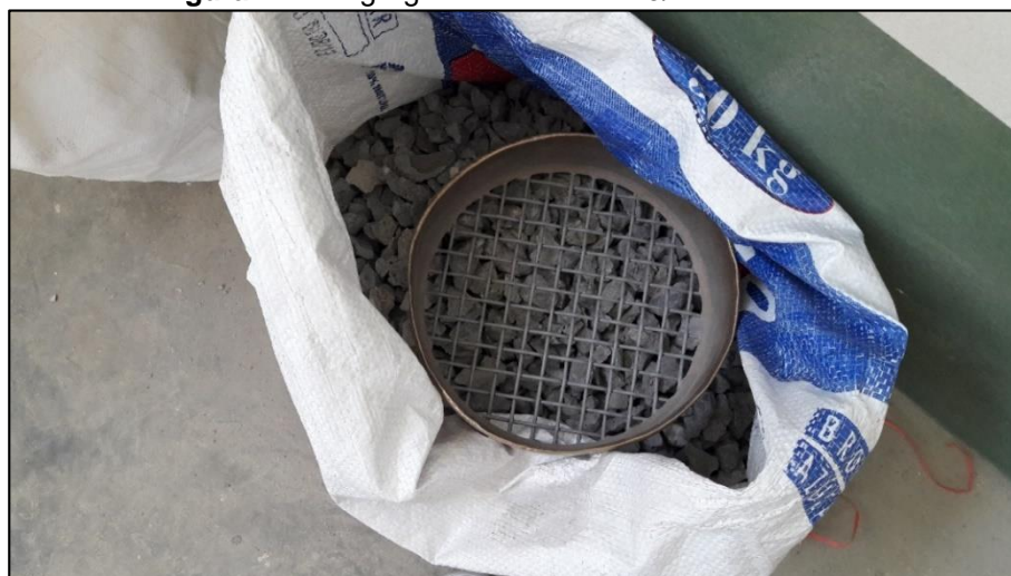
Figura N° 15 Agregado reciclado de 1/2" almacenado.
