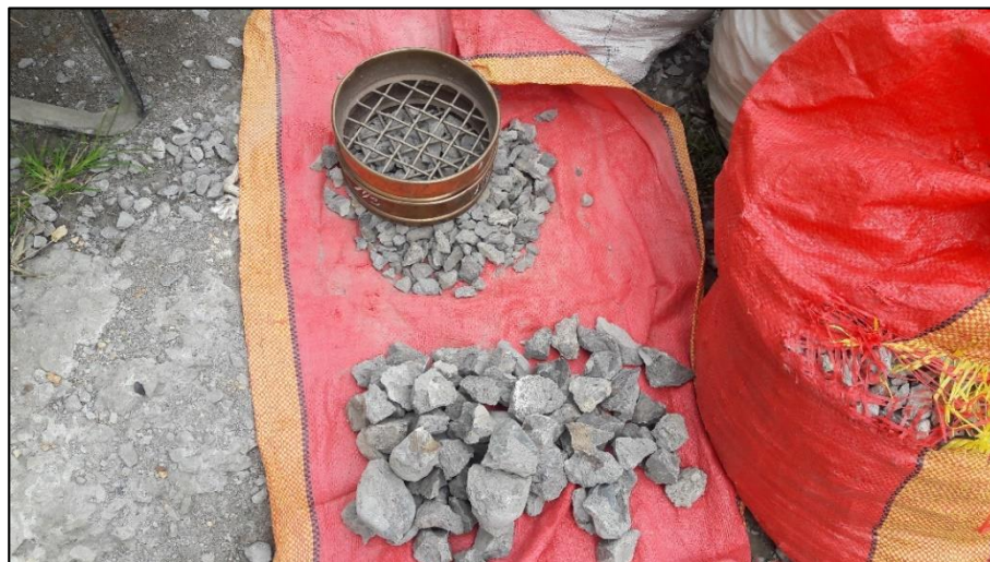
Figura N° 11 Separación mediante tamizado de agregados gruesos reciclados.
