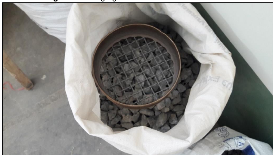
Figura N° 14 Agregado reciclado de 3/4" almacenado.
