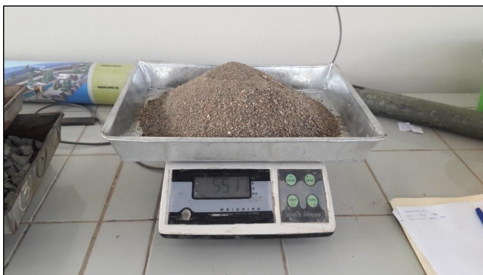
Figura N° 16 Ensayo de Contenido de humedad
