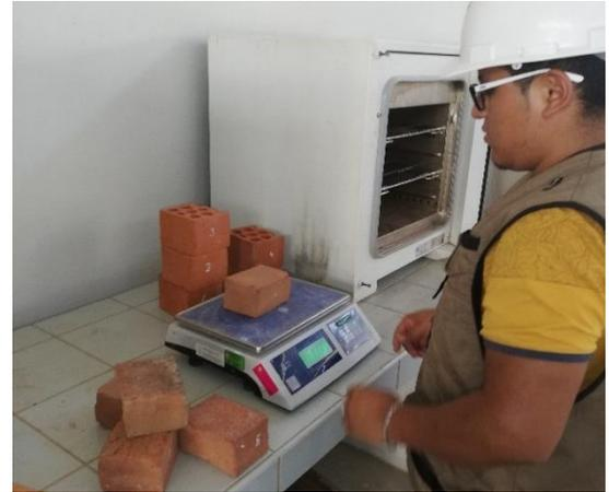
Foto 20. Peso de unidades secas previamente extraídas del horno de secado
