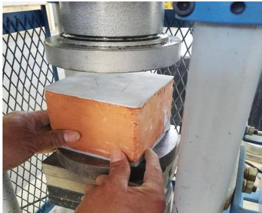
Foto 9. Colocación de la Muestra
