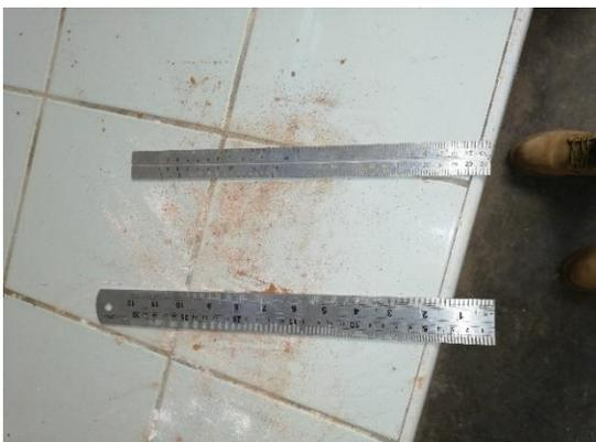
Foto 23. Reglas metálicas utilizadas para determinar el alabeo de las unidades.
