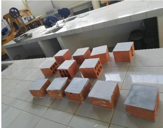
Foto 7. Muestras para compresión refrenadas con yeso .
