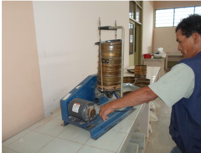
Foto Nr. 4. Análisis Granulométrico por tamizado
