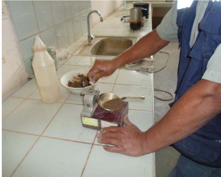
Foto Nr. 6. Ensayo de límite Líquido, golpeando la copa
