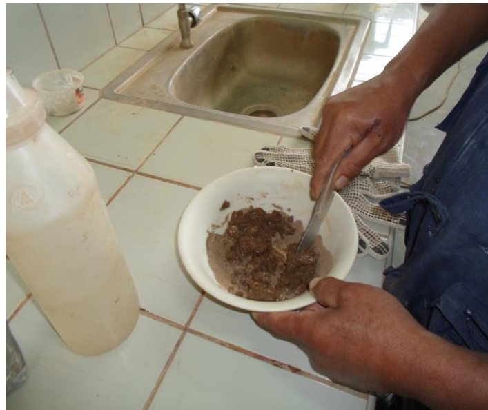
Foto Nr. 5. Ensayo de límite Líquido, amizado
