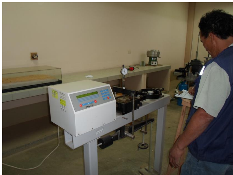
Foto Nr. 8. Ensayo de Corte Directo, corte de la muestra
