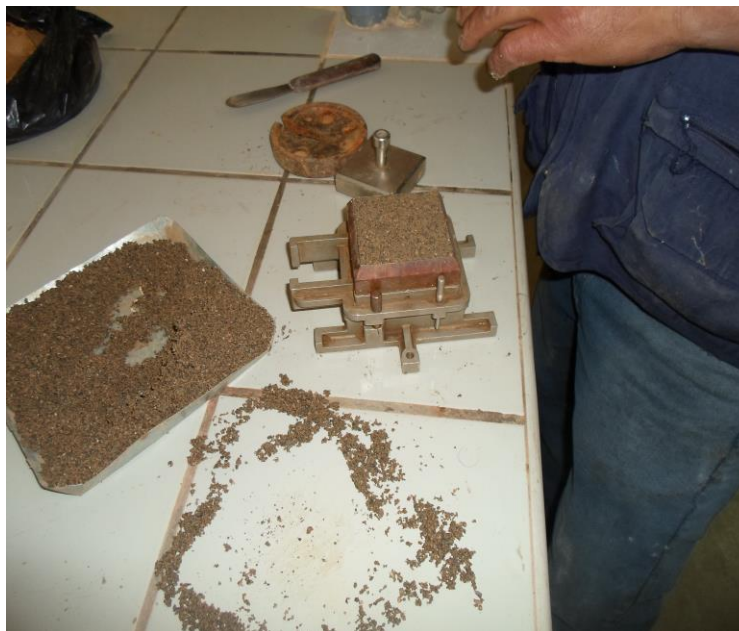
Foto Nr. 7. Ensayo de Corte Directo, moldeo
