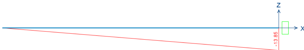
Figura 87. DIAGRAMA DE FUERZAS CORTANTES PARA DISEÑO DE REFUERZO INFERIOR
