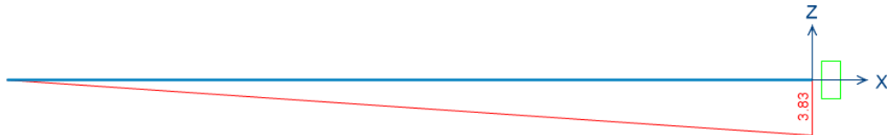
Figura 86. MOMENTO FLECTOR PARA DISEÑO DE REFUERZO INFERIOR
