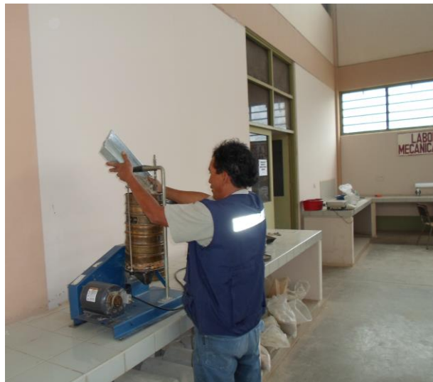
Foto Nr. 3. Análisis Granulométrico por tamizado
