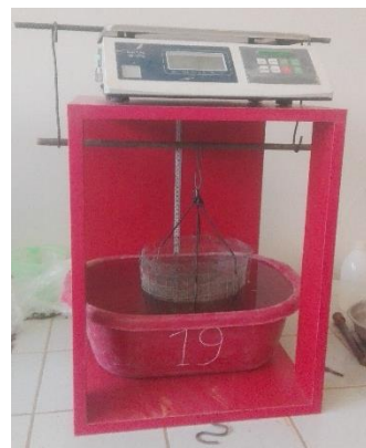
Figura 16. Foto del instrumento para la determinación del peso específico sumergido. Elaboración propia.
