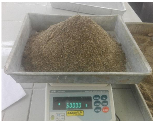
Figura 3. Foto del agregado fino, que pasa la malla 3/8" y queda retenido en la N° 200. Elaboración propia.
