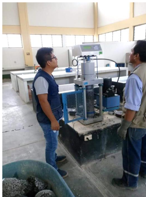
Figura 46. Foto de la rotura de probetas de concreto permeable. Elaboración Propia.
