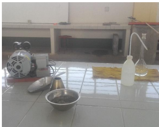
Figura 15. Foto de los materiales para la determinación del peso específico y absorción del agregado fino. Elaboración propia.
