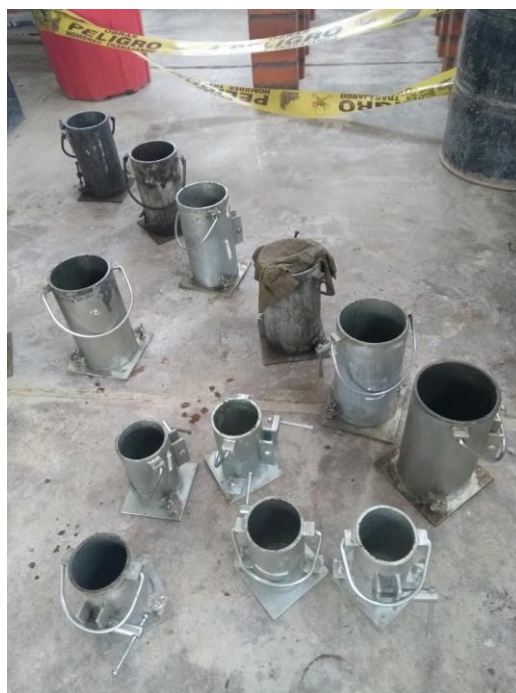
Figura 23. Foto de los moldes de Probeta Metálico, de 6"x12" y 4"x8". Elaboración propia.
