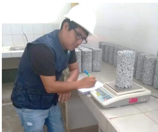
Figura 51. Foto de la lectura de los pesos secos de las muestras. Elaboración propia.
