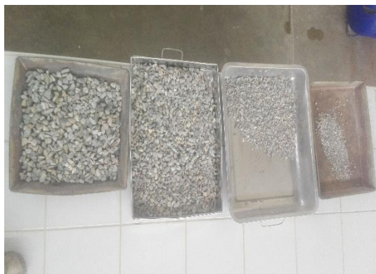
Figura 11. Foto de la distribución de tamaños del agregado grueso. Elaboración propia.
