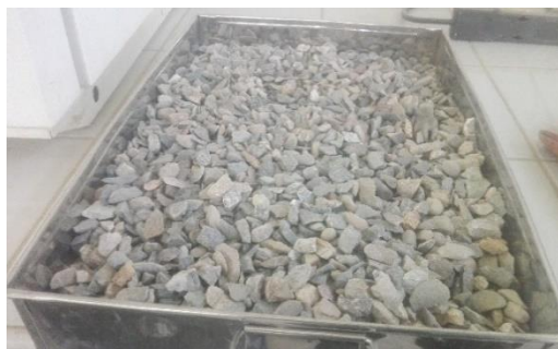
Figura 5. Foto de la piedra chancada de Huso N°8, recomendada por el ACI522R-10 para la fabricación de concreto permeable. Elaboración propia.
