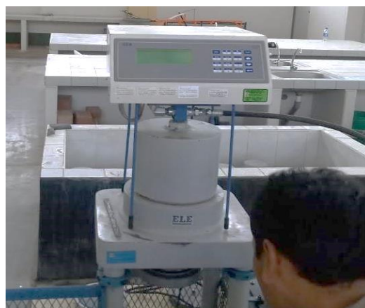
Figura 2. Foto de la prensa de compresión, permite medir la resistencia a la compresión de un material. Elaboración propia.
