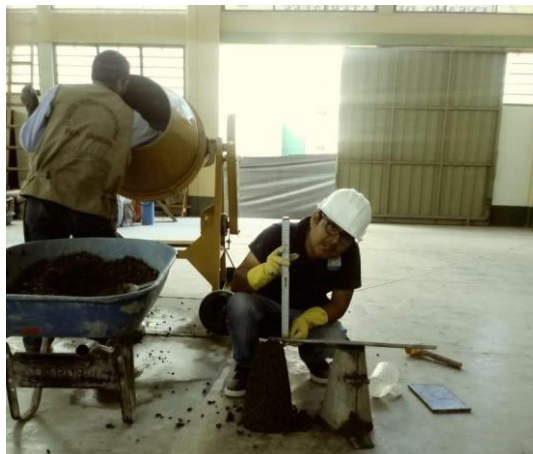
Figura 37. Foto de la medida del Slump del concreto fresco. Elaboración propia
