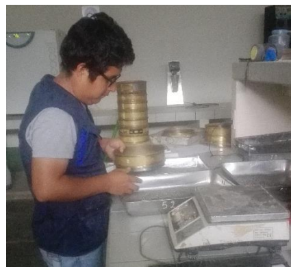
Figura 12. Foto del proceso de pesado de los granos retenidos en cada tamiz. Elaboración propia.
