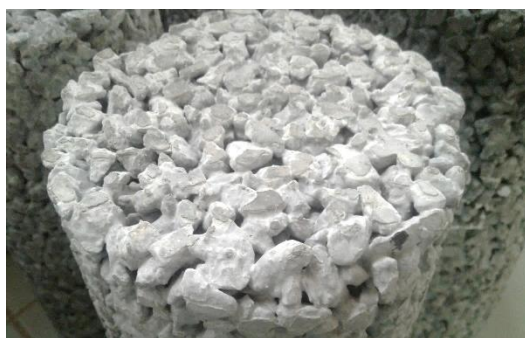
Figura 43. Foto de la apariencia final del concreto permeable. Elaboración propia.
