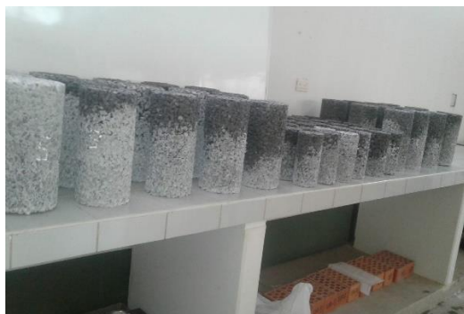
Figura 41. Foto del secado de probetas antes del refrentado. Elaboración propia.
