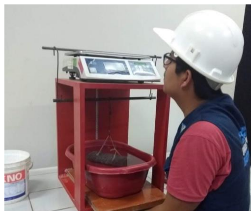
Figura 52. Foto de la lectura de los pesos sumergidos de las muestras. Elaboración propia.
