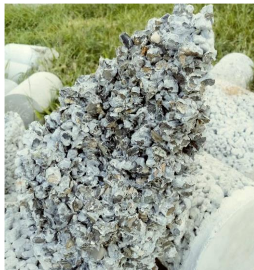
Figura 48. Foto de la estructura interna del concreto permeable. Elaboración propia.
