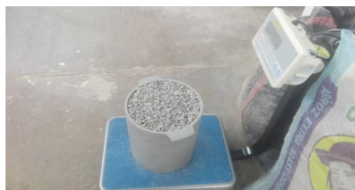
Figura 8. Foto de la balanza con aproximación de 0.05kg y que permite leer con una exactitud de 0.1% del peso de la muestra. Elaboración propia.
