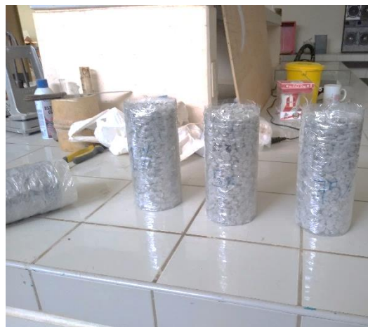
Figura 50. Foto de las muestras de probeta habilitada de 4"x8". Elaboración propia.
