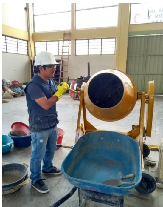
Figura 22. Foto de la mezcladora de Concreto, de 1pie 3 de capacidad. Elaboración propia.
