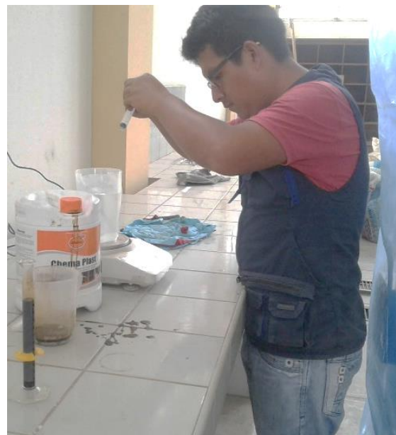
Figura 21. Foto de la medición de la Dosis del Aditivo plastificante
