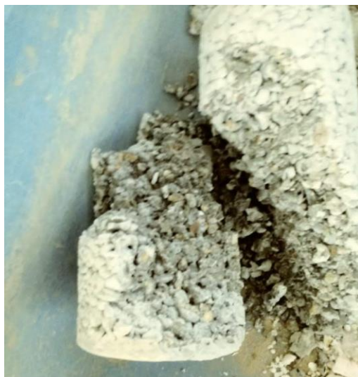
Figura 47. Foto de probeta con falla Tipo 4. Elaboración propia.
