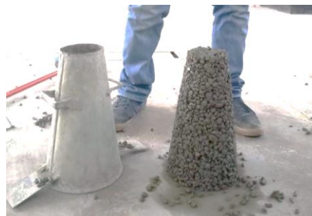
Figura 6. Foto del Revenimiento o Slump del concreto permeable, de acuerdo al ACI 211.3R-02 le corresponde un Slump igual a cero. Elaboración propia.
