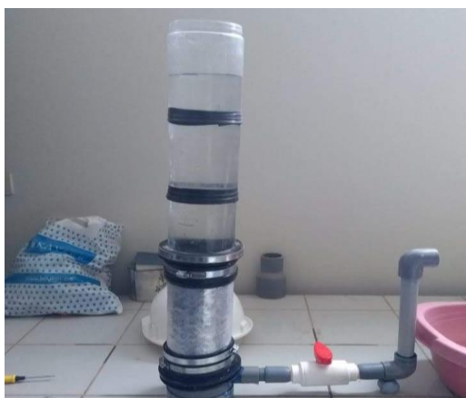
Figura 1. Foto del permeámetro de carga variable, permite medir la permeabilidad del concreto poroso. Elaboración propia.
