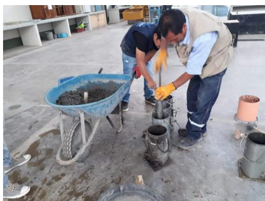
Figura 28. Foto del compactado del Concreto. Elaboración propia.
