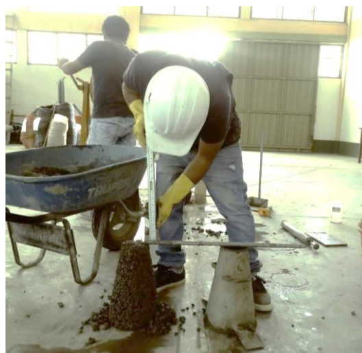
Figura 27. Foto de la medición del Slump del Concreto. Elaboración propia.
