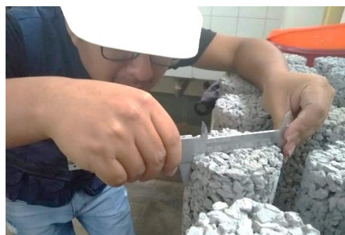
Figura 44. Foto de la toma de medida de las probetas. Elaboración propia.
