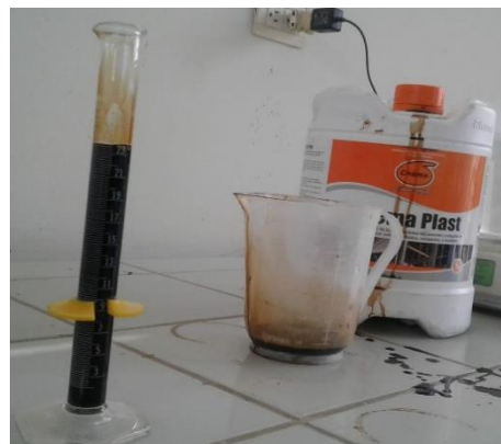
Figura 4. Foto del aditivo plastificante, reductor de agua hasta un 10%. Elaboración propia.
