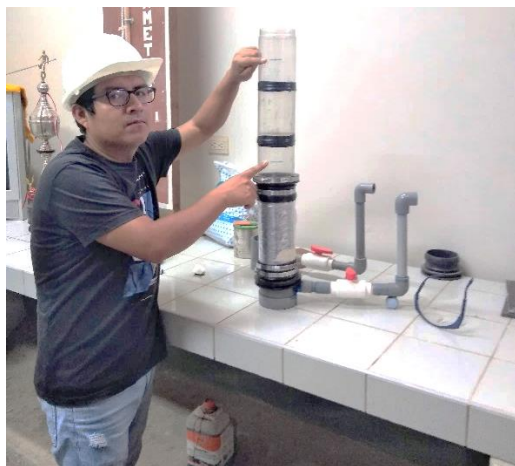
Figura 49. Foto del permeámetro de carga variable, se indica el nivel superior( h_2 ) e inferior ( h_1 ) marcado en la tubería de acrílico. Elaboración propia.
