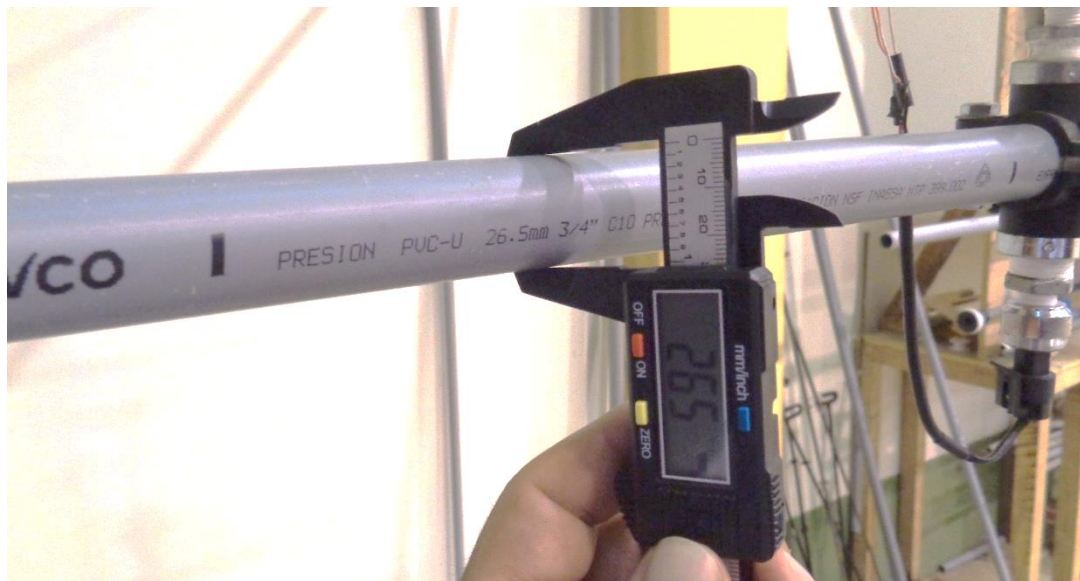
Fotografía 12. Verificación del Diámetro Externo de la Tubería PVC-U Ø 3/4".
