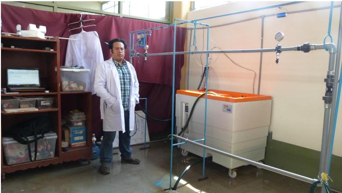
Fotografía 5. Banco de Ensayos para Determinar el Coeficiente de Fricción (f). Fuente: Propia.
