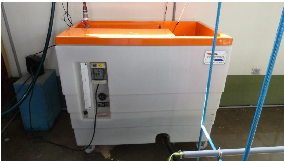
Fotografía 4. Banco Hidráulico Modelo F1-10 – ARMFIELD.
