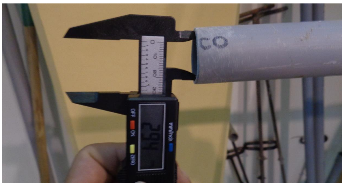
Fotografía 17. Verificación del Diámetro Interno de la Tubería. PVC-U Ø 1”.
