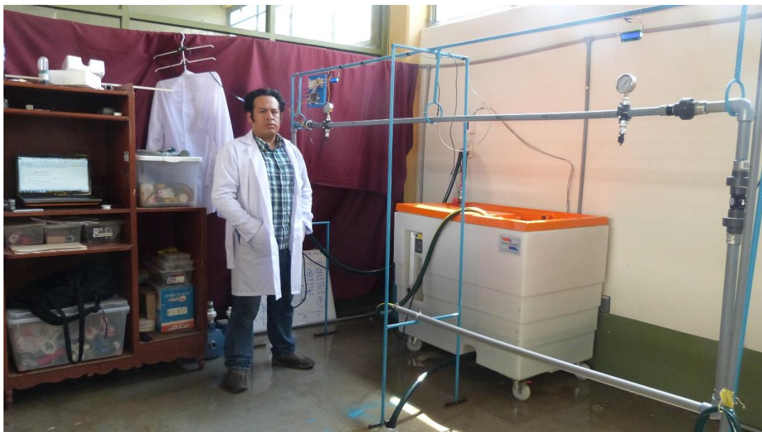
Fotografía 21. Banco de Ensayos F10 Armfield para determinar el coeficiente de fricción “ f ”.
