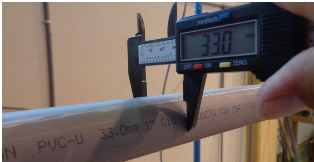
Fotografía 16. Verificación del Diámetro Externo de la Tubería PVC-U Ø 1”.
