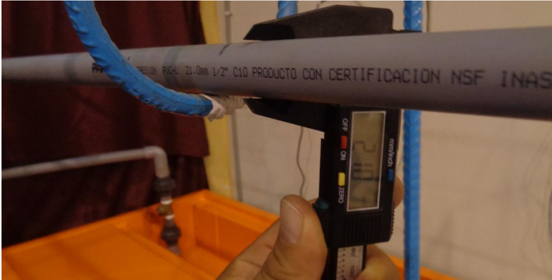
Fotografía 8. Verificación del Diámetro Externo de la Tubería PVC-U Ø 1/2".
