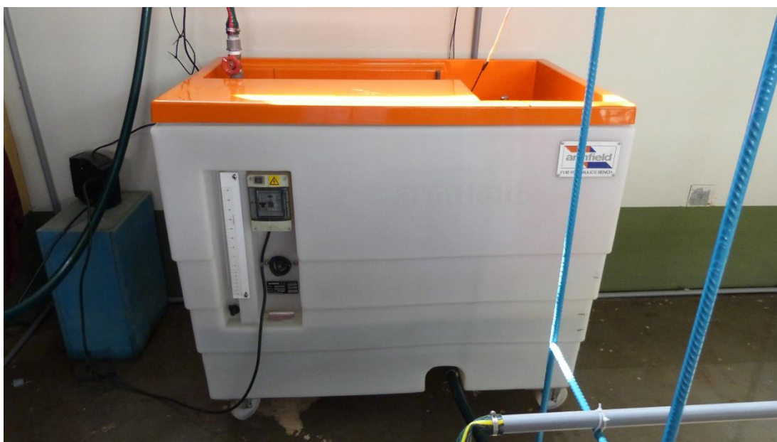
Fotografía 20. Banco Hidráulico Modelo F1-10 – ARMFIELD.
