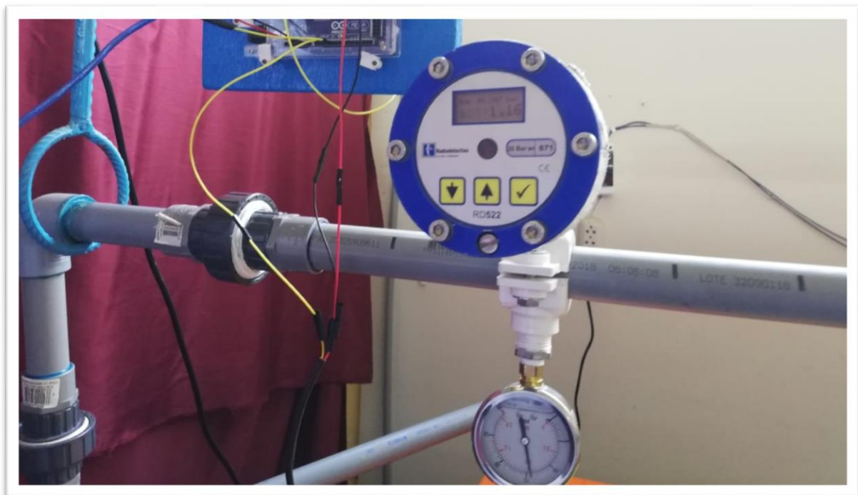
Fotografía A-4. Control de presión del sensor de presión RD522 y el manómetro analógico.
