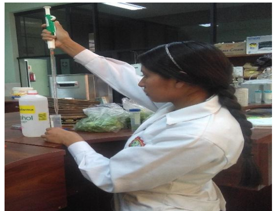
FIGURA 60: Adición de alcohol en la muestra triturada.
