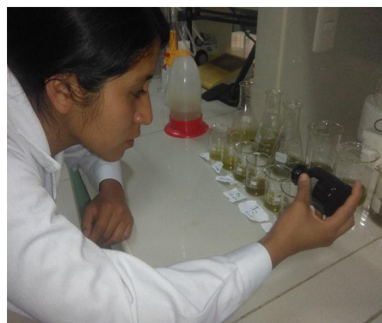
FIGURA 42: Aplicación de la fenolftaleína en las soluciones de las muestras para la determinación de acidez.
