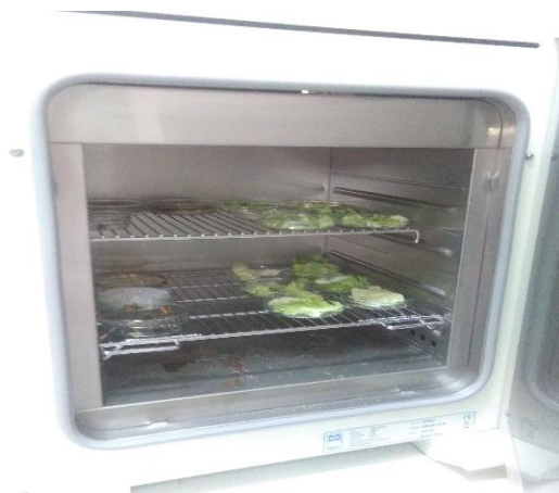
FIGURA 44: Colocación de las muestras en la estufa.
