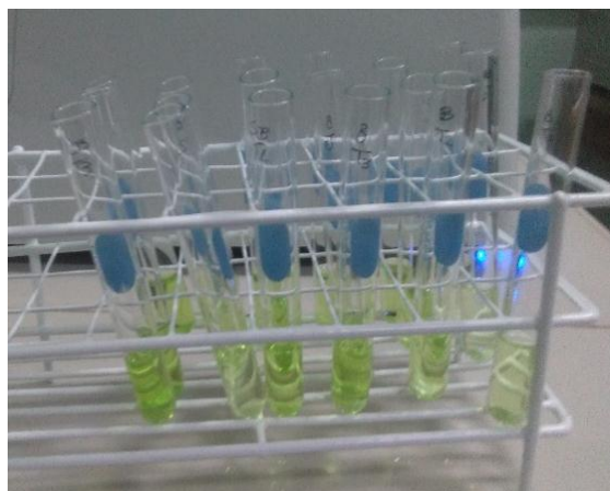
FIGURA 71: Soluciones con las concentraciones de clorofila.
