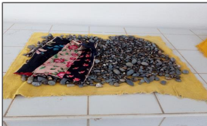
Fotografía 3. Muestra saturada superficialmente seca Fuente: Elaboración propia
