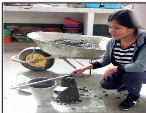
Fotografía 13. Prueba de Revenimiento o slump en concreto poroso Fuente: Elaboración propia
