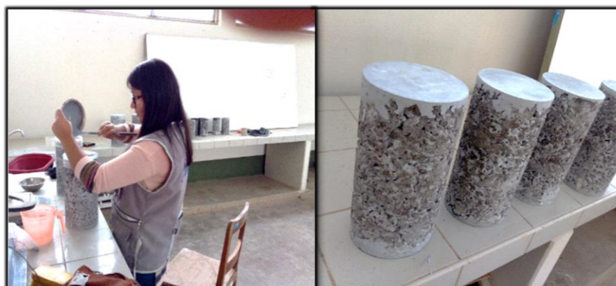
Fotografía 12. Capping de probetas Fuente: Elaboración propia
