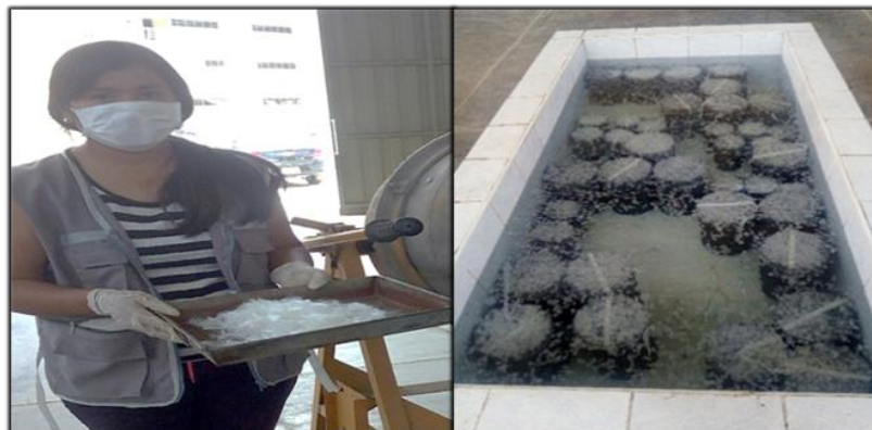
Fotografía 11. Adición de fibra sintética y curado de probetas Fuente: Elaboración propia
