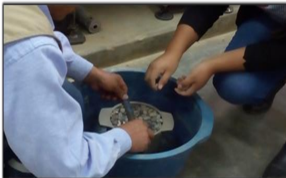
Fotografía 1: Ensayo del peso unitario Fuente: Elaboración propia
