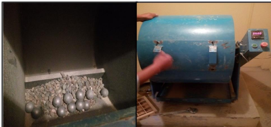
Fotografía 6. Ensayo de abrasión de los ángeles Fuente: Elaboración propia
