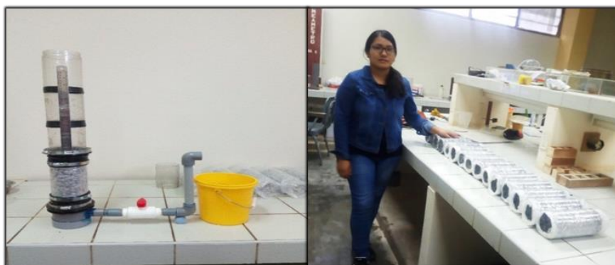
Fotografía 16. Permeámetro casero construido de acuerdo al ACI 522-10R Fuente: Elaboración propia
