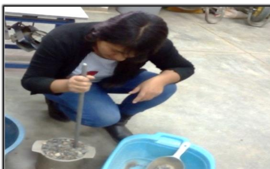
Fotografía 2. Ensayo de peso unitario Varillado Fuente: Elaboración propia
