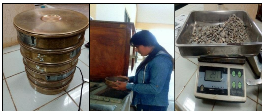
Fotografía 5. Ensayo granulométrico de agregados de la cantera
