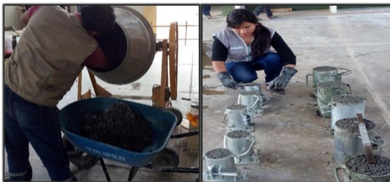
Fotografía 10. Elaboración del concreto poroso
