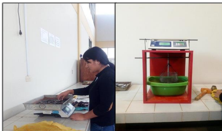
Fotografía 4. Ensayo del peso específico y Absorción Fuente: Elaboración propia
