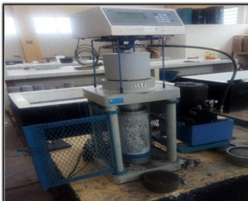
Fotografía 14. Colocación de Probetas para ensayo a compresión
