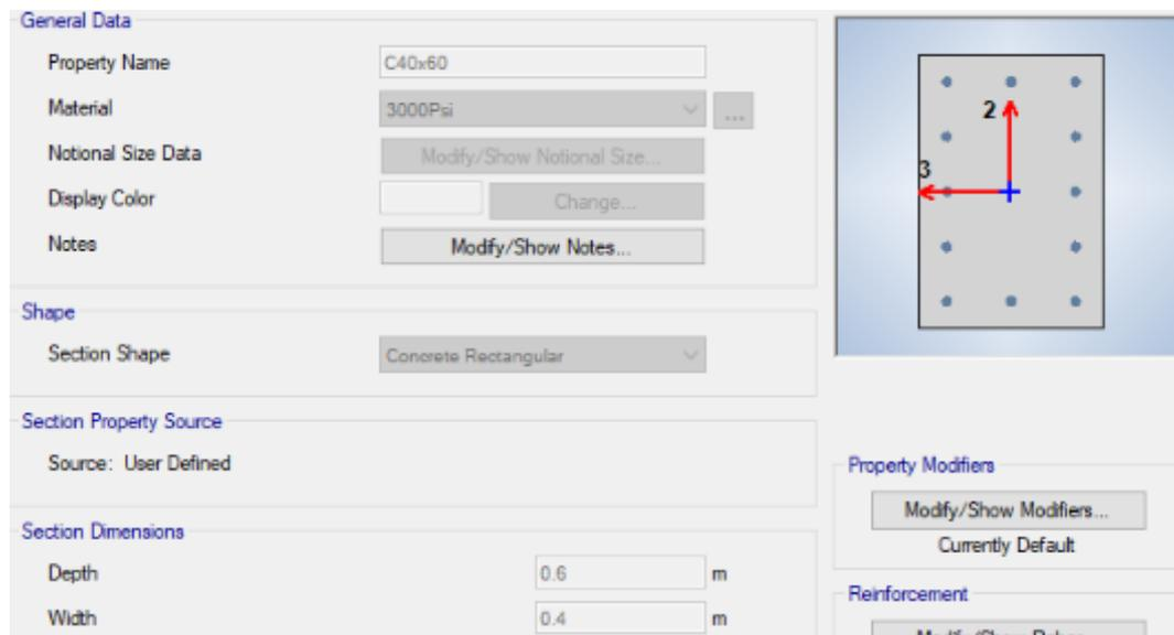
Figura 3-4: Sección transversal típica de las columnas existentes en la estructura analizada.
