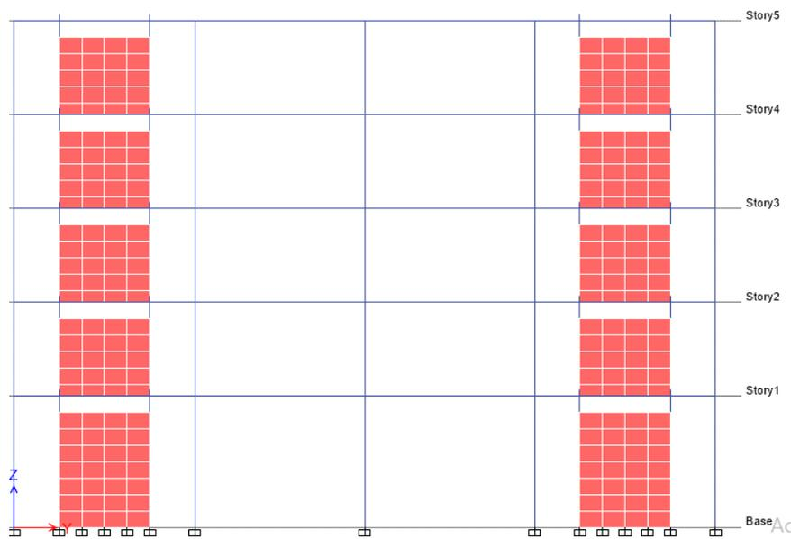
Figura 3-37: Ubicación de los Dispositivos en los Pórticos 1 y 6, Eje X-X.
