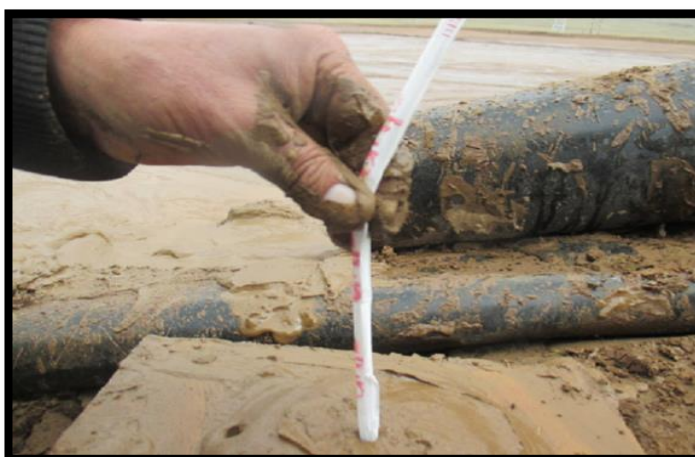
Figura 13. Muestra el proceso de medida para lograr la altura de abatimiento
