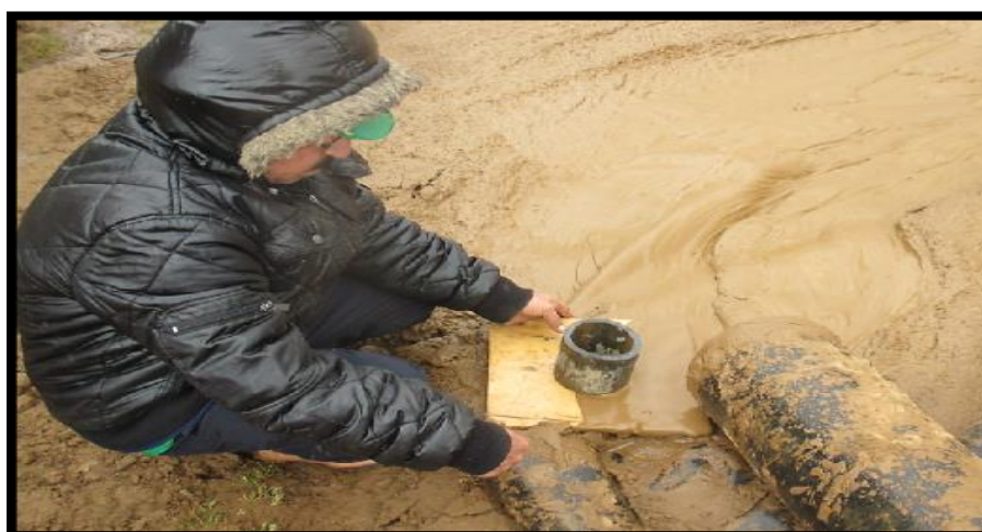
Figura 11. Muestra al Investigador, realizando en forma práctica, el Procedimiento de la Normativa Brasileña ABNT–NBR NM 67 (1998)
