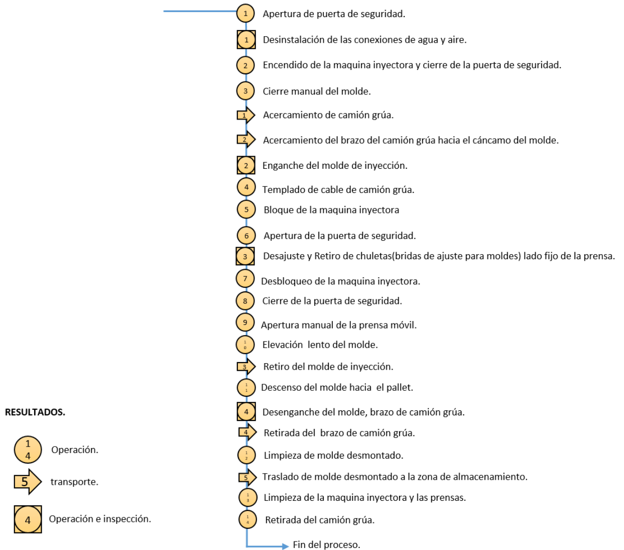
FIGURA N° 08 PROCESO DE DESMONTAJE.
