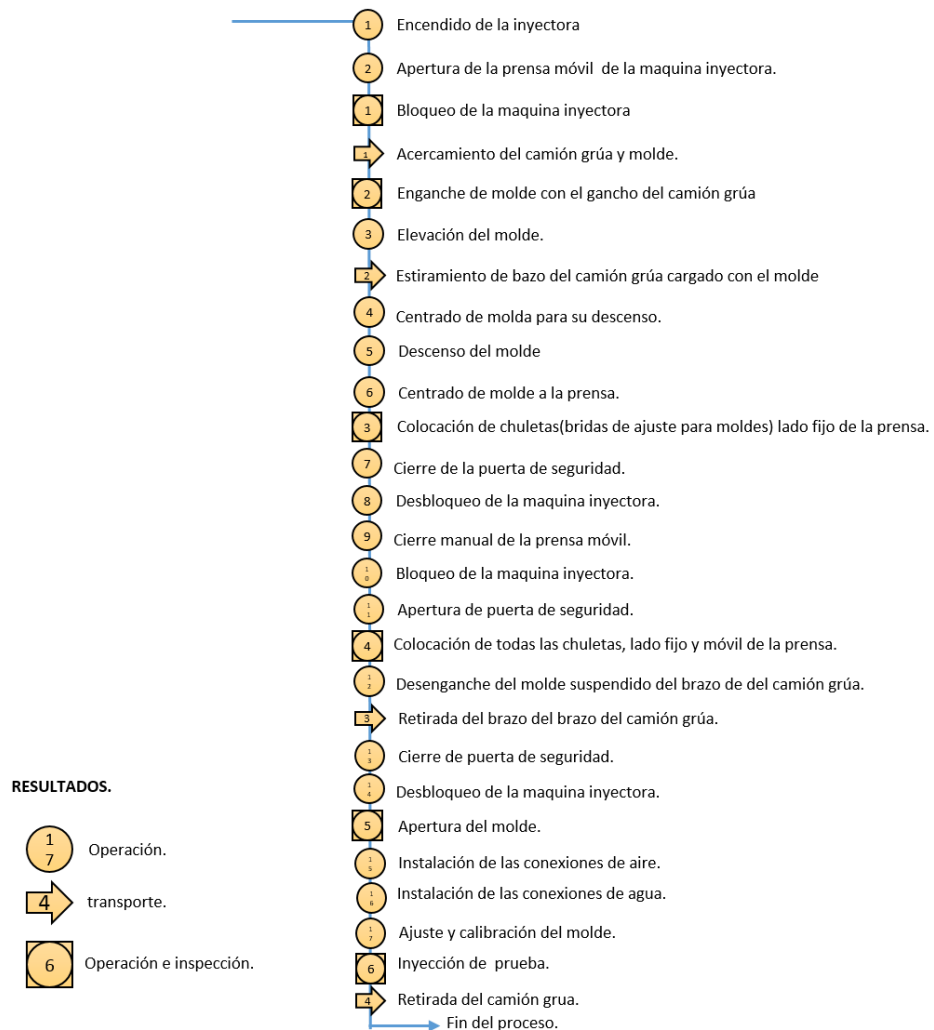
FIGURA N° 07 PROCESO DE MONTAJE.
