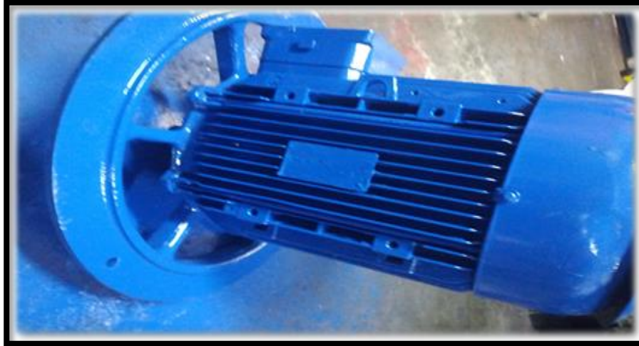
Figura 6: Motor de succión de la máquina de hilado- Continua
