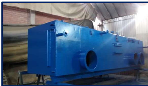
Gráfico 24: Aplicación de la segunda capa Fuente: Elaboración propia
