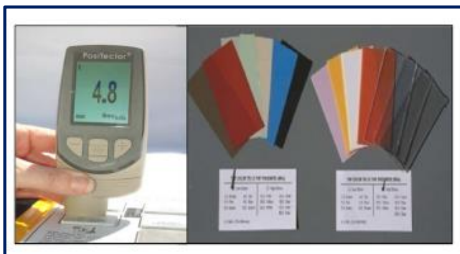
Gráfico 27: Verificación de precisión del medidor Fuente: Elaboración propia
