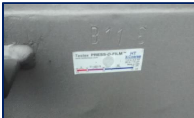
Gráfico 9: Cinta sobre la superficie granallada Fuente: Elaboración propia
