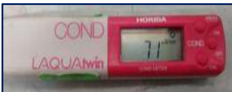
Gráfico 7: Resultado de la conductividad del abrasivo ( 71-11= 60 \mu\text{S/cm} ) Fuente: Elaboración propia
