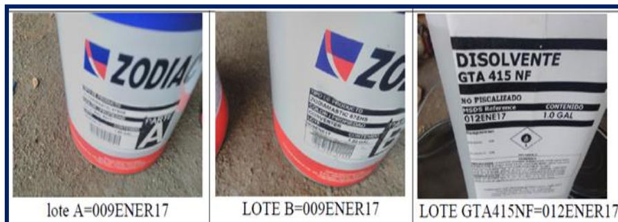
Gráfico 13: Resina, catalizador y diluyente para la aplicación de la primera capa Fuente: Elaboración propia
