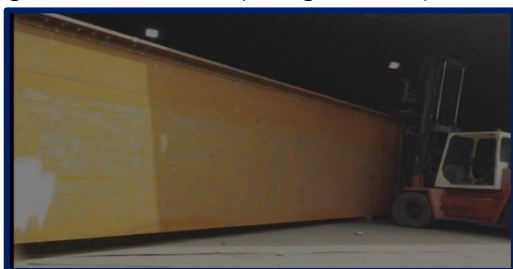
Gráfico 5: Estructuras en acero ingresando a la cabina de granallado
