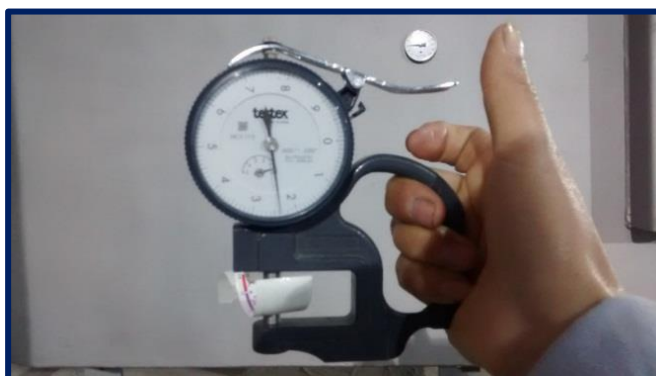
Gráfico 10: Micrómetro – Medición del Perfil de Rugosidad Fuente: Elaboración propia
