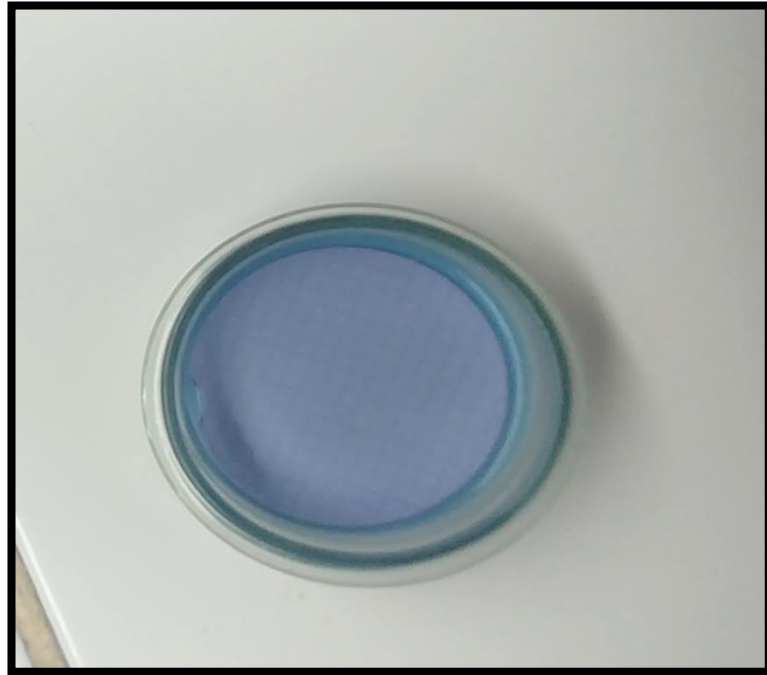
Fotografía 09. Filtro de membrana en la placa petri que contiene agar FC el cuál es específico para Escherichia coli .
