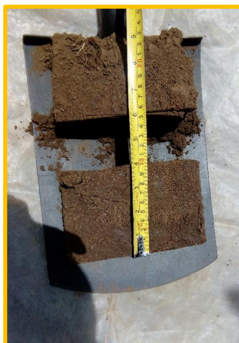
Figura 4 y 5: cuarteo de las muestras de acuerdo a la profundidad del suelo.
