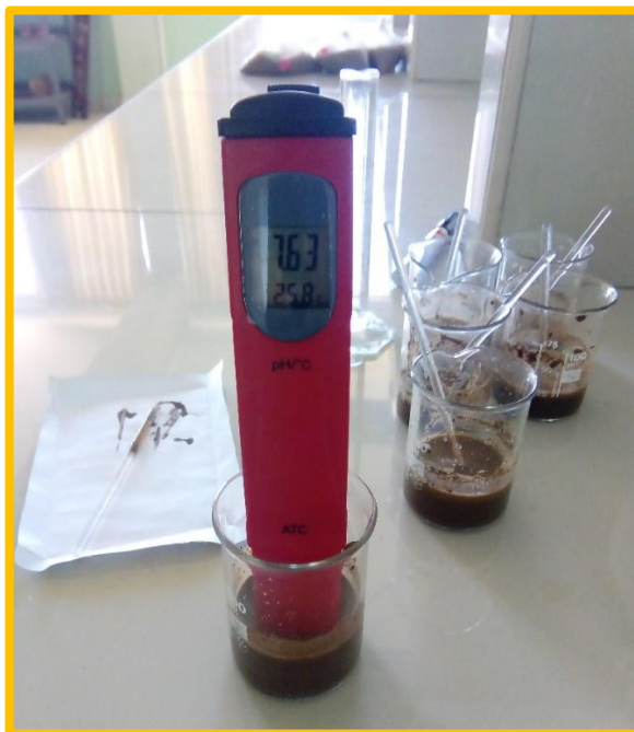
Figura 13: Determinación del pH del suelo.
