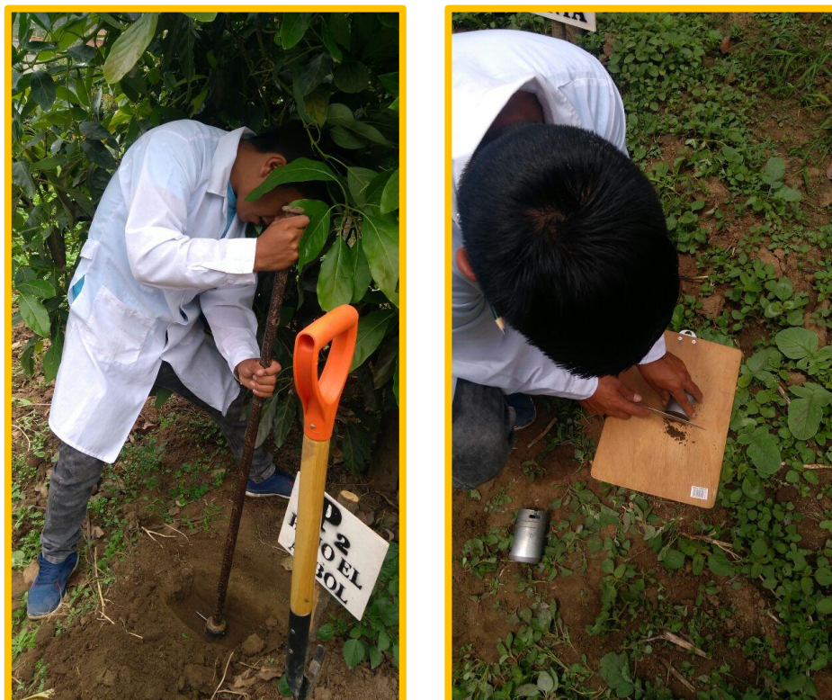
Figura 8 y 9: Extracción de las muestras para la determinación de la densidad aparente a tres profundidades del suelo.
