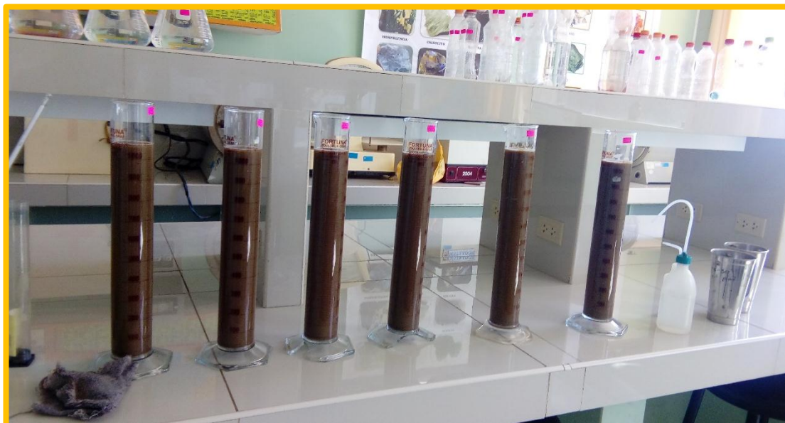
Figura 11: Determinación de la textura del suelo.
