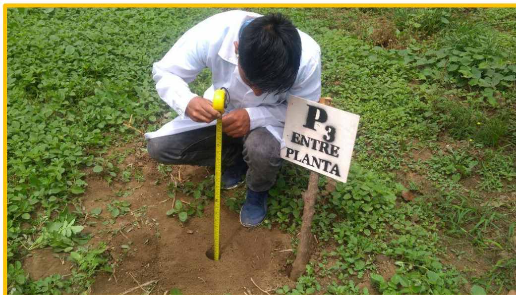
Figura 7: muestreo de suelo para la determinación de la densidad aparente por el método del cilindro a tres profundidades del suelo.
