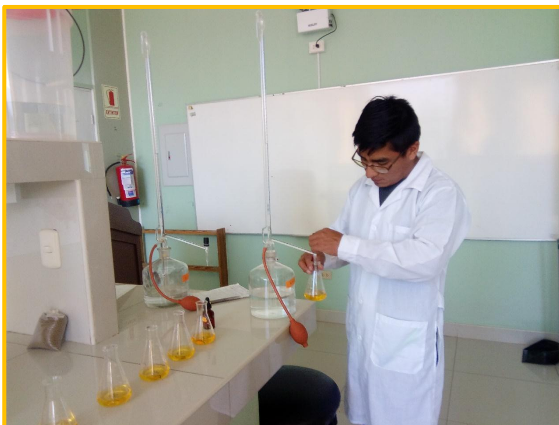
Figura 12: Determinación de carbonatos de calcio ( \text{CaCO}_3 ).
