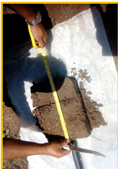
Figura 4 y 5: cuarteo de las muestras de acuerdo a la profundidad del suelo.
