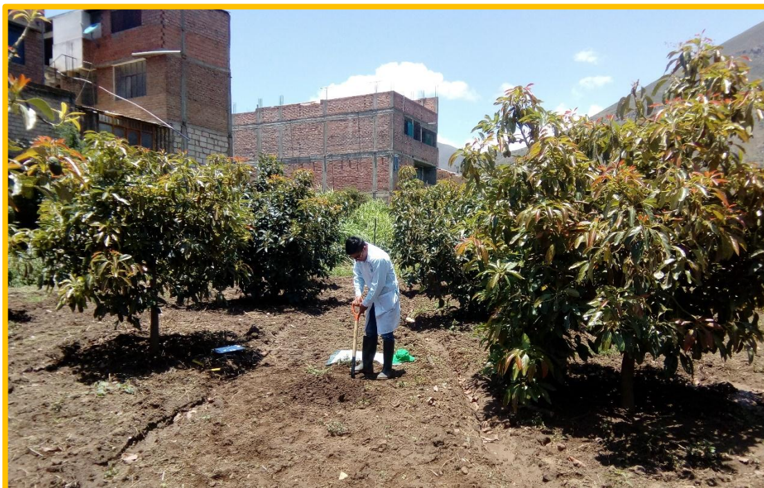
Figura 3: Extracción de muestra para la determinación de la materia orgánica a tres profundidades del suelo entre planta.
